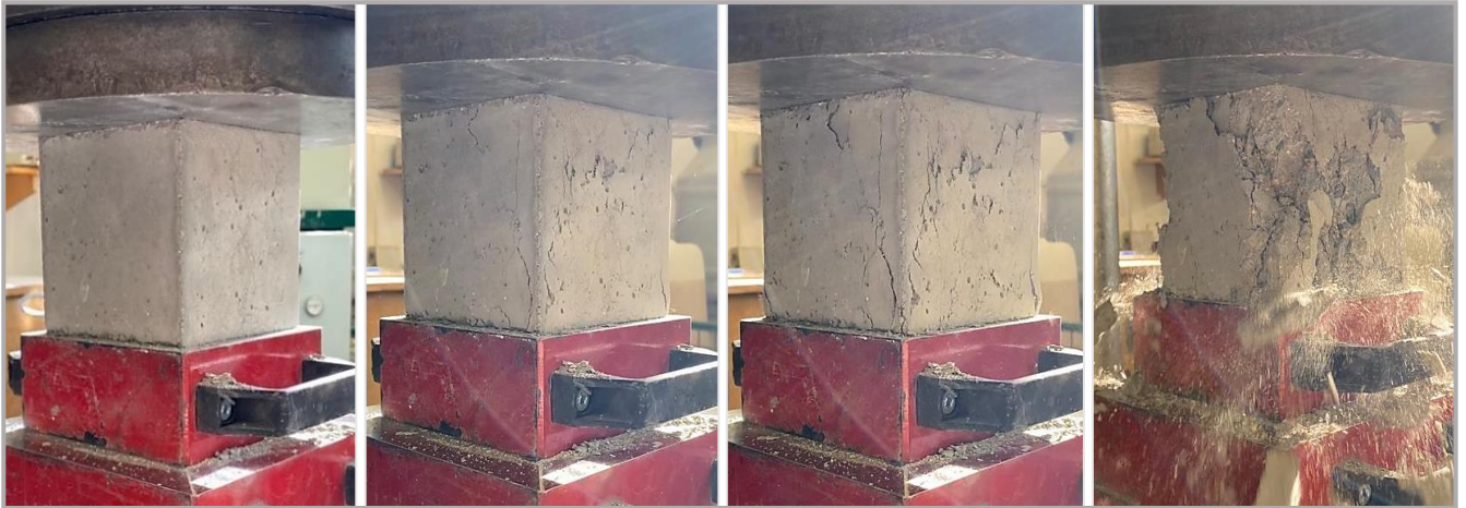
Obrázek 68: Sekvence fotek z průběhu zatěžovací zkoušky
