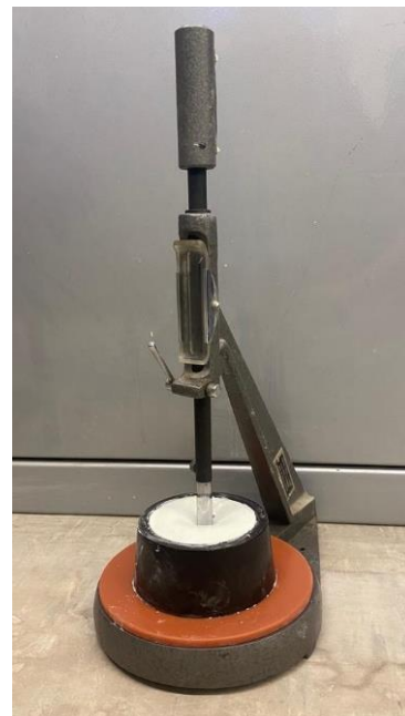
Obrázek 44: Ruční Vicatův přístroj
