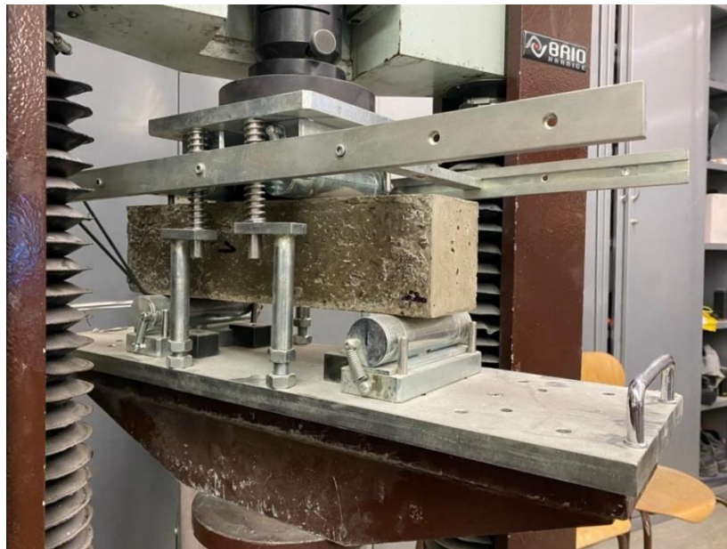
Obrázek 70: Betonový vzorek osazený ve zkušebním přístroji
