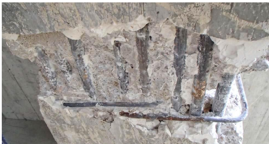
Obrázek 76 Destruktivní sonda ve středu pole 2 ze spodu trámu – diagnostika
