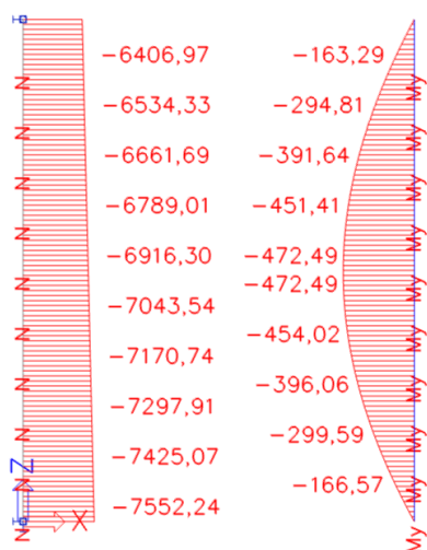
Obrázek 141 Obálka nelineárních kombinací [kN, kNm]
