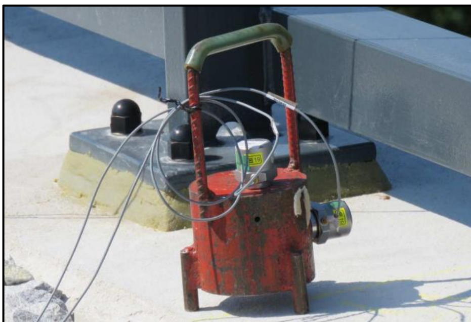
Obrázek 36: Absolutní snímače zrychlení uchycené na přenosná ocelová závaží
