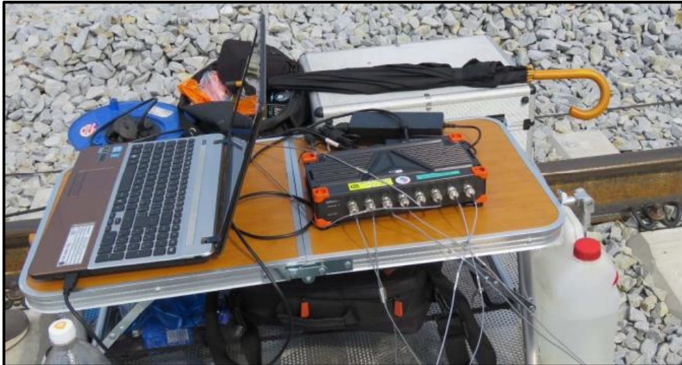
Obrázek 37: Měřicí ústředna a řídicí počítač
