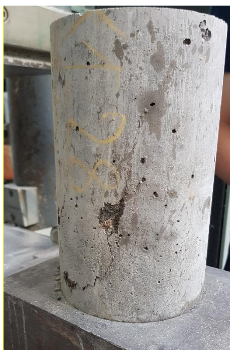
Obr. 32 – Válec-K1_1/3 po zatížení ve stáří 28 dnů
