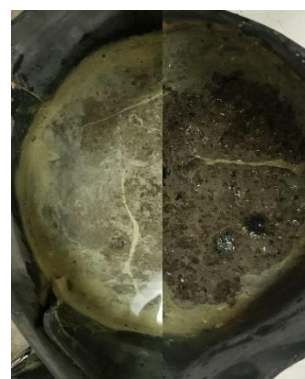
Obr. 36 – Těleso směsi K3 před a po 100 cyklech zkoušky odolnosti vůči CHRL
