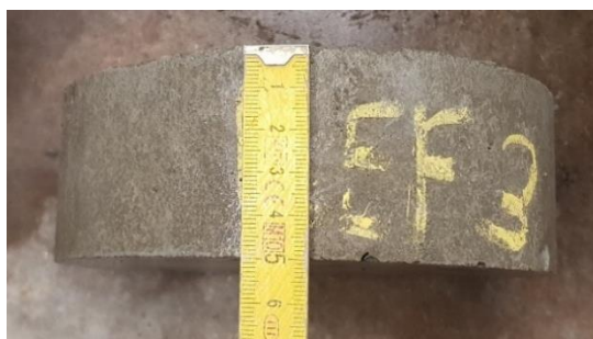
Obr. 20 – Odříznuté zkušební těleso z válce
