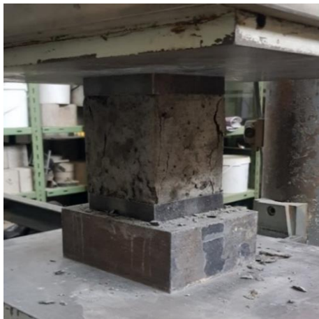
Obr. 22 – Krychle REF_1/3 po zatížení v lisu ve stáří 7 dnů
