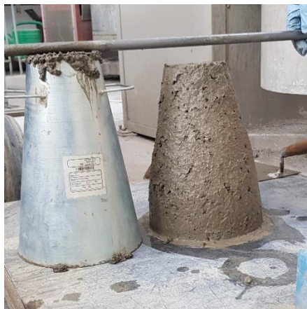
Obr. 15 – Zkouška sednutí konzistence směsi
