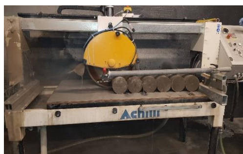
Obr. 44 – Kotoučová pila při odřezávání puků z válců
