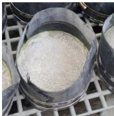
Obr. 21 – Zkušební tělesa navlečená v automobilové duši s kovovými objímkami
