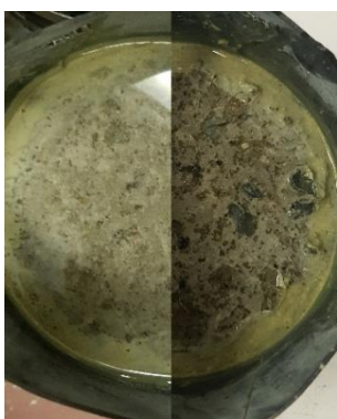
Obr. 34 – Těleso směsi K1 před a po 100 cyklech zkoušky odolnosti vůči CHRL
