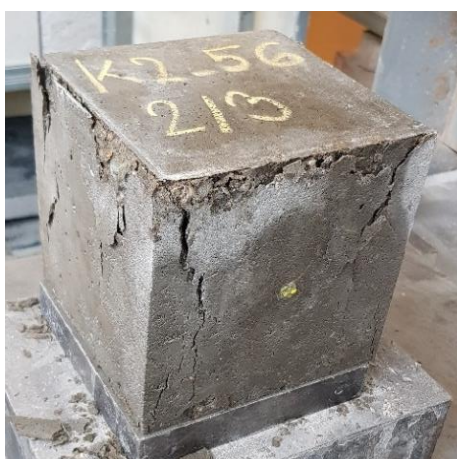
Obr. 26 – Krychle K2_2/3 po zatížení ve stáří 56 dnů
