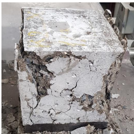
Obr. 30 – Krychle K2_1/3 po zatížení ve stáří 90 dnů
