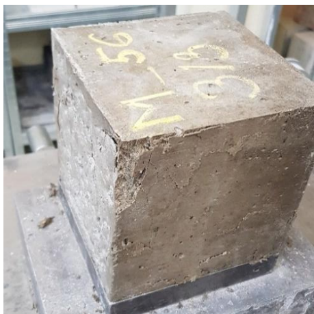
Obr. 28 – Krychle M_3/3 po zatížení ve stáří 56 dnů
