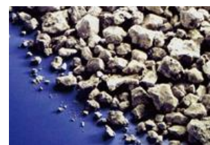
Obr. 3 – Vzduchem chlazená ocelářská struska BOF [9]
