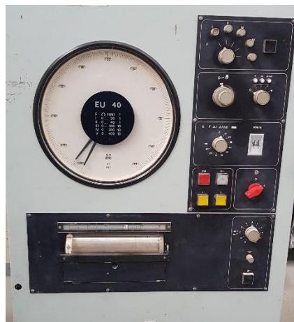
Obr. 40 – Siloměr čtyřbodového lisu EU 40
