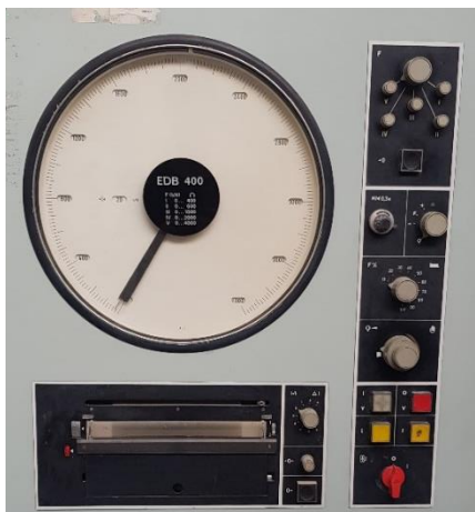
Obr. 39 – Siloměr tlakového lisu EDB 400
