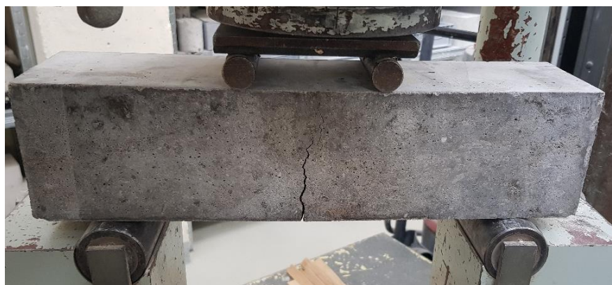
Obr. 33 – Zkušební trámek ve čtyřbodovém lisu
