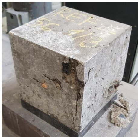
Obr. 24 – Krychle REF_1/3 po zatížení ve stáří 56 dnů
