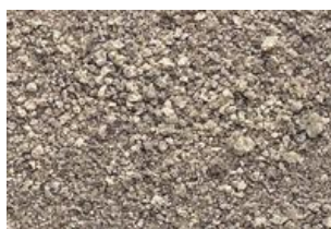
Obr. 2 – Granulovaná vysokopecní struska [9]
