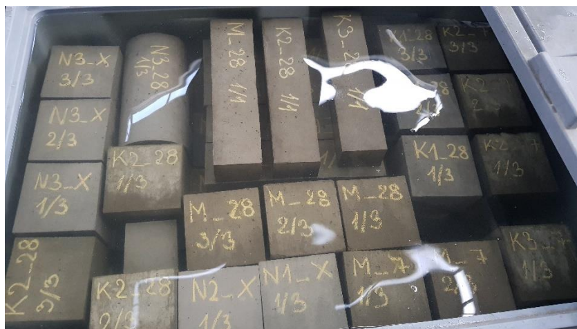
Obr. 37 – Zkušební tělesa po odbednění ponořená v kádi s vodou
