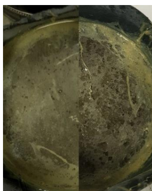
Obr. 35 – Těleso směsi K2 před a po 100 cyklech zkoušky odolnosti vůči CHRL
