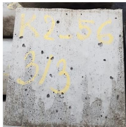
Obr. 17 – Krychlové těleso a jeho kódové označení (směs K2; 56 dní; 3 ze 3)
