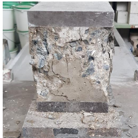
Obr. 23 – Krychle K1_2/3 po zatížení ve stáří 28 dnů
