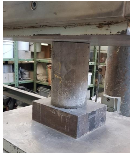
Obr. 19 – Zkušební válec umístění v lisu před zatížením
