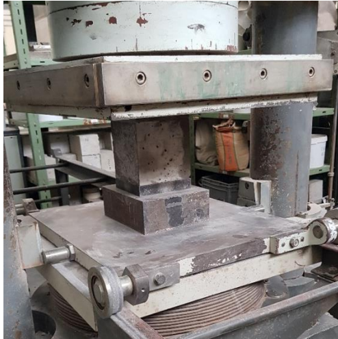
Obr. 18 – Zkušební krychle umístěna v lisu před zatížením
