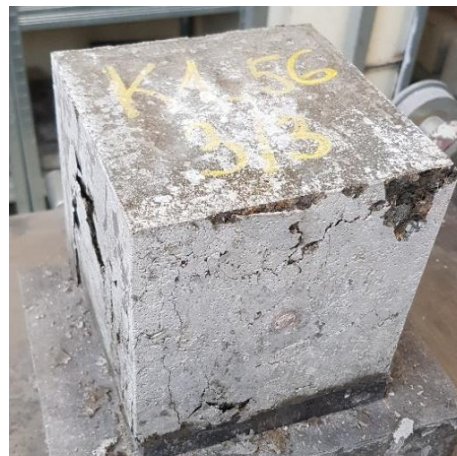
Obr. 25 – Krychle K1_3/3 po zatížení ve stáří 56 dnů
