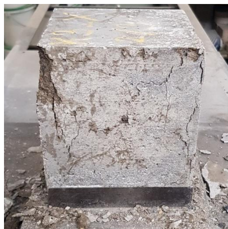
Obr. 31 – Krychle K3_2/3 po zatížení ve stáří 90 dnů
