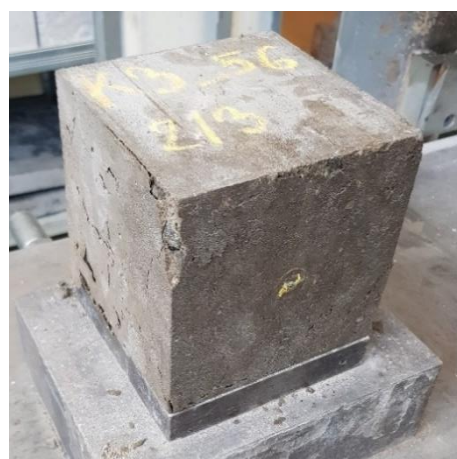
Obr. 27 – Krychle K3_2/3 po zatížení ve stáří 56 dnů
