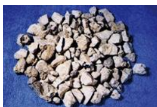
Obr. 1 – Vzduchem chlazená vysokopecní struska [9]
