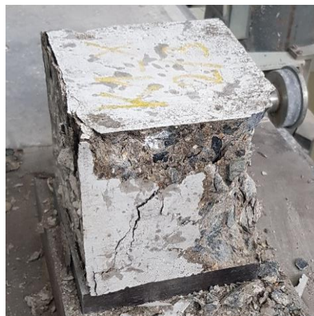
Obr. 29 – Krychle K1_2/3 po zatížení ve stáří 90 dnů
