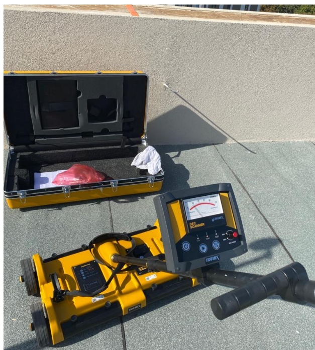
Obr. č. [32] Kalibrace impedančního defektoskopu – stav stupnice po nastavení citlivosti na ovládacím panelu (vlastní fotodokumentace)
