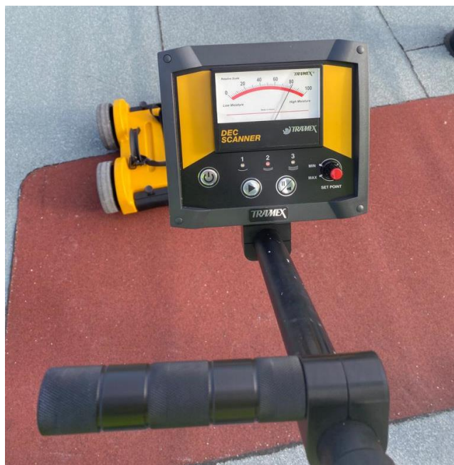
Obr. č. [46] Optické znázornění výskytu větší míry vlhkosti na stupnici defektoskopu „1“ (vlastní fotodokumentace)
