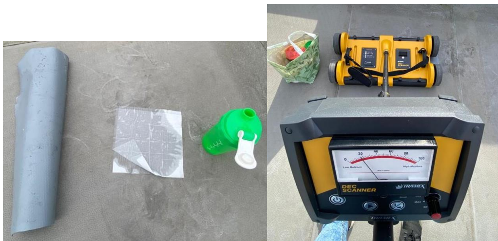
Obr. č. [20] Kalibrace impedančního defektoskopu – pokládání mokrého ubrousku pod vzorek hydroizolace (vlastní fotodokumentace)
