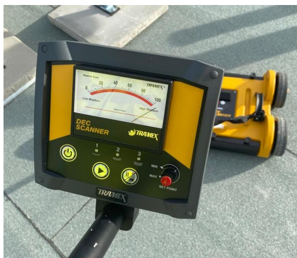
Obr. č. [47] Optické znázornění výskytu větší míry vlhkosti na stupnici defektoskopu „2“ (vlastní fotodokumentace)
