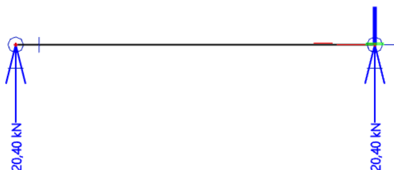
Obrázek 101 – Reakce stropnice A
