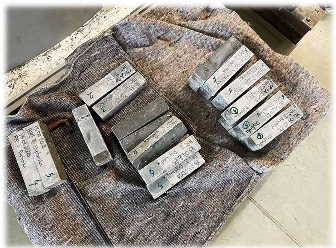
Obrázek 61 – Trámečky 40x40x160 mm po 28 dnech
