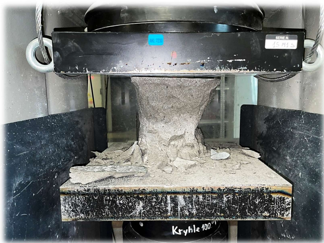
Obrázek 65 – Porušení krychle 150x150x150 mm
