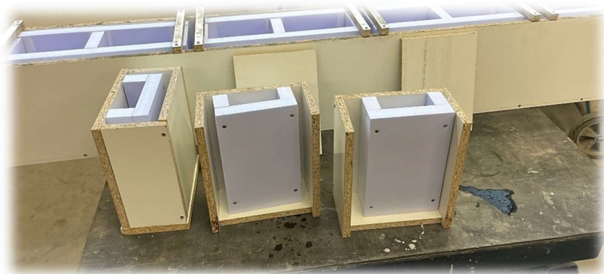
Obrázek 132 – Kompletace forem pro koncové dílce
