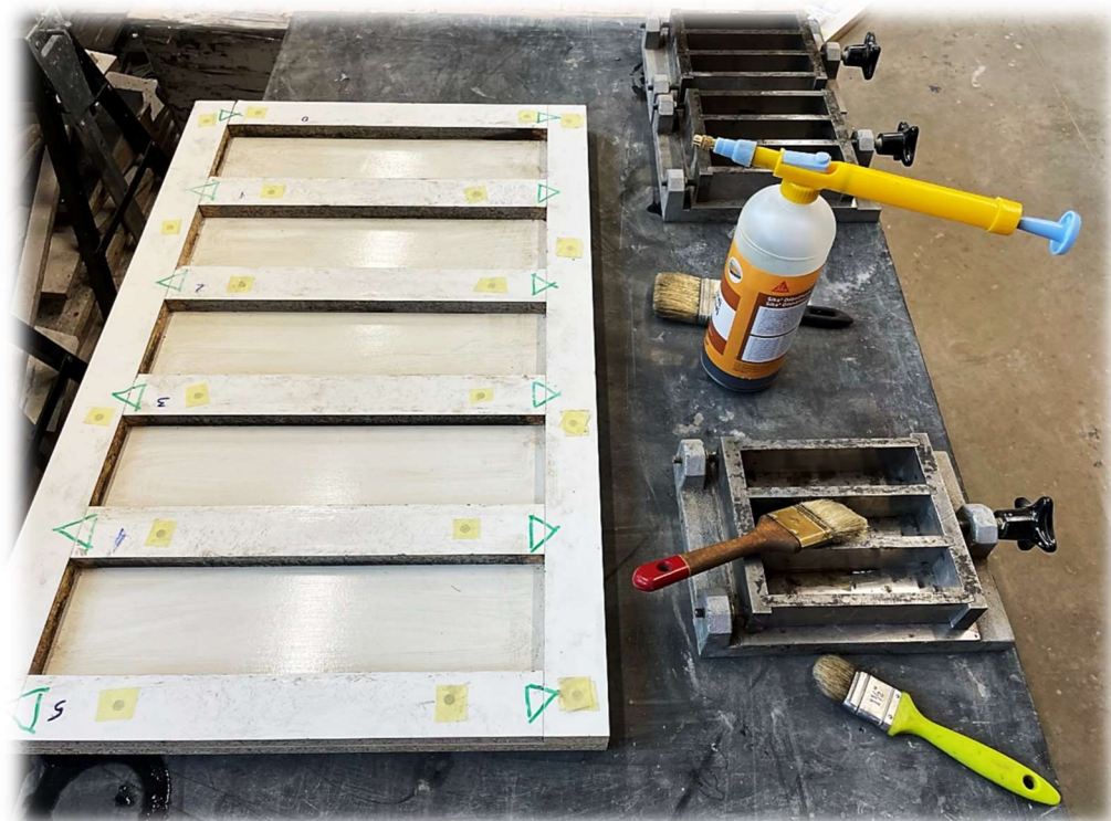
Obrázek 85 – Příprava forem pro betonáž destiček
