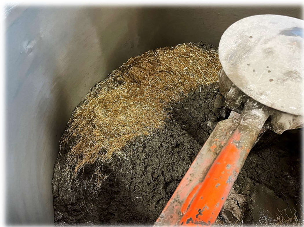
Obrázek 56 – Ocelová mikrovlná přidané na samém závěru míchání
