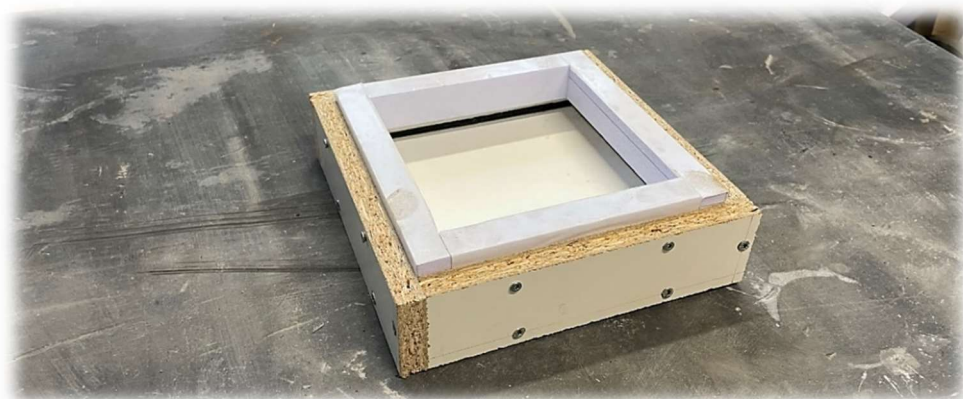
Obrázek 136 – Hotová forma pro stříšku
