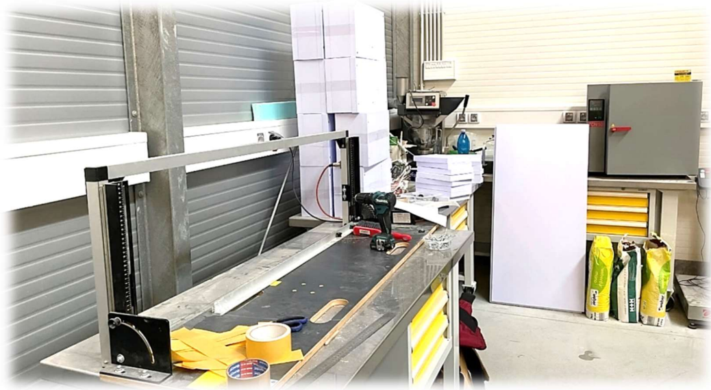
Obrázek 127 – Řezačka polystyrénu s odporovým drátem
