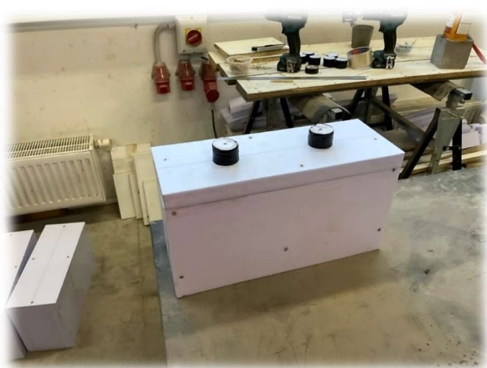
Obrázek 133 – Vnitřní box z XPS pro formu dílce s květináči
