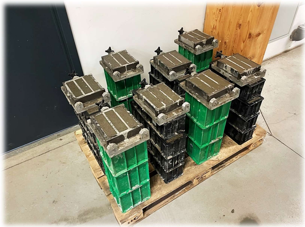
Obrázek 58 – Vybetonované formy zkušebních těles
