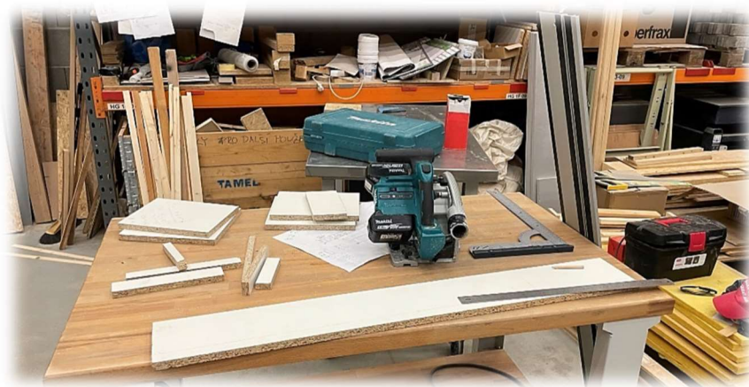
Obrázek 131 – Řezání lamina pro vnější formu koncových dílců
