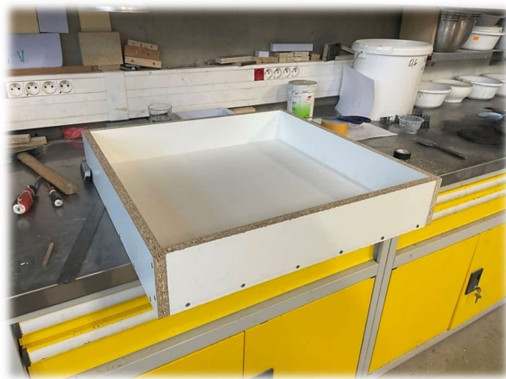
Obrázek 137 – Vnější forma pro patku (bez vyvrtaných otvorů pro výztuž)
