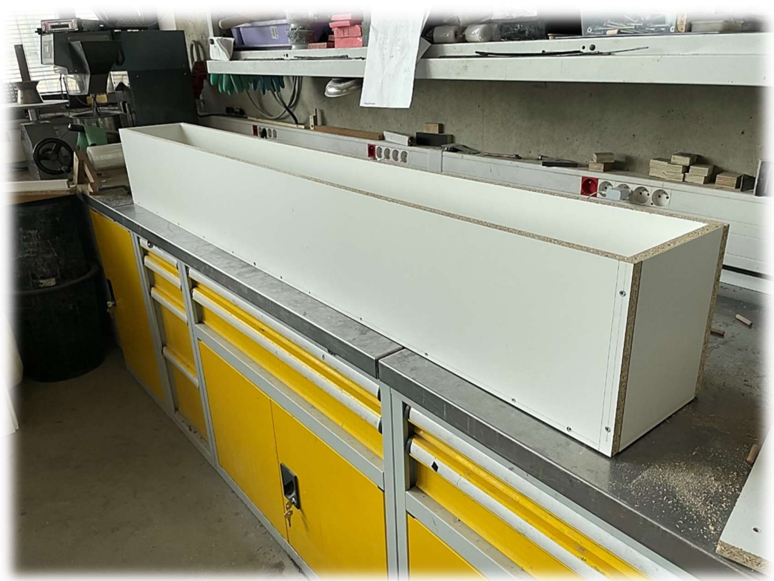
Obrázek 123 – Hotová vnější forma základního dílce
