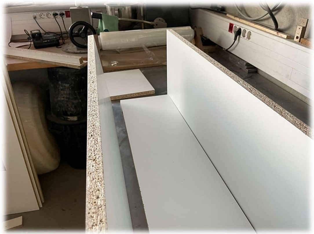
Obrázek 122 – Kompletace vnější formy základního dílce
