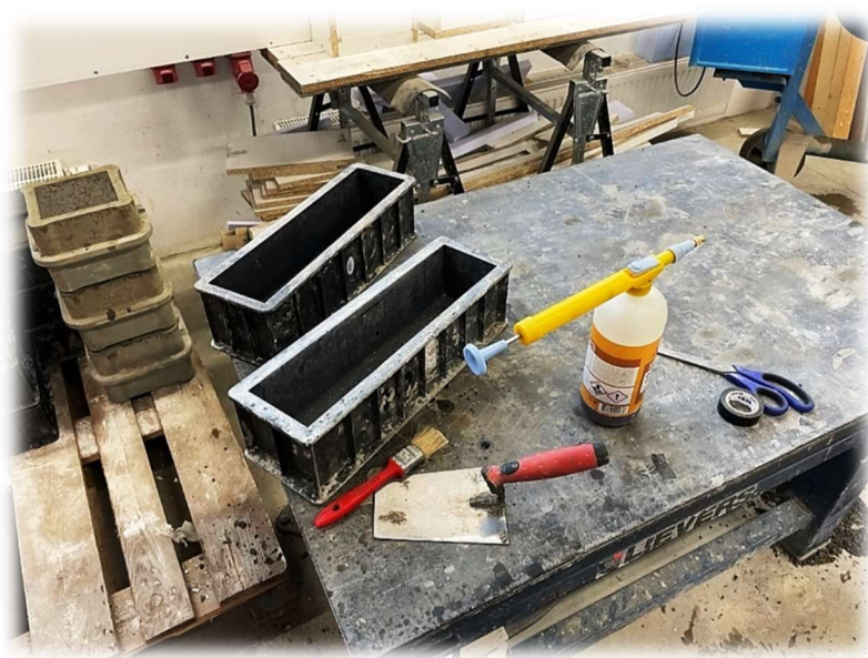
Obrázek 53 – Aplikace odbedňovacího oleje do forem
