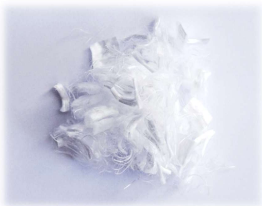
Obrázek 18 – Polypropylenová vlákna, délka 12 mm, průměr fibrily 32 \mu\text{m} [18]
