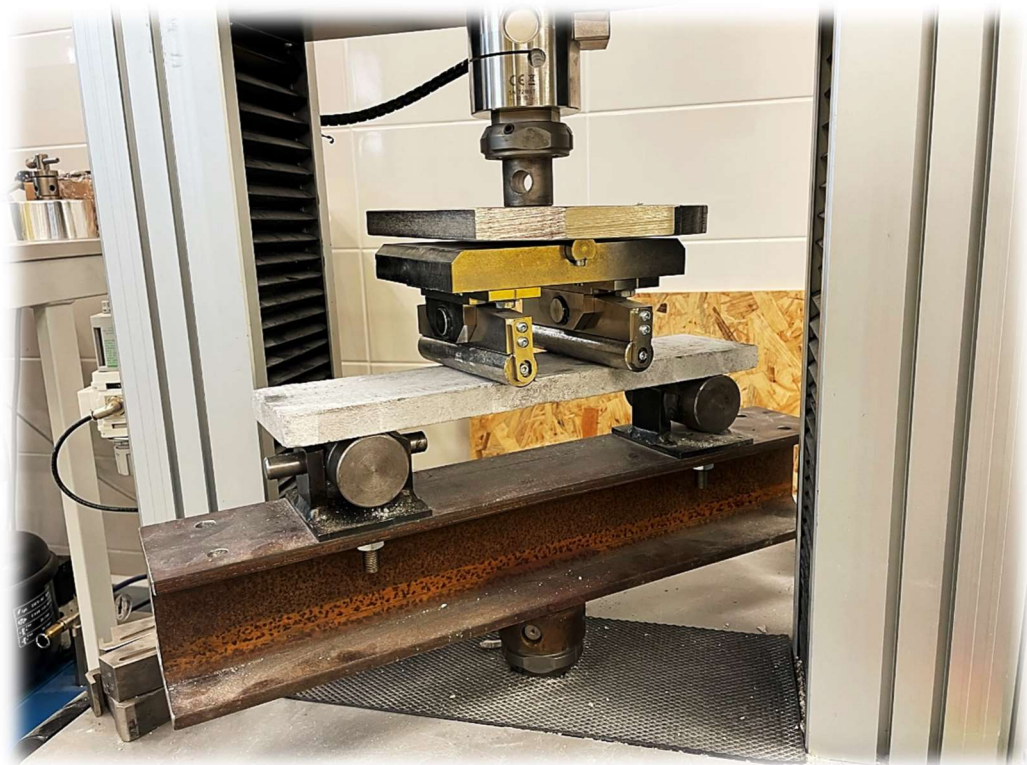
Obrázek 89 – Destička umístěná v lisu s využitím přípravku
