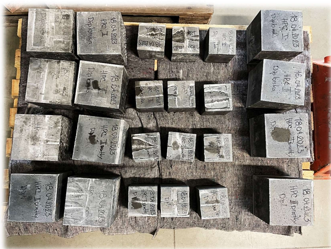
Obrázek 59 – Krychle 100x100x100 mm a krychle 150x150x150 mm po 28 dnech
