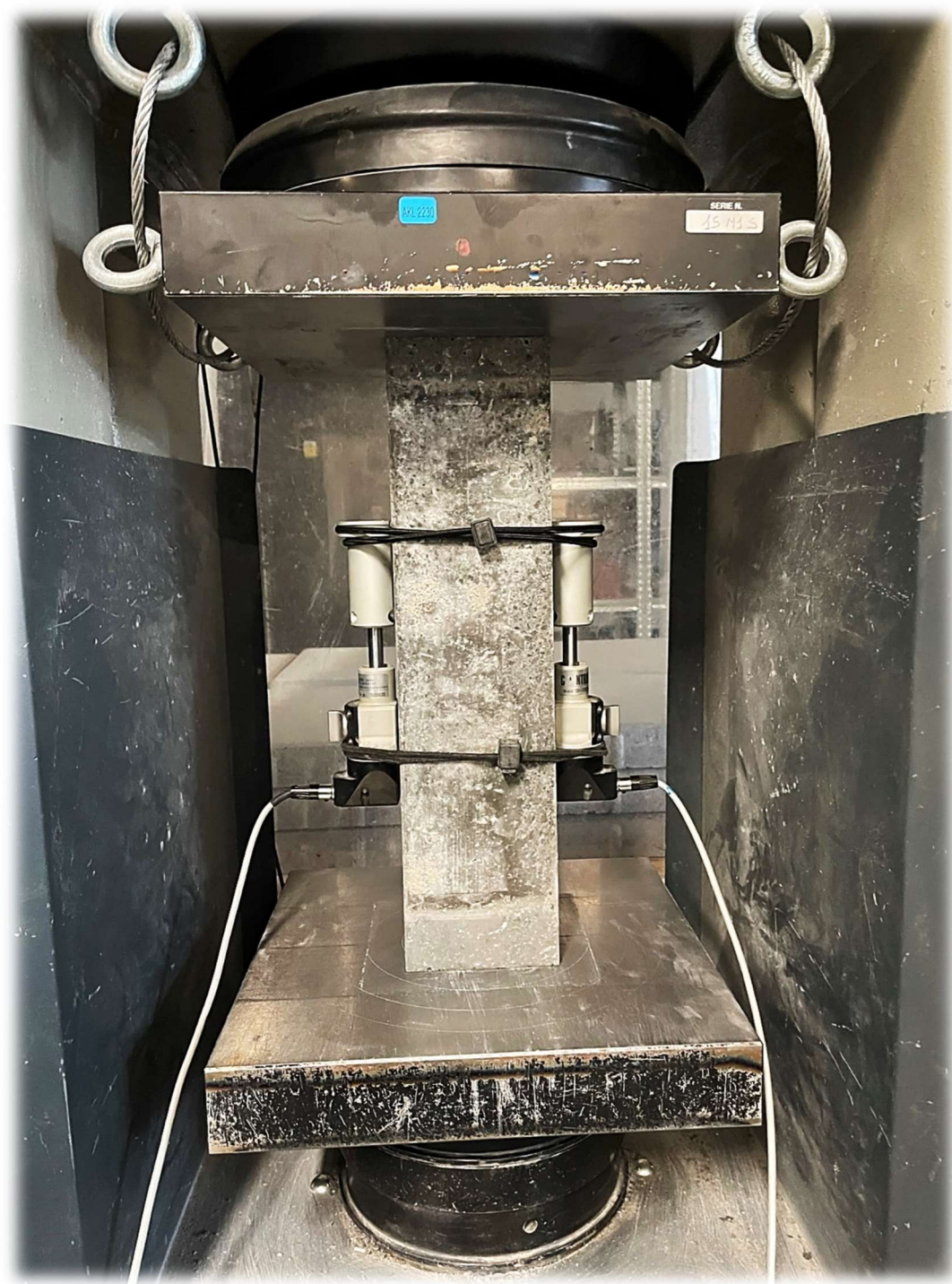
Obrázek 76 – Zkoušený trámec 100x100x400 mm s tenzometry umístěný v lisu
