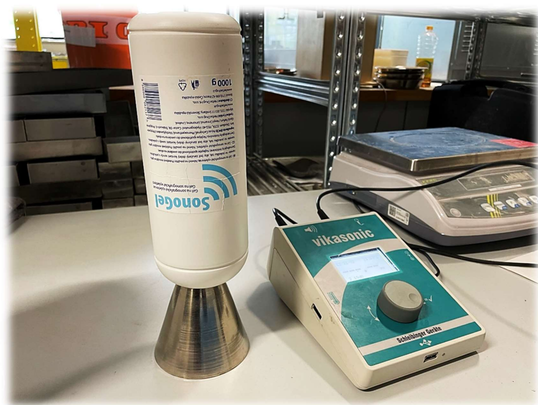
Obrázek 79 – Měřič ultrazvukových vln Vikasonic a ultrazvukový gel
