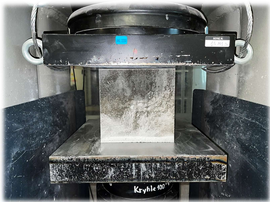
Obrázek 64 – Umístění krychle 150x150x150 mm do lisu
