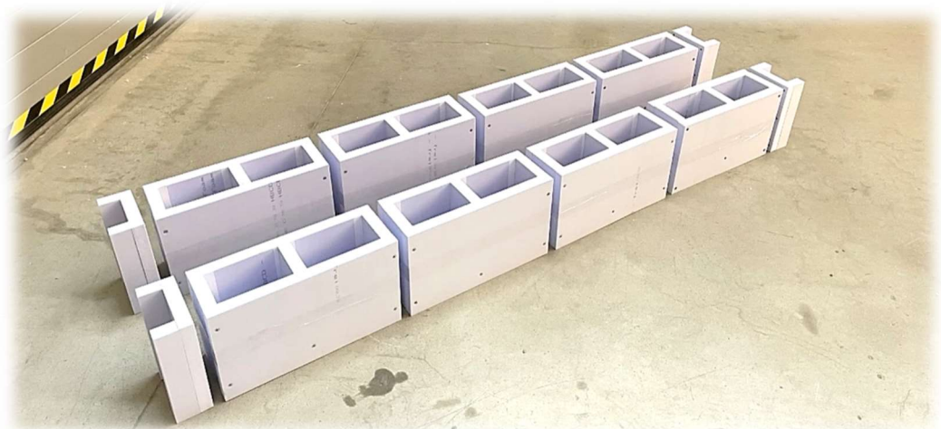
Obrázek 128 – Sestavení vnitřních boxů z XPS pro formu základního dílce
