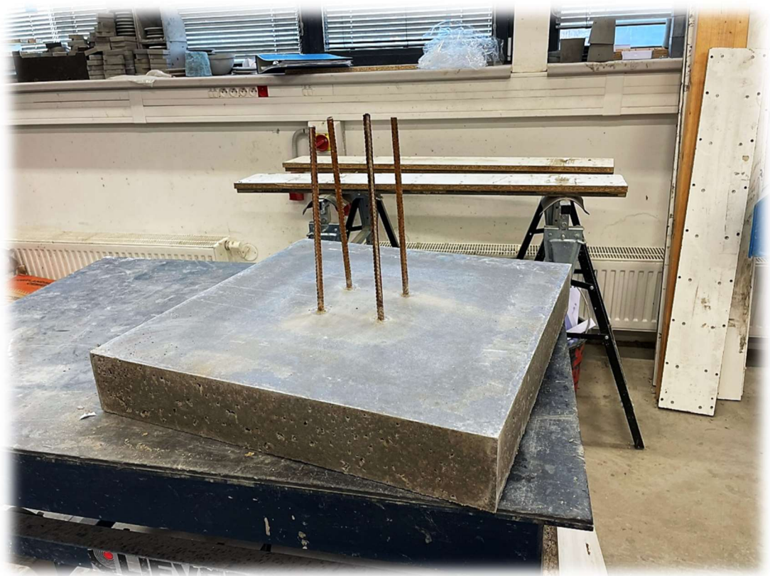
Obrázek 160 – Patka prototypu po odbednění
