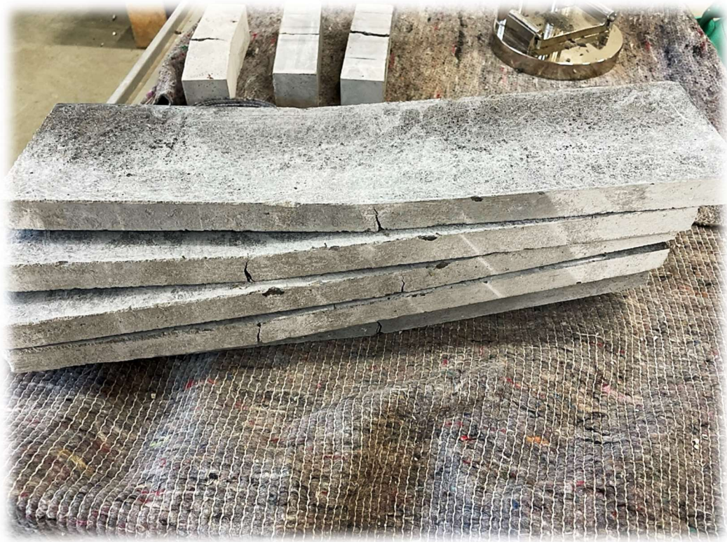
Obrázek 91 – Porušená sada zkoušených destiček
