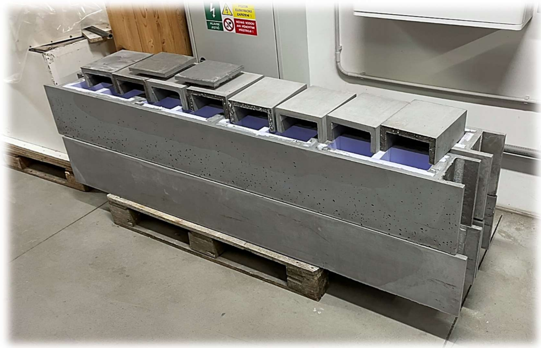
Obrázek 148 – Odbedněné dílce prototypu
