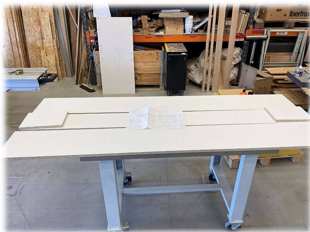
Obrázek 121 – Nařezané dílce lamina pro sestavení formy základního dílce
