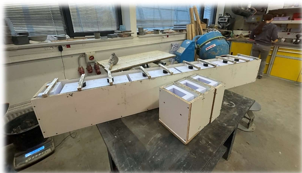
Obrázek 134 – Finální podoba formy pro dílec s květináči a pro koncové dílce
