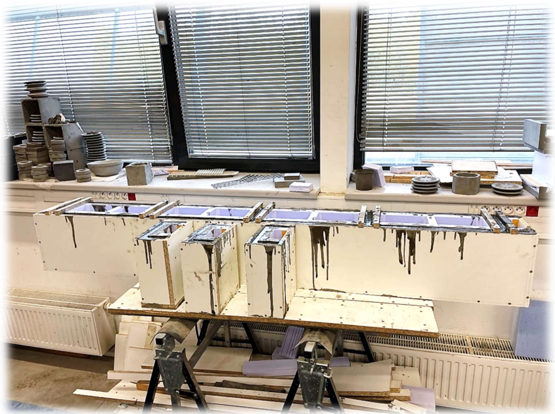
Obrázek 142 – Třetí betonáž základního a koncových dílců prototypu
