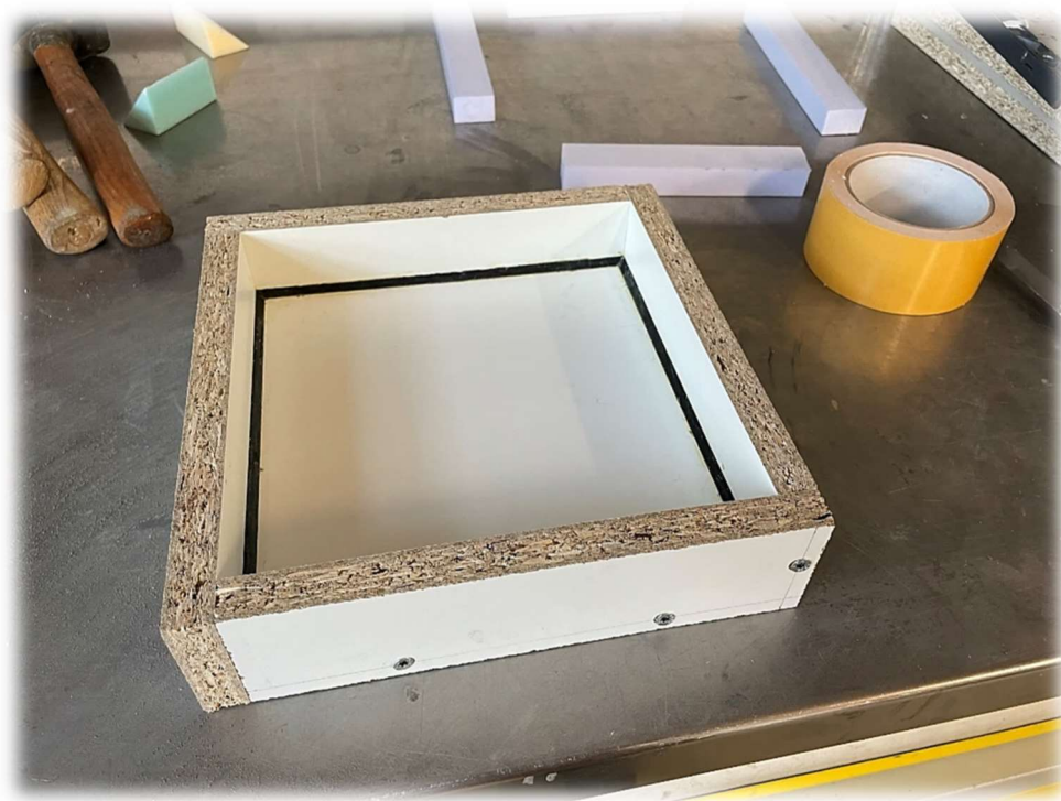
Obrázek 135 – Proces výroby formy pro stříšku
