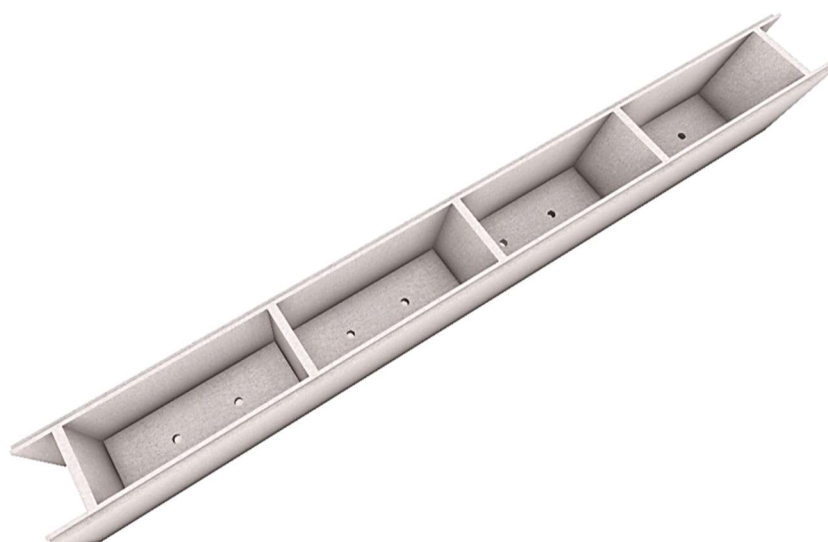
Obrázek 109 – Dílec s květináči (na dně lze pozorovat odtokové otvory)
