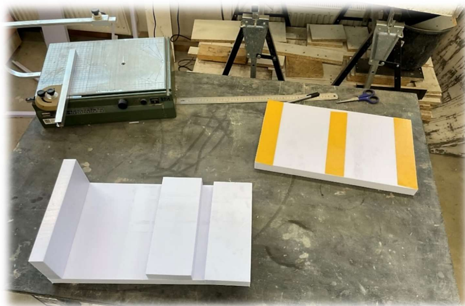
Obrázek 124 – Spojování nařezaných desek XPS
