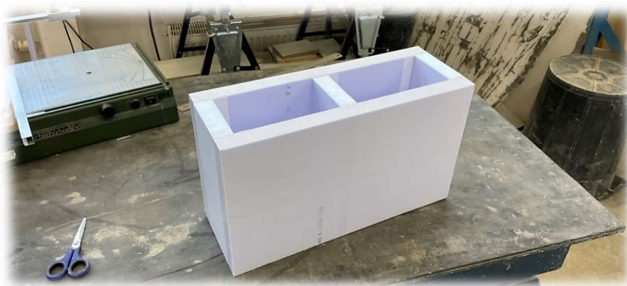
Obrázek 125 – Hotový vnitřní box pro formu základního dílce
