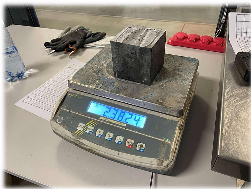
Obrázek 63 – Vážení krychle 100x100x100 mm přesnou váhou
