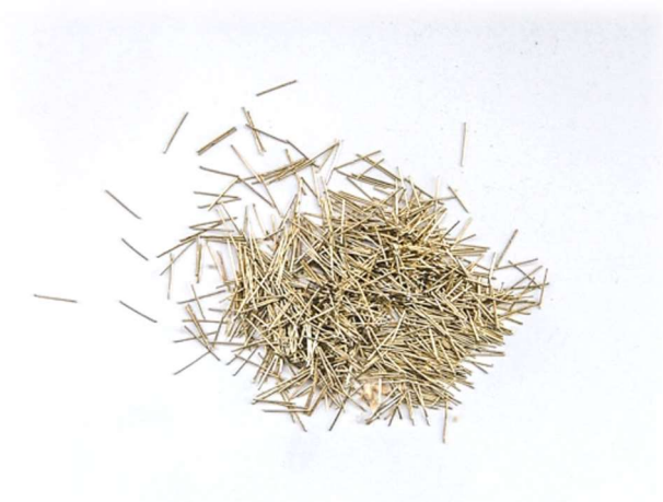
Obrázek 20 – Ocelová mikrovlákna, délka 13 mm, průměr fibrily 0,19 mm [18]
