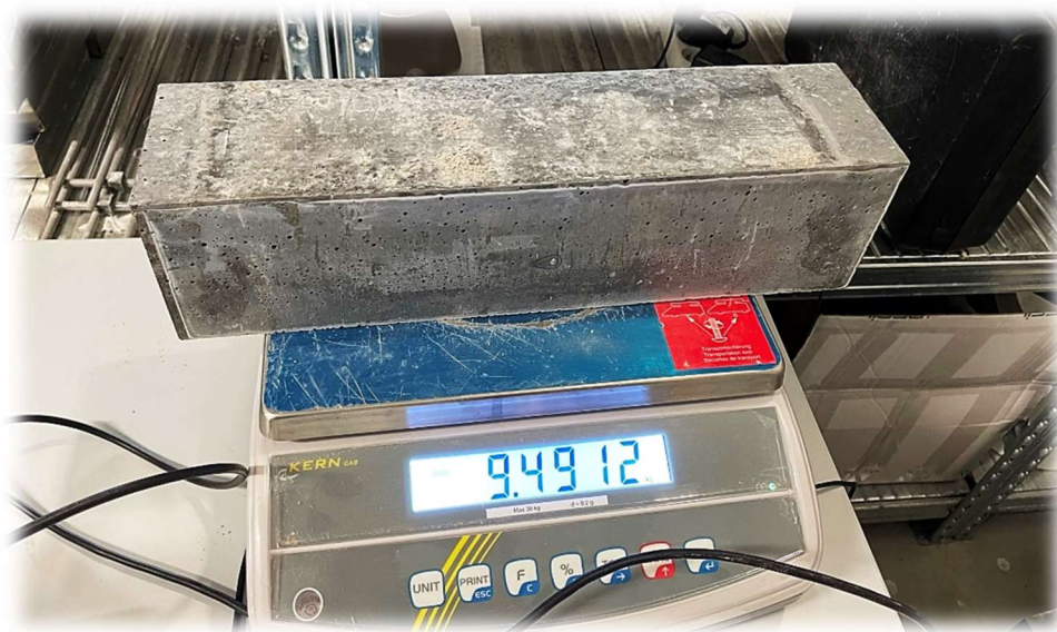
Obrázek 74 – Vážení zkoušeného trámce 100x100x400 mm
