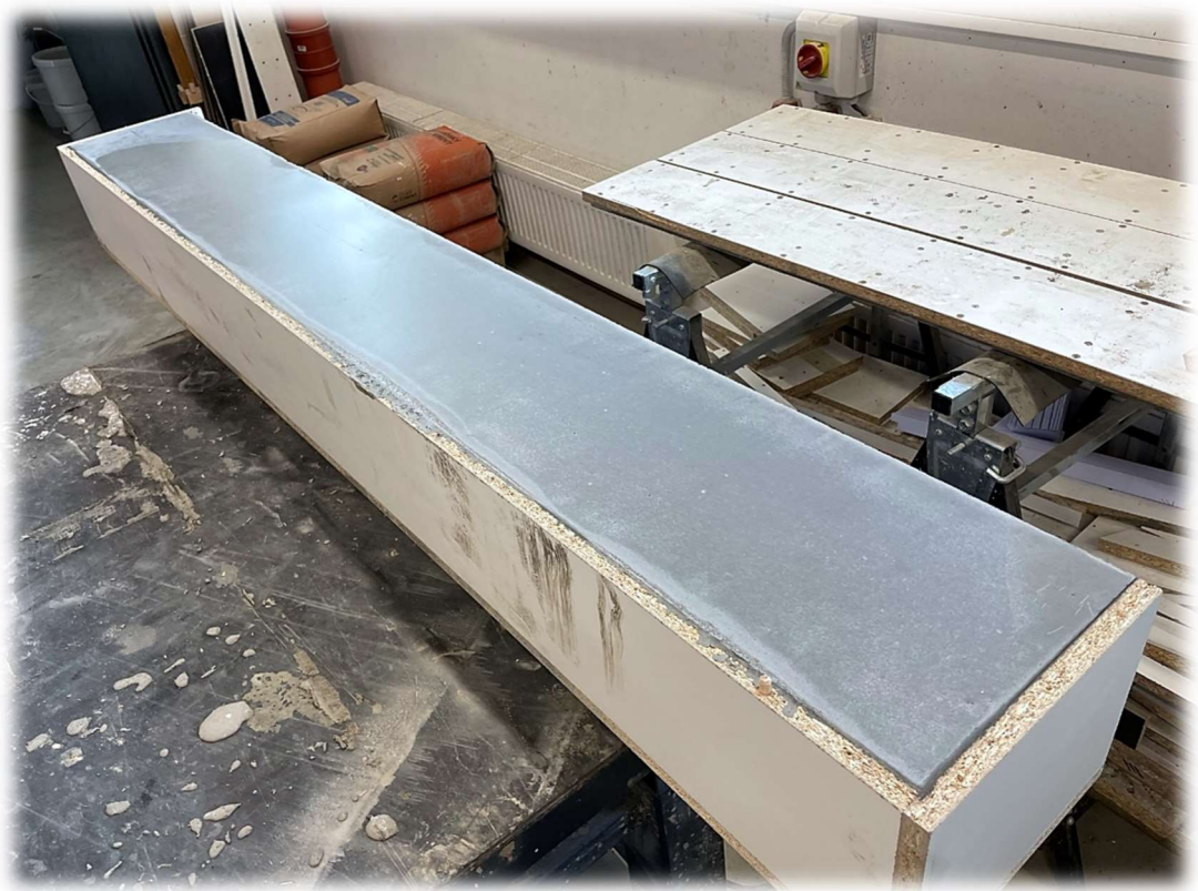
Obrázek 143 – Povrch základního dílce prototypu po odbednění boku
