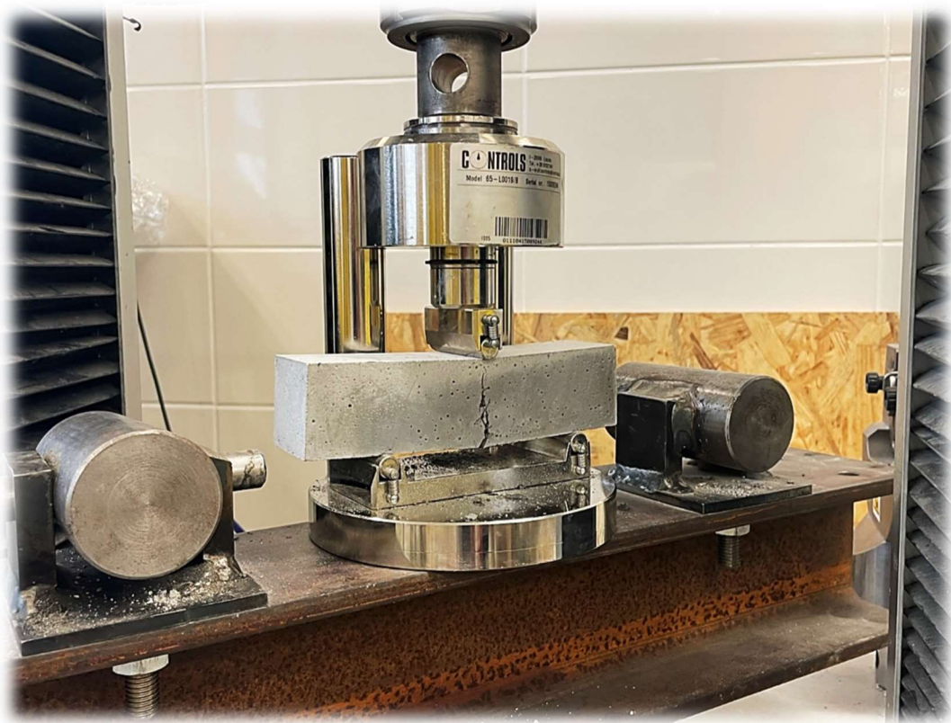
Obrázek 68 – Zkoušený trámeček 40x40x160 mm při porušení (po zatěžování)
