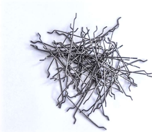
Obrázek 19 – Ocelová vlákna s profilací, délka 60 mm, průměr fibrily 0,8 mm [18]
