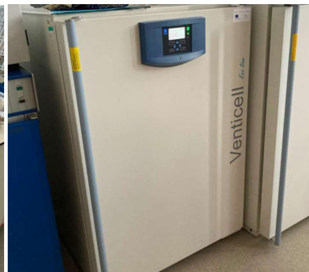
obr. /10/ Sušárna použitá při sušení vzorků
