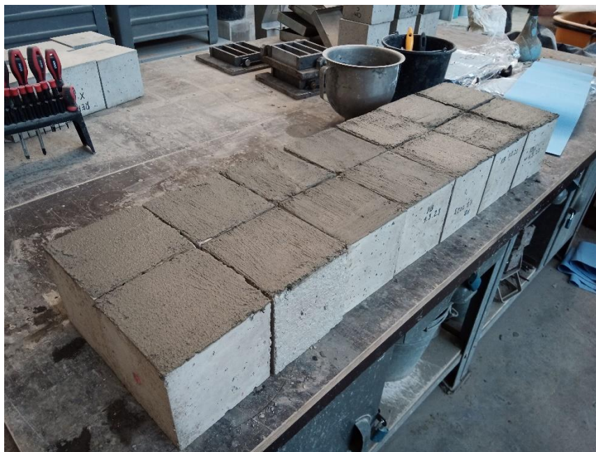
Obrázek 11: Zkušební krychle s aplikovaným zkušebním nátěrem
