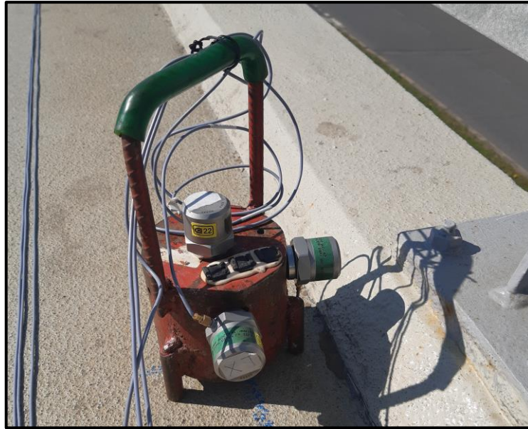
Obr. 21: Tři akcelerometry od firmy Brüel & Kjær typu 8344 připevněné k přenosnému ocelovému závaží.
