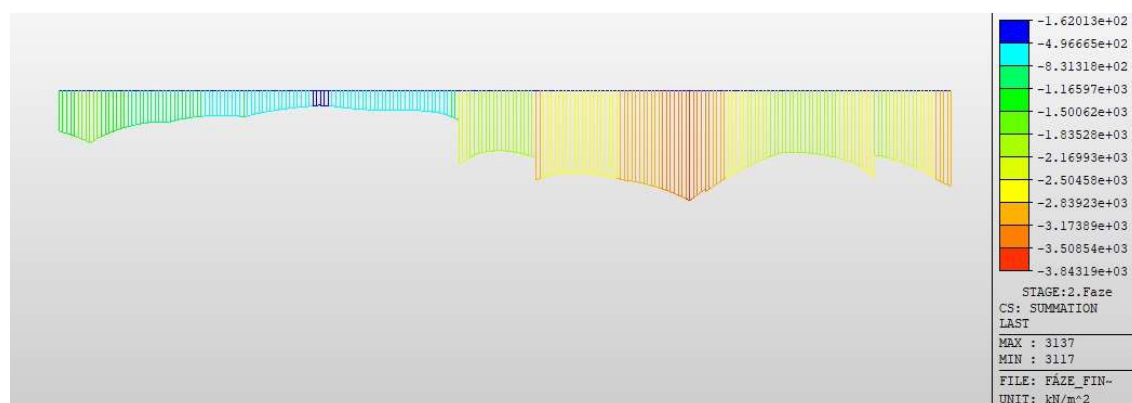
Obrázek 80: Normálové napětí na levém trámu, 2. fáze, dolní vlákna
