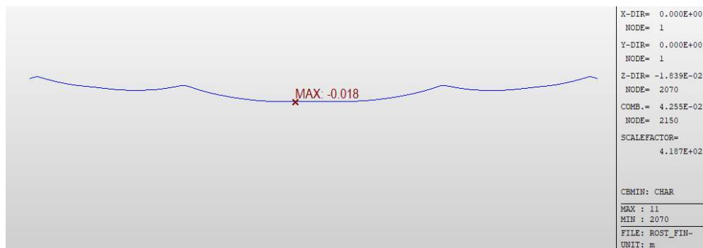
Obrázek 147: Průhyb středního trámu na konci životnosti
