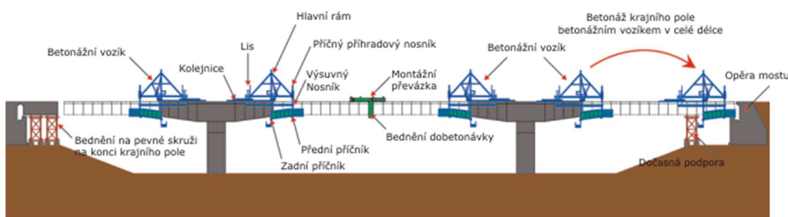
Obrázek 10: Schéma letmé betonáže [21]
