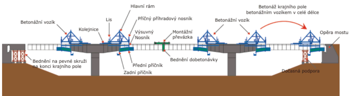
Obrázek 9: Technologie výstavby letmou betonáží [7]
