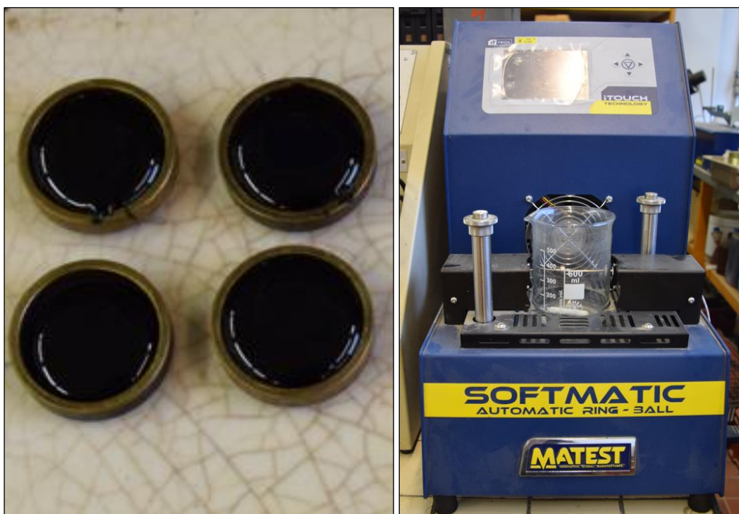
Obrázek 11: Odlité vzorky v kroužku (vlevo), přístroj na měření bodu měknutí (vpravo)
