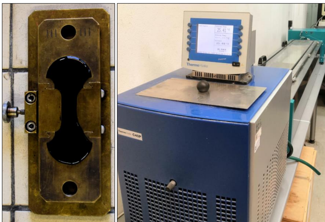
Obrázek 12: Odlitý vzorek ve formě (vlevo), duktilometr (vpravo)
