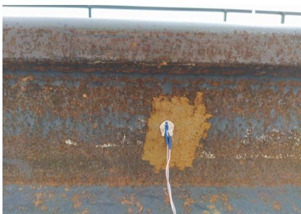
Obr. 26 Připojení snímače teploty na kolejnici
