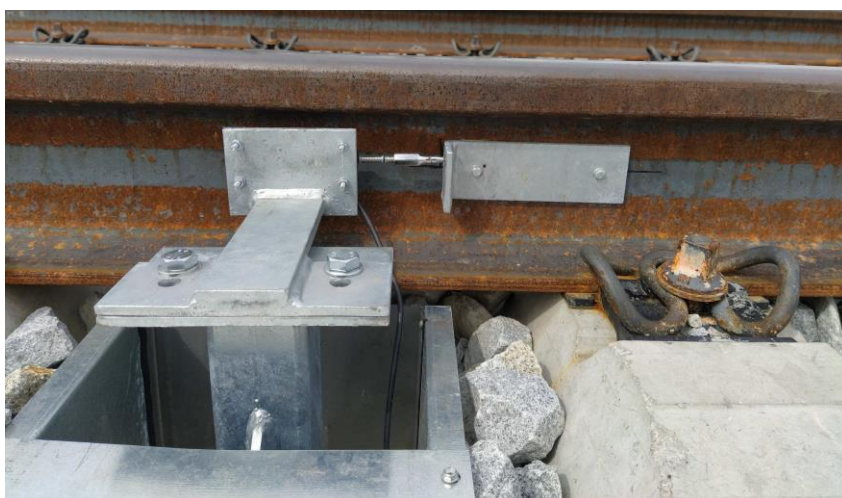
Obr. 24 Připojení potenciometrického snímače dráhy (most:kolejnici) ke kolejnici
