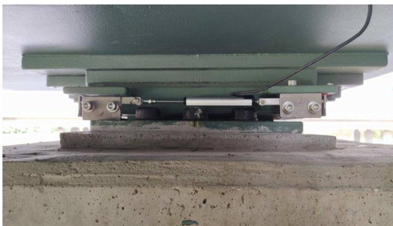
Obr. 23 Připojení potenciometrického snímače dráhy (SS:NK)(SS = spodní stavba)
