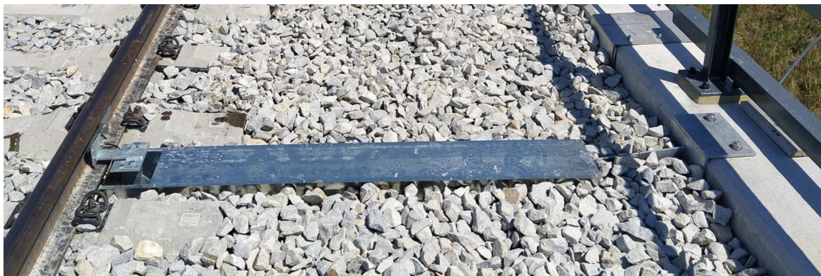
Obr. 25 Připojení potenciometrického snímače dráhy (most:kolejnice)
