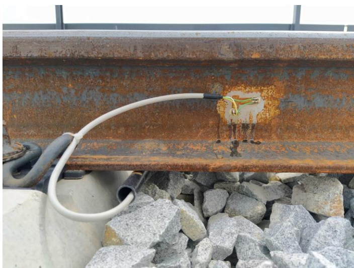
Obr. 21 Připojení tenzometru kolej-polomost
