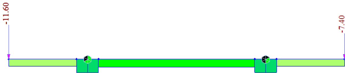
Obr. 89 - zatížení od betonových říms v modelu
