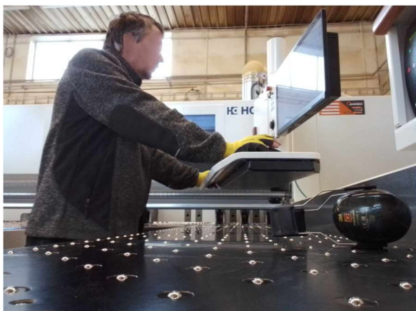
a) Řezání podkladních čtverců na CNC stroji
