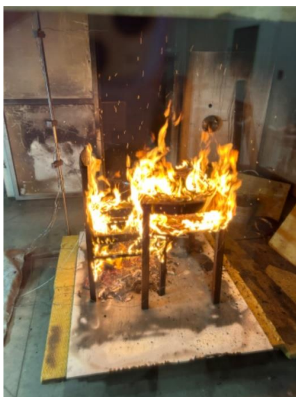
c) Zbytek sestavy nábytku před ukončením zkoušky
