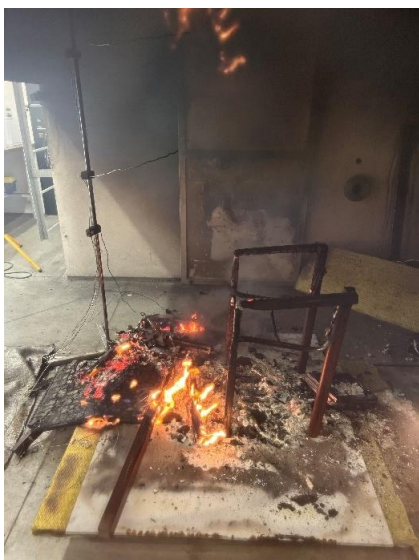
c) Sestava nábytku před ukončením zkoušky
