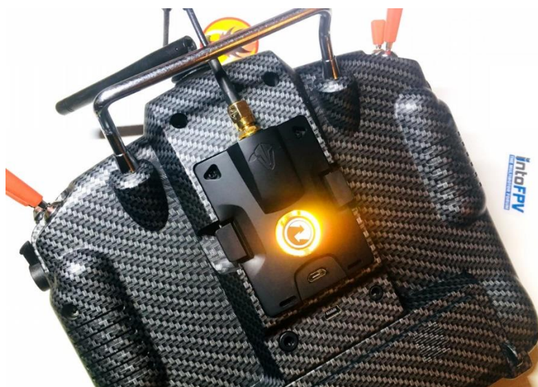
Obrázek 50 - RC vysílačka s externím Crossfire modulem v JR šachtě
