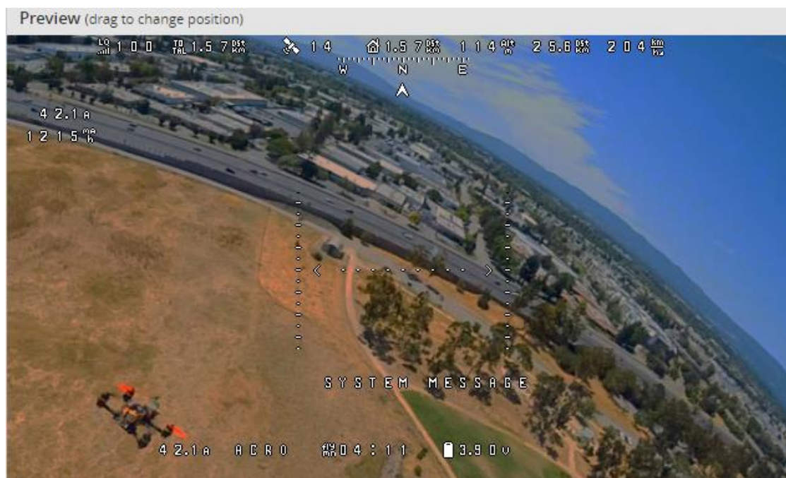
Obrázek 86 - Rozvržení OSD elementů
