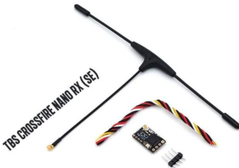
Obrázek 49 - Přijímač TBS Crossfire Nano RX s Immortal-T anténou
