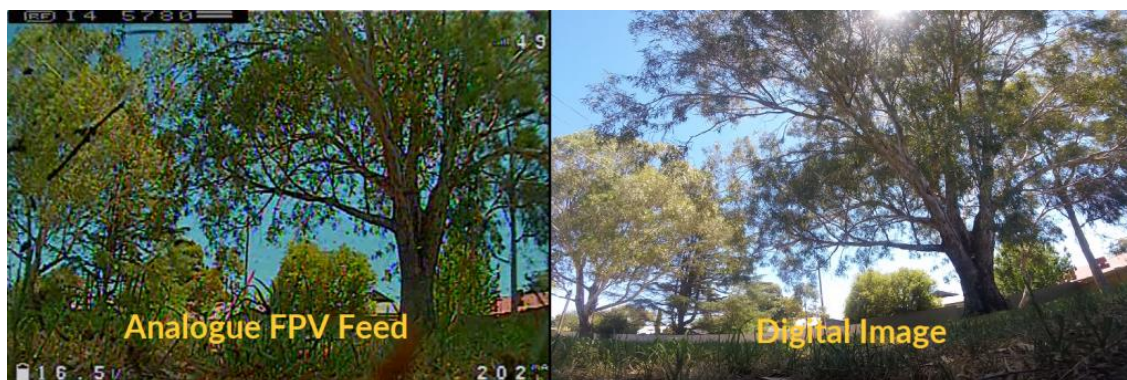
Obrázek 44 - Ukázka analogového a digitálního video přenosu
