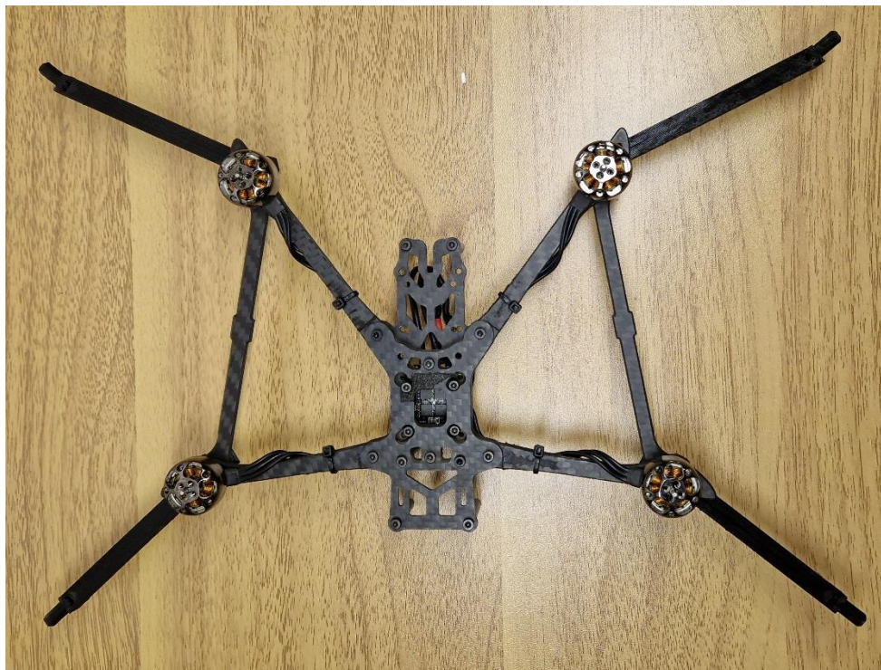
Obrázek 62 - Uchycení motoru k rameni
