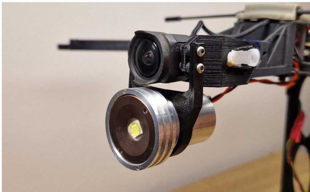
Obrázek 70 - 18W osvětlení s chladičem
