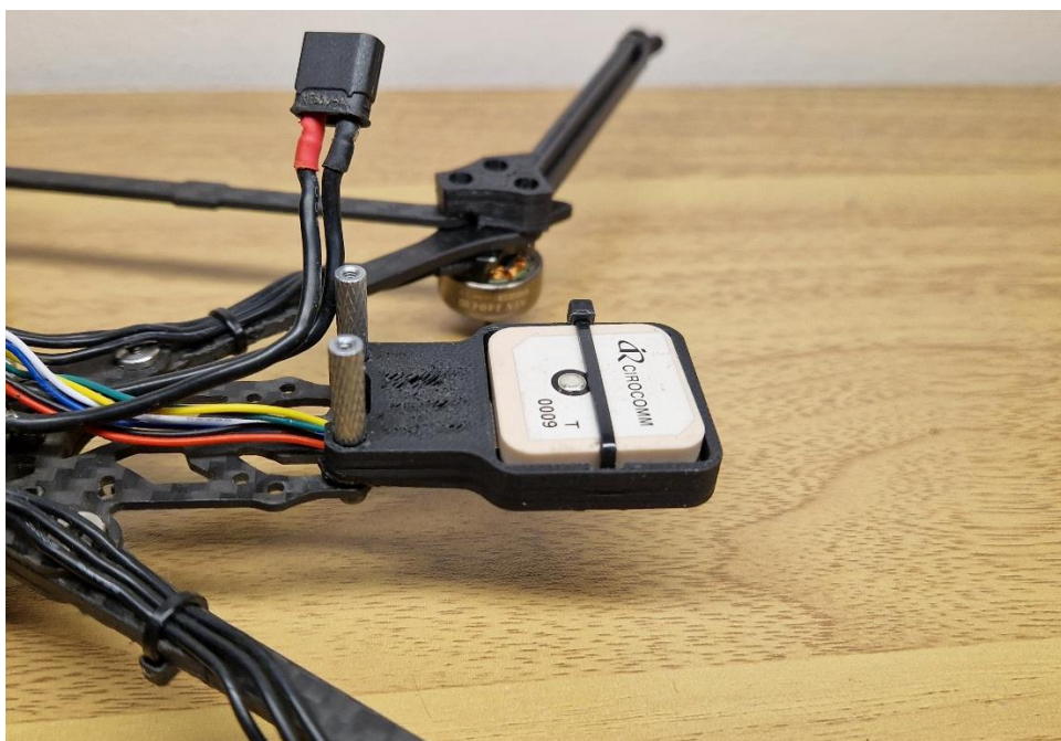
Obrázek 66 - Upevnění GNSS modulu do 3D tištěné platformy
