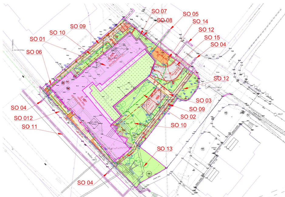
Obrázek 6. Rozdělení stavby na stavební objekty [autor]
