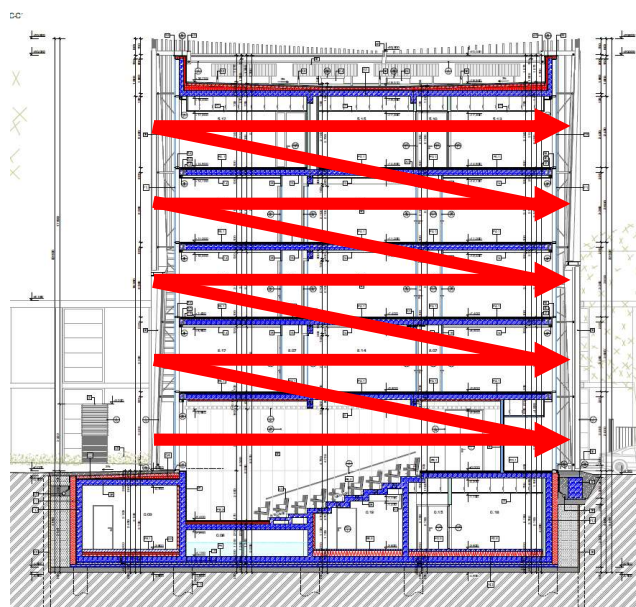
Obr. 16 - Směr postupu výstavby – TE 7 [1]
