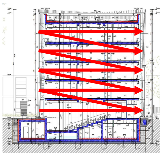
Obr. 14 - Směr postupu výstavby – TE 5 [1]
