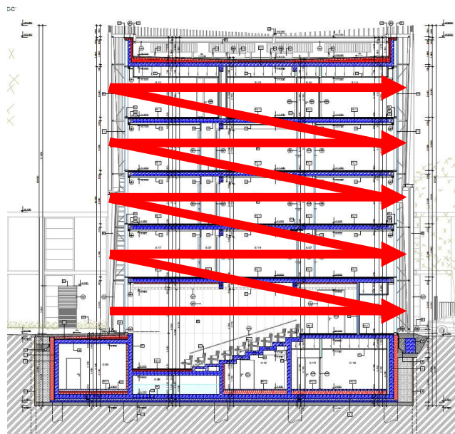
Obr. 17 - Směr postupu výstavby – TE 8 [1]
