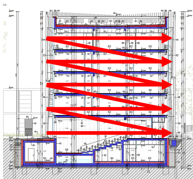
Obr. 18 - Směr postupu výstavby – TE 9 [1]
