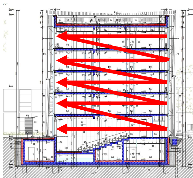
Obr. 19 - Směr postupu výstavby – TE 10 [1]
