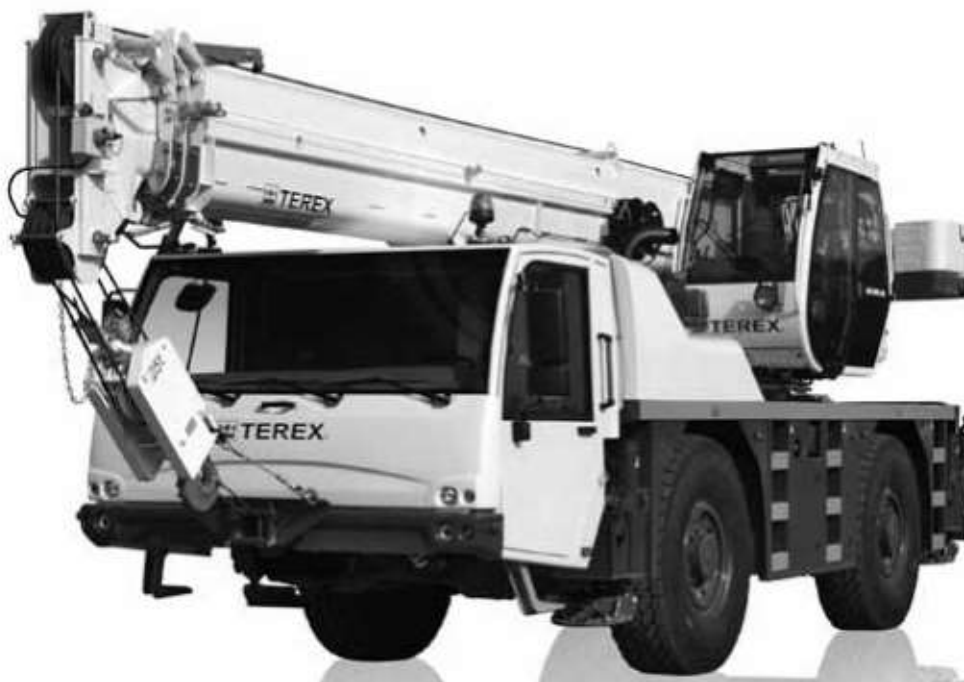
Obr. 21 - Autojeřáb Terex Demag AC 40/2L[6]
