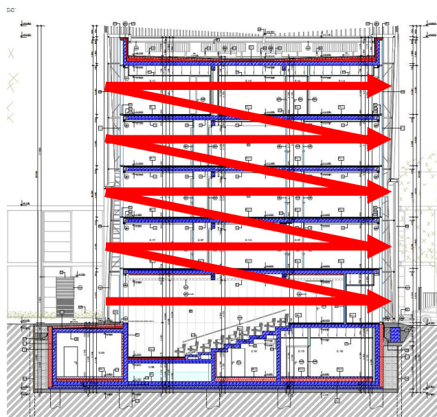
Obr. 15 - Směr postupu výstavby – TE 6 [1]
