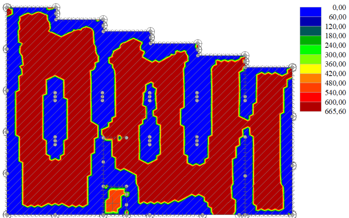
Obr. 83 Grafické zobrazení potřebné dolní výztuže základové desky v podélném směru, výstup z programu GEO5 2024 – Deska (hodnoty v \text{mm}^2/\text{m} )
