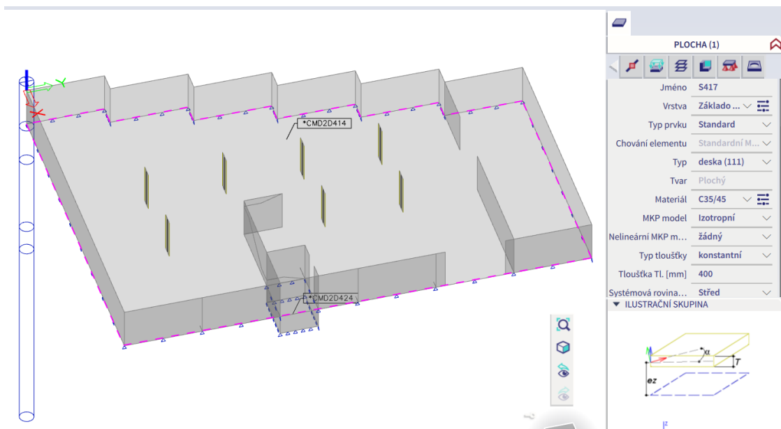
Obr. 90 Hlavní základová deska – SCIA Engineer v22.1
