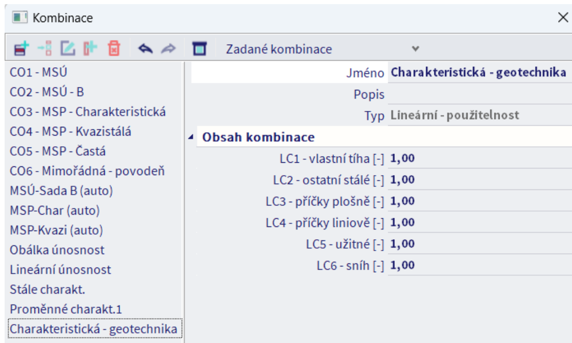
Obr. 96 Kombinace zatěžovacích stavů – SCIA Engineer v22.1
