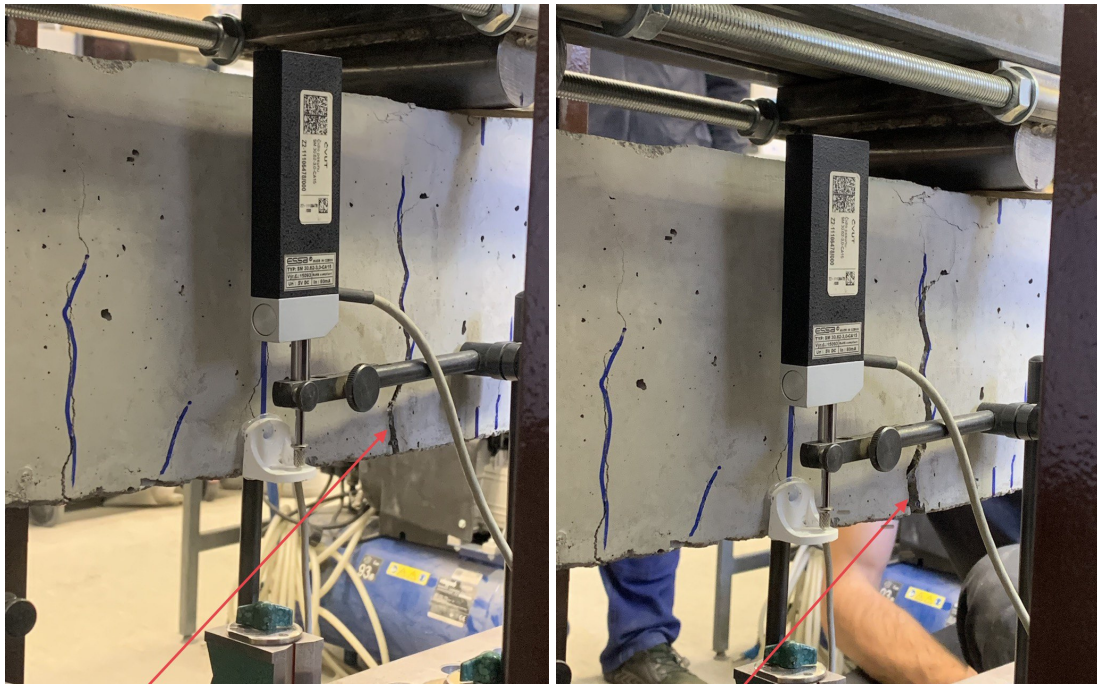
(a) Trhlina před porušením
