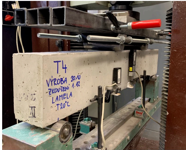
Obr. 2.57: Trámek zesílený lamelou osazený v lisu pro zkoušení na čtyřbodový ohyb
