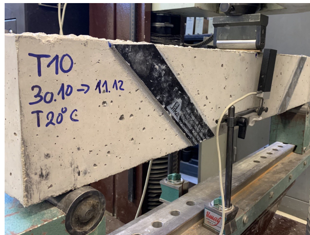
Obr. 2.75: Trámek zesílený lamelou v ohybu a smyku osazený v lisu pro zkoušení na třibodový ohyb
