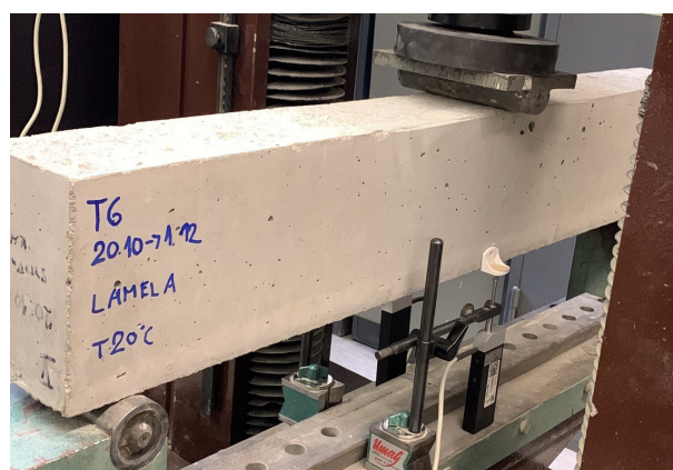
Obr. 2.65: Trámek zesílený v ohybu osazený v lisu pro zkoušení na třibodový ohyb
