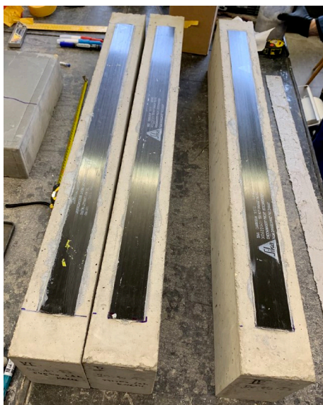
Obr. 2.46: Nalepené lamely na trámky
