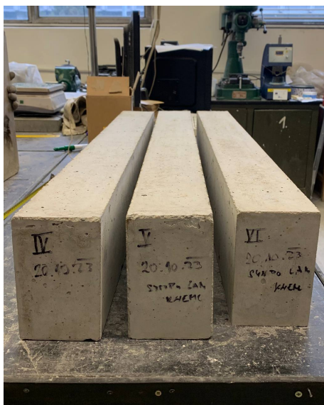
Obr. 2.37: Trámky před nalepením
