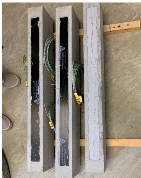
Obr. 2.47: Nalepené lamely na trámky s termočlánky
