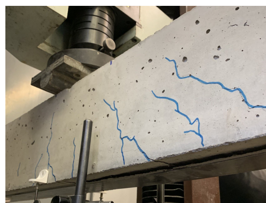
Obr. 2.67: Smykové trhliny – třibodový ohyb
