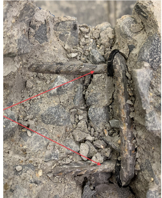
Obr. 2.71: Významná trhlina – třibodový ohyb Obr. 2.72: Protážené výztuže – třibodový ohyb
