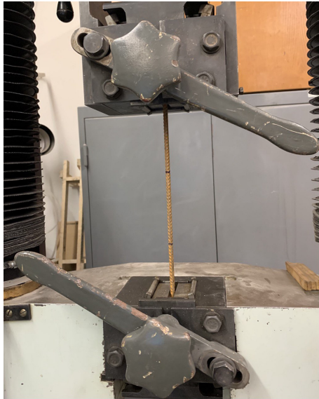
Obr. 2.11: Výztuž, upnutá mezi čelisti
