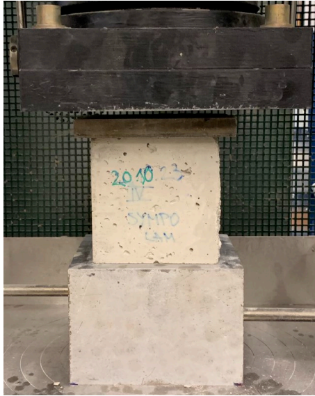
Obr. 2.7: Krychle před porušením
