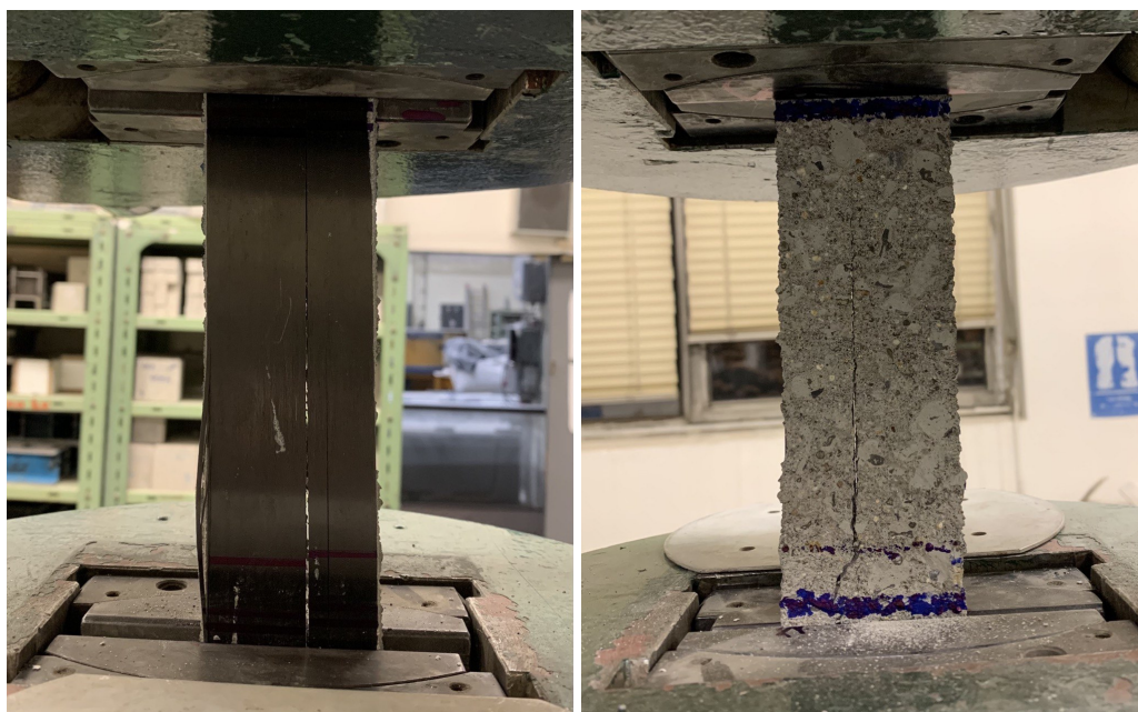
(a) Delaminovaná lamela, pohled zepředu
