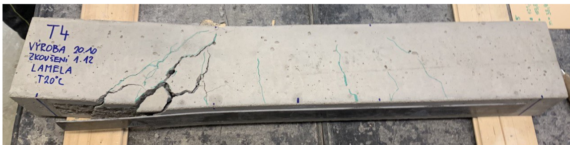
Obr. 2.61: Trámek zesílený v ohybu po porušení
