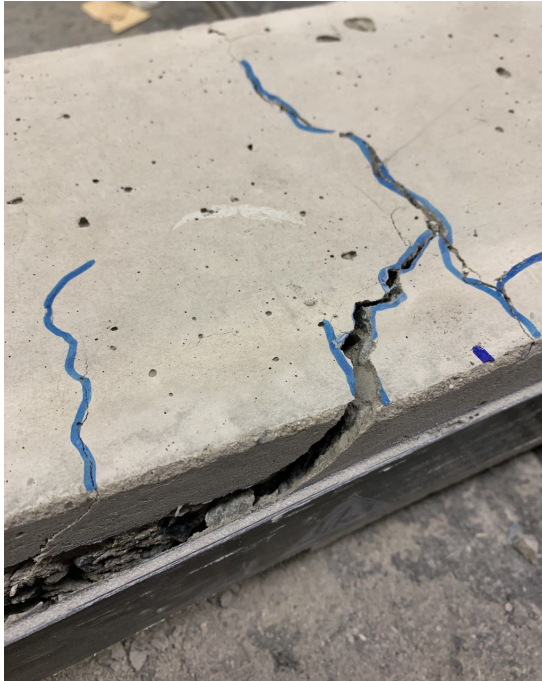
Obr. 2.71: Významná trhlina – třibodový ohyb Obr. 2.72: Protážené výztuže – třibodový ohyb
