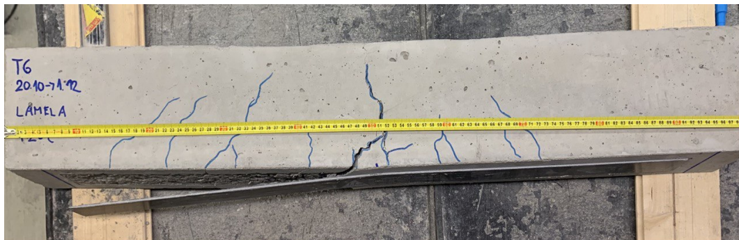
Obr. 2.70: Trápek se zesílením na ohyb po porušení – tříbodový ohyb
