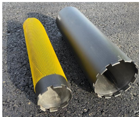
Obrázek 66 – NÁSTAVCE PRO JÁDROVÉ VÝVRTY 100 mm a 150 mm [vlastní zdroj]
