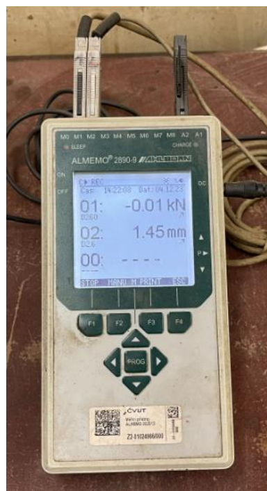
Obrázek 74 - ZAŘÍZENÍ PRO SLEDOVÁNÍ ZATĚŽOVACÍHO DIAGRAMU [vlastní zdroj]
