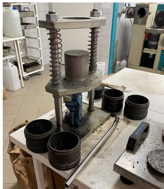
Obrázek 39 - VÝTLAČNÉ ZAŘÍZENÍ [vlastní zdroj]
