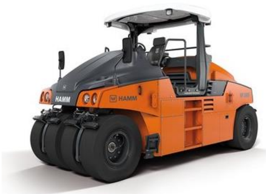
Obrázek 17 - PNEUMATIKOVÝ VÁLEC HAMM HP 280i [23]
