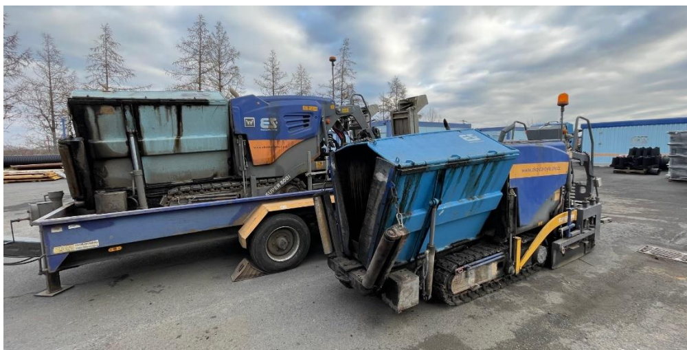
Obrázek 8 - CHODNÍKOVÉ FINIŠERY VÖGELE SUPER 800i (v pozadí) A 800 (v popředí) [vlastní zdroj]
