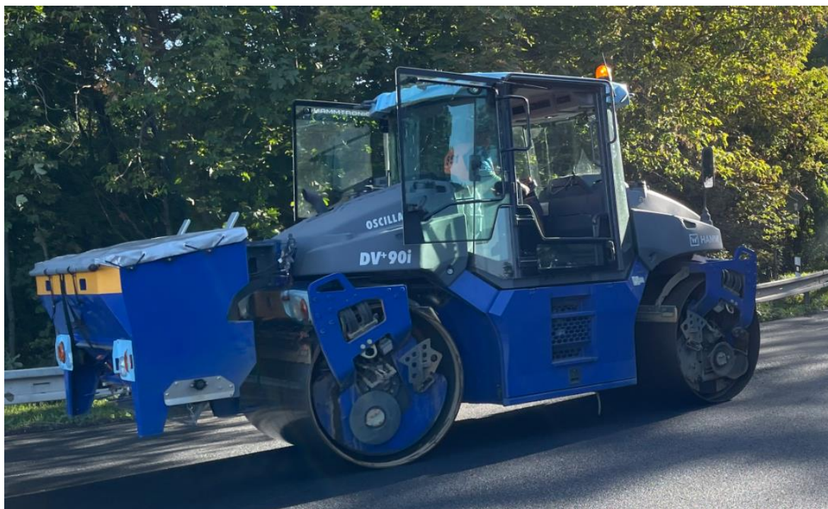
Obrázek 20 - TANDEMOVÝ VÁLEC HAMM DV+ 90i VO-S S OSCILACÍ NA ZADNÍM BĚHOUNU [vlastní zdroj]
