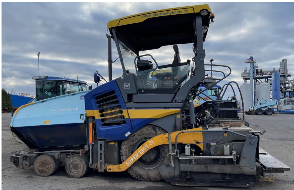
Obrázek 10 - KOLOVÝ FINIŠER VÖGELE SUPER 1803-3i [vlastní zdroj]
