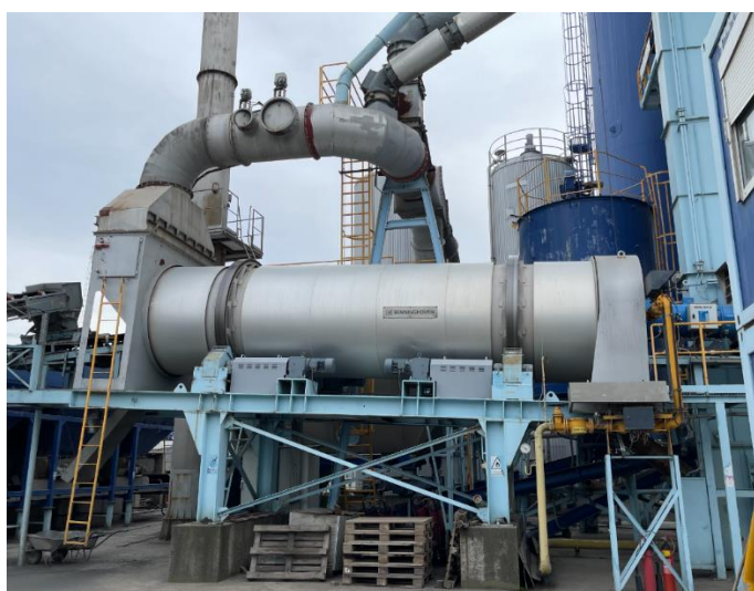
Obrázek 47 - SUŠÍČÍ BUBEN PRO OHŘEV KAMENIVA [vlastní zdroj]
