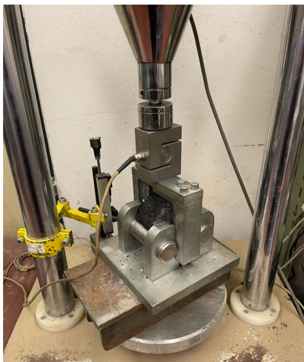
Obrázek 73 - ZAŘÍZENÍ PRO ZKOUŠKU ODOLNOSTI VŮČI ŠÍŘENÍ TRHLIN [vlastní zdroj]
