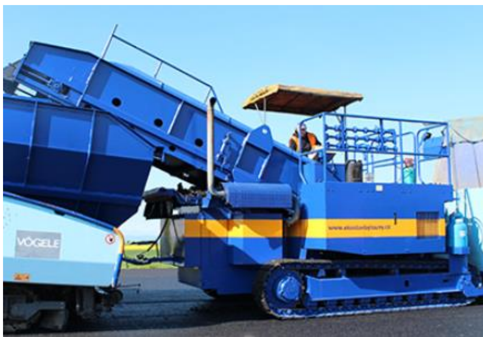
Obrázek 3 - HOMOGENIZÁTOR VÖGELE MT 1000-1 [vlastní zdroj]
