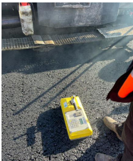
Obrázek 62 - MĚŘENÍ METODOU TROXLER ZA FINIŠEREM [vlastní zdroj]
