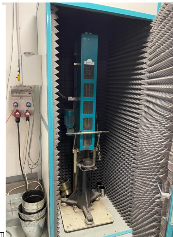
Obrázek 38 - RÁZOVÝ ZHUTŇOVAČ [vlastní zdroj]
