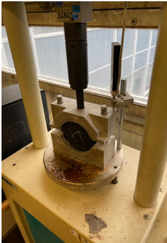
Obrázek 78 - ZAŘÍZENÍ PRO MARSHALLOVU ZKOUŠKU [vlastní zdroj]
