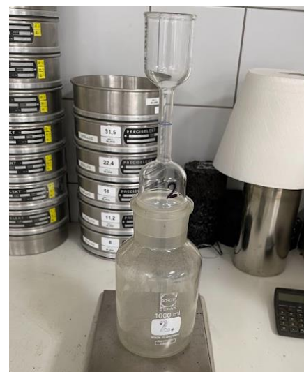
Obrázek 43 - PYKNOMETR S NÁSTAVCEM [vlastní zdroj]
