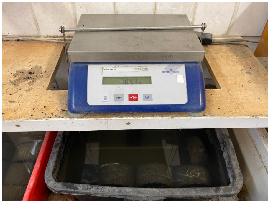
Obrázek 41 - STANOVENÍ HMOTNOSTI PONOŘENÉHO TĚLESA VE VODĚ [vlastní zdroj]
