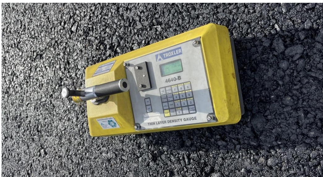
Obrázek 28 - RADIOMETRICKÁ SONDA TROXLER [vlastní zdroj]
