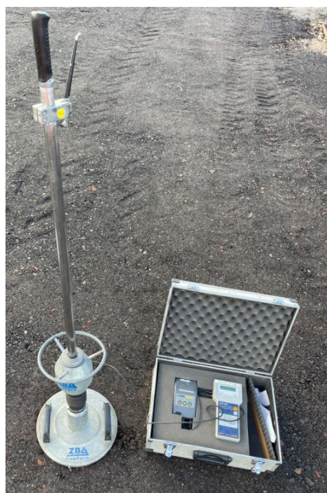
Obrázek 52 - ZAŘÍZENÍ RÁZOVÉ ZATĚŽOVACÍ ZKOUŠKY [vlastní zdroj]
