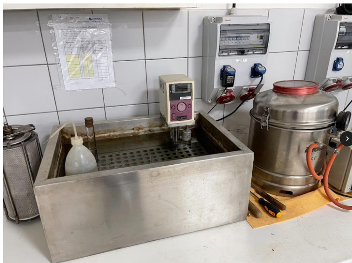
Obrázek 42 - VODNÍ LÁZEŇ S VAKUOVOU NÁDOBOU [vlastní zdroj]
