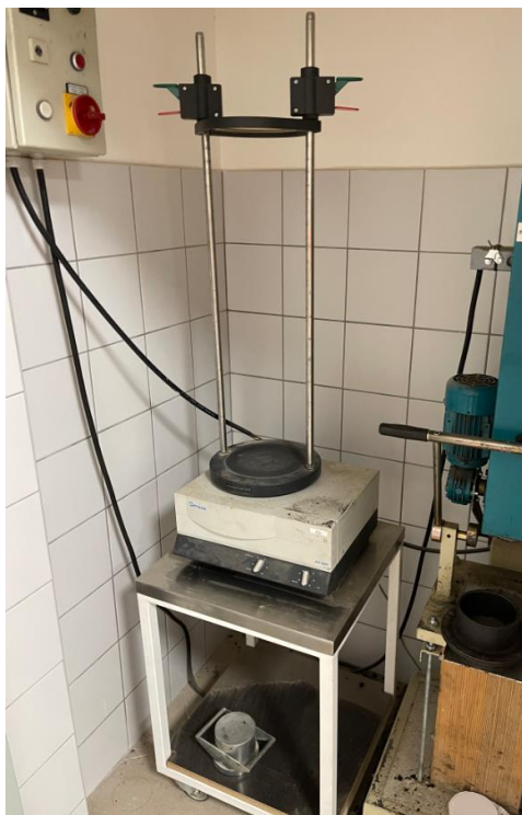
Obrázek 33 – PŘÍSTROJ PRO MECHANICKÉ PROSÉVÁNÍ [vlastní zdroj]
