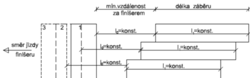
Obrázek 22 - SCHÉMA LICHOBĚŽNÍKOVÉHO POLE [11]
