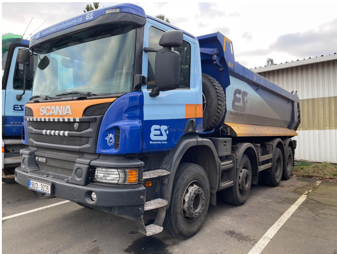
Obrázek 54 - SKLÁPĚČ 8x4 SCANIA P 410 [vlastní zdroj]
