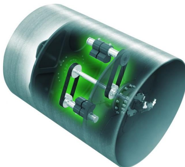
Obrázek 19 - ULOŽENÍ ZÁVAŽÍ OSCILAČNÍHO SYSTÉMU [26]
