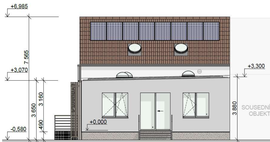
Obrázek 73 – Jižní pohled – Umístění FV panelů
