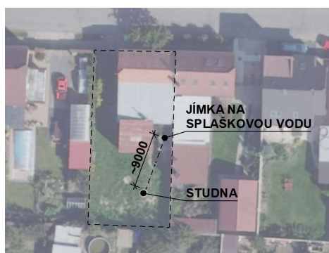
Obrázek 27 – Odstup studny a žumpy
