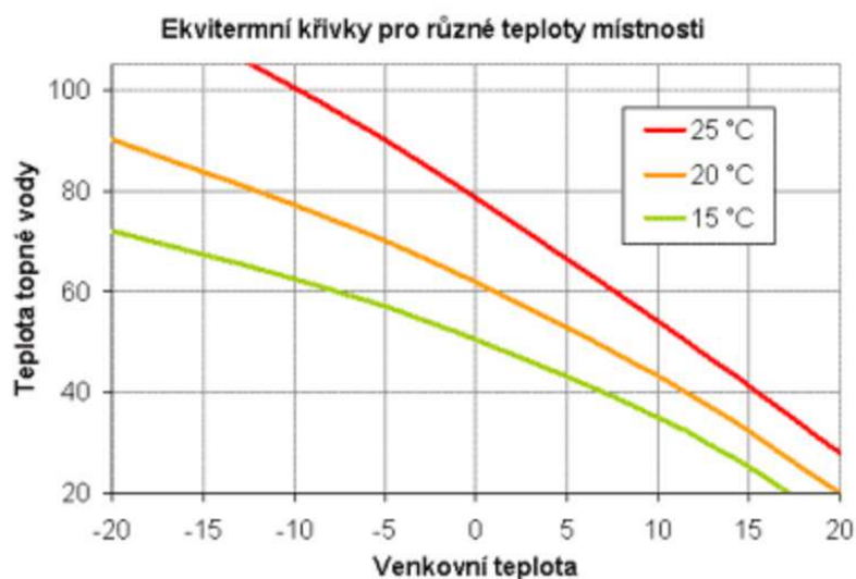
Obr.22 Ekvitermní křivky pro teploty interiéru 15, 20 a 25 °C
