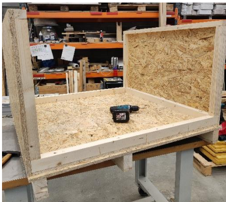
Obrázek 39 Kostra s dnem a podkladními latěmi Obrázek 40 Hotová konstrukce
