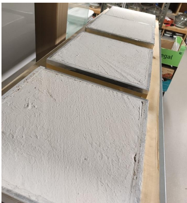
Obrázek 24 Hladký povrch sádrových omítek na konci experimentu
