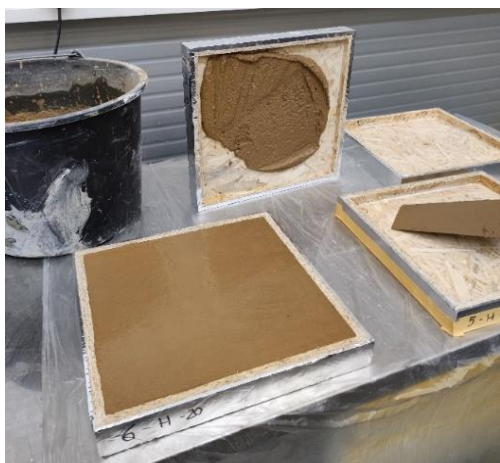
Obrázek 12 Realizace nanášení hliněných omítek
