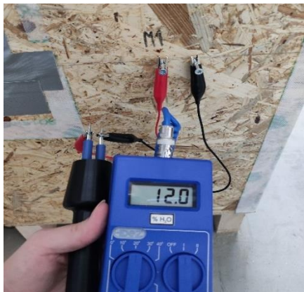
Obrázek 59 Měření vlhkosti hrotovým vlhkoměrem
