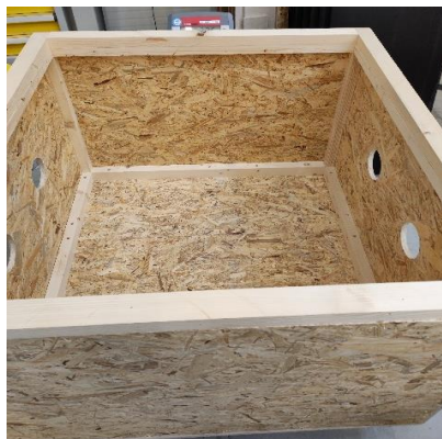
Obrázek 39 Kostra s dnem a podkladními latěmi Obrázek 40 Hotová konstrukce
