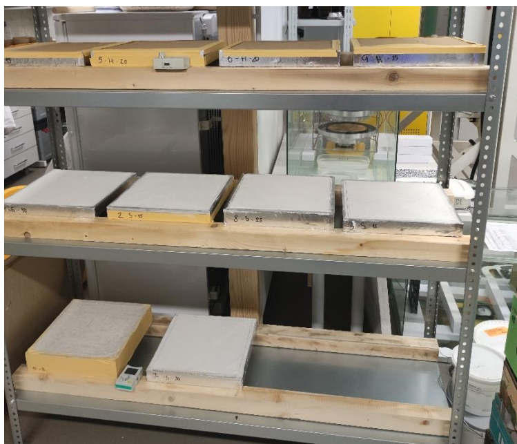
Obrázek 8 První experiment-vysychání malých vzorků
