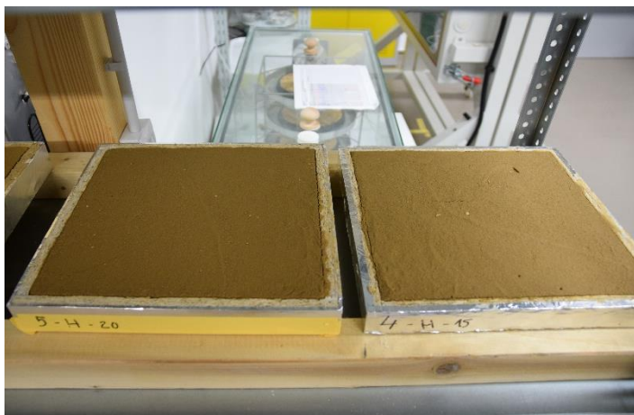
Obrázek 30 Trhliny na povrchu hliněné omítky
