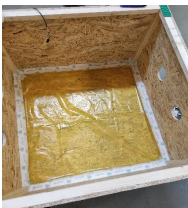
Obrázek 42 Vyložená konstrukce PE fólií Obrázek 43 Stěna 4 s nataženou PE fólií
