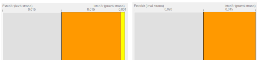
Obrázek 84 Skladby vzorků se sádrovou omítkou zadané do WUFI
