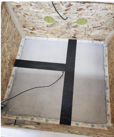
Obrázek 48 Vylepení pěnové pásky
