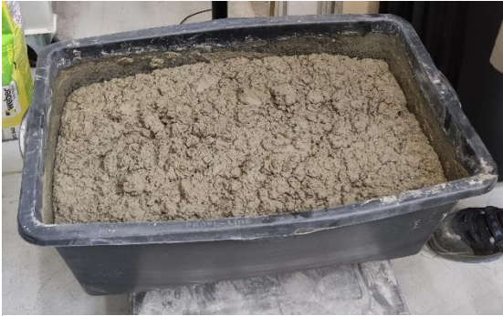
Obrázek 45 Vana s hotovou betonovou směsí
