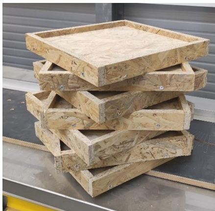
Obrázek 11 Hotové rámy pro nanesení omítek
