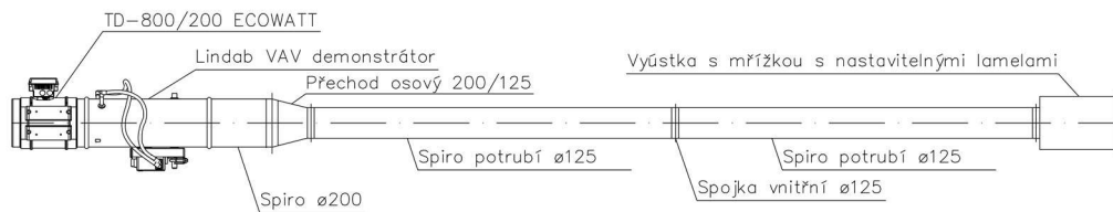
Obr. 10) Schéma modelu se Spiro potrubím ve variantě 1 – vyústka s mřížkou s lamelami
