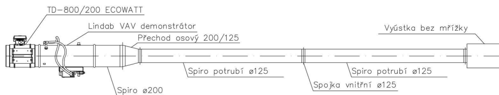
Obr. 11) Schéma modelu se Spiro potrubím ve variantě 2 – vyústka bez mřížky
