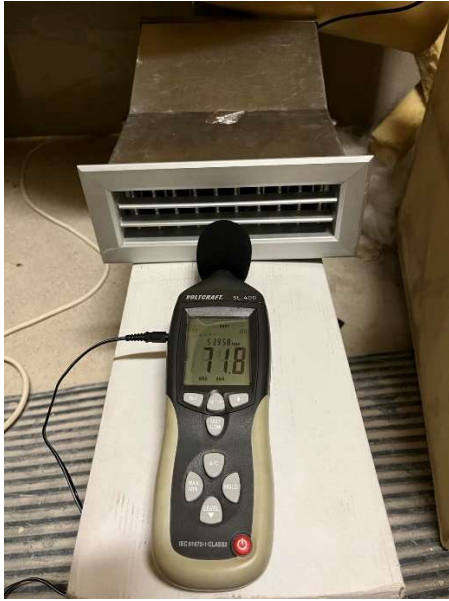
Obr. 6) Měření hodnot hluku ve variantě 1
