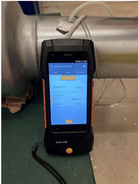
Obr. 13) Měření diferenčního tlaku za osovým přechodem Obr. 14) Měření diferenčního tlaku na vyústce
