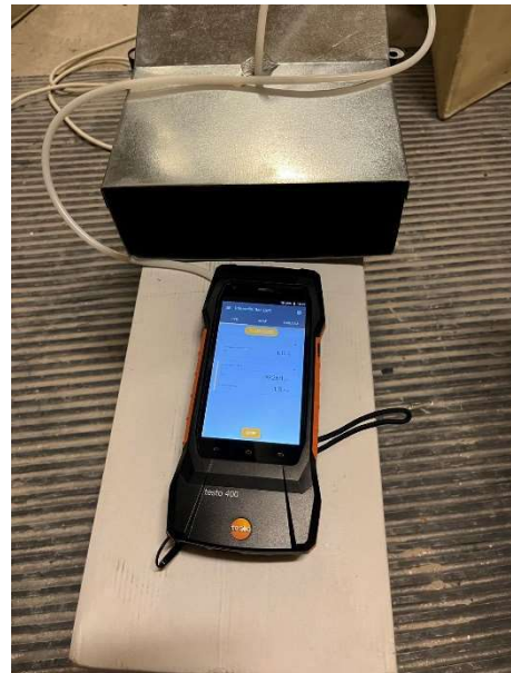
Obr. 27) Měření diferenčního tlaku za osovým přechodem Obr. 28) Měření diferenčního tlaku na vyústce
