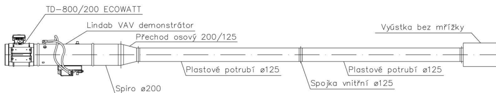
Obr. 16) Schéma modelu s plastovým potrubím ve variantě 2 – vyústka bez mřížky
