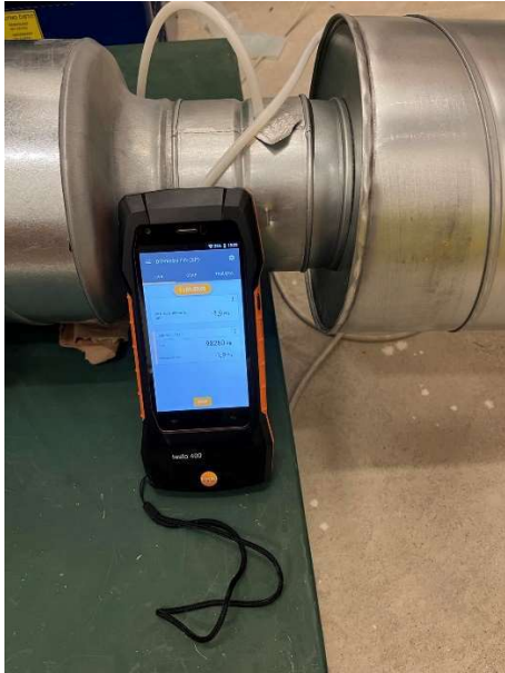
Obr. 27) Měření diferenčního tlaku za osovým přechodem Obr. 28) Měření diferenčního tlaku na vyústce
