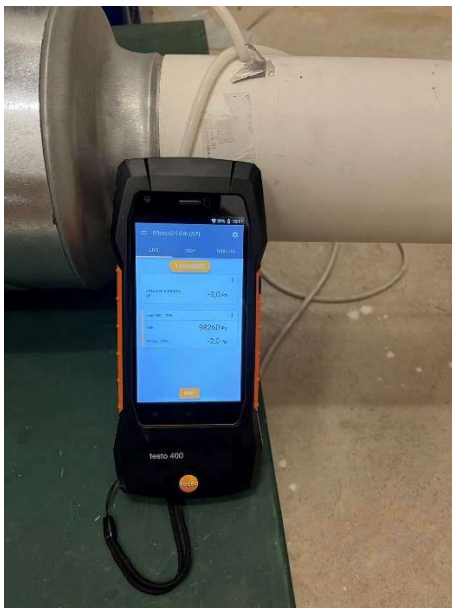
Obr. 18) Měření diferenčního tlaku za osovým přechodem Obr. 19) Měření diferenčního tlaku na výústce
