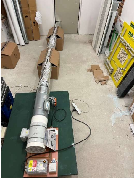
Obr. 21) Část modelu se Sonoflex potrubím umístěná v první části místnosti A-s1 14
