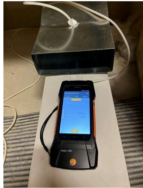
Obr. 13) Měření diferenčního tlaku za osovým přechodem Obr. 14) Měření diferenčního tlaku na vyústce
