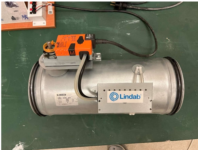
Obr. 34) Pohled shora na regulátor VRU
