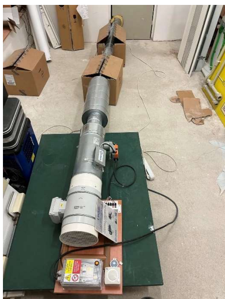
Obr. 26) Část modelu se Spiro potrubím umístěná v první části místnosti A-s114
