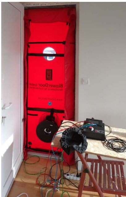
obrázek 5.1.1 - zařízení pro blower door test (zdroj: archiv autora)
