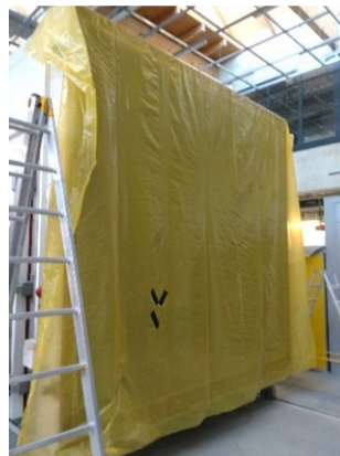
obrázek 5.1.3 - vzduchotěsná PE folie
