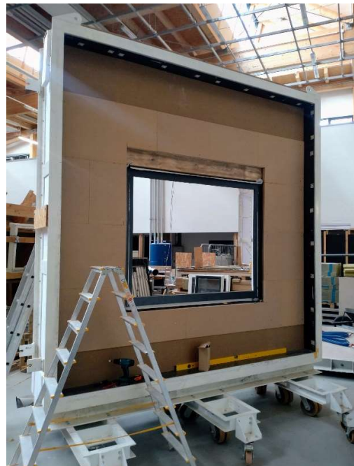
obrázek 4.3.12 - rám zaklopený izolací Steico a)
