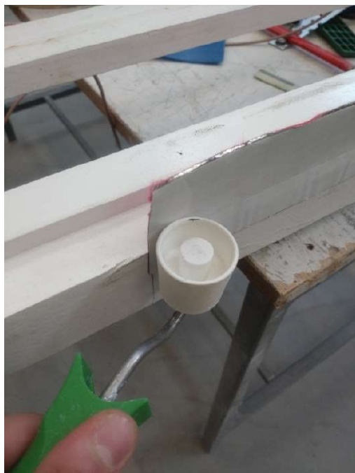
obrázek 4.3.5 - přitlačení folie válečkem a)
