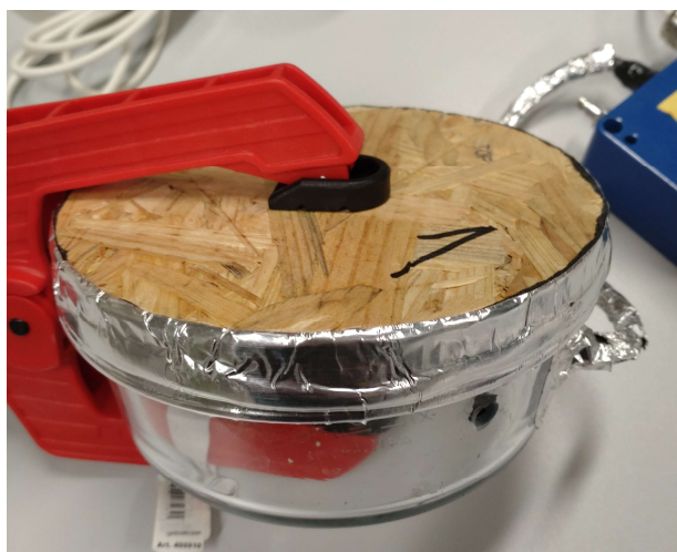
obrázek 5.2.3 - detail těsnění vzorku
