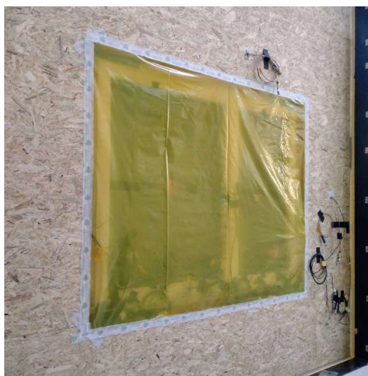
obrázek 5.1.4 - okno zakryté PE folií (1. konfigurace)
