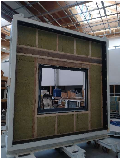
obrázek 4.3.11 - rám vyplněný izolací Isover a)
