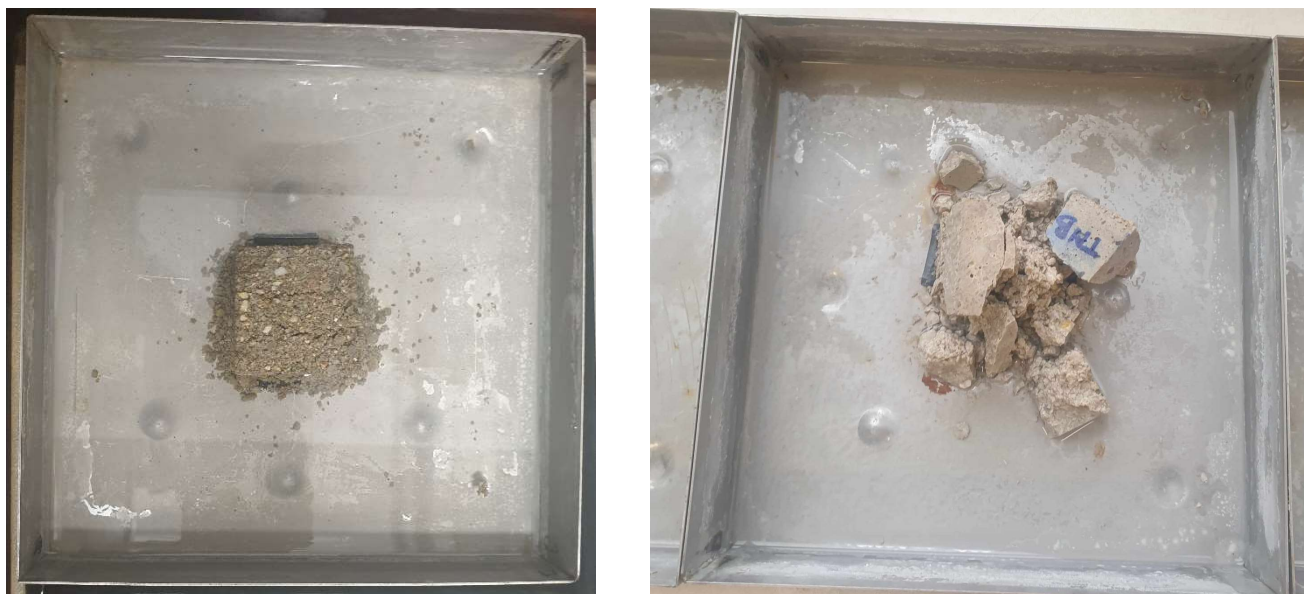
Obr. 16: Rozpad referenčních vzorků TDB (vlevo) a TNB (vpravo)
