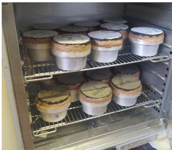
Obr. 10: Měření transportu vodní páry cup metodou, umístění v klimatické komoře
