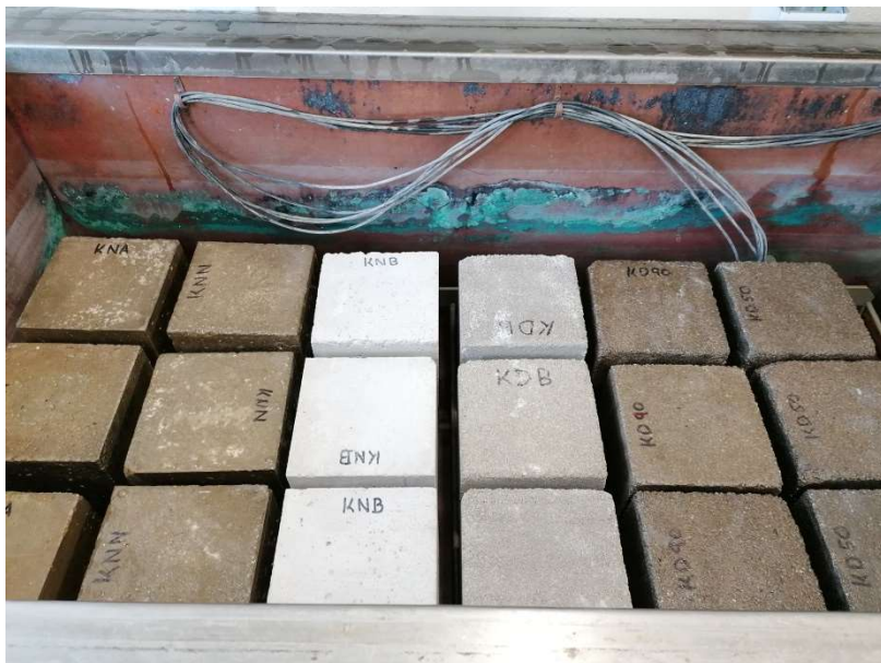
Obr. 12: Uložení vzorků do zmrazovací skříně pro zkoušku mrazuvzdornosti
