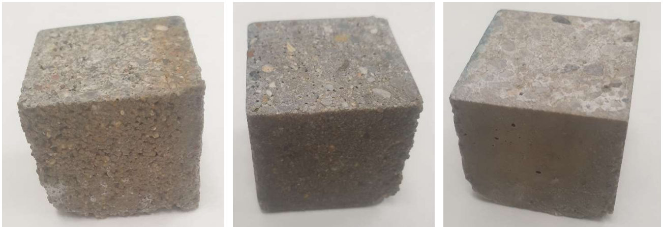
Obr. 18: Stav vzorků TD50 (vlevo), TD90 (uprostřed) a TN (vpravo) po 125. cyklu
