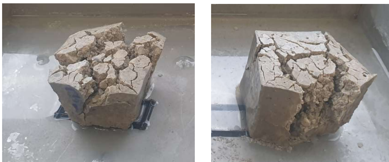
Obr. 17: Stav vzorků TNA (vlevo) a TNN (vpravo) po 50. cyklu působení CHRL
