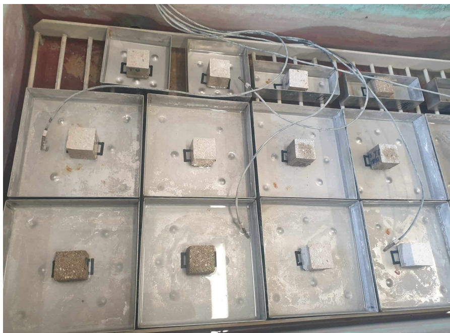
Obr. 13: Uložení vzorků v automatické zmrazovací skříni
