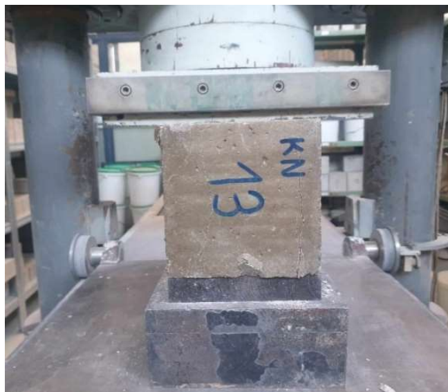
Obr. 9: Zkušební těleso během tlakové zkoušky
