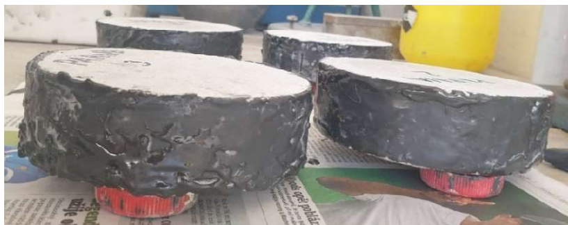
Obr. 7: Vzorky po nanesení epoxidové pryskyřice pro zajištění 1D vlhkostního toku
