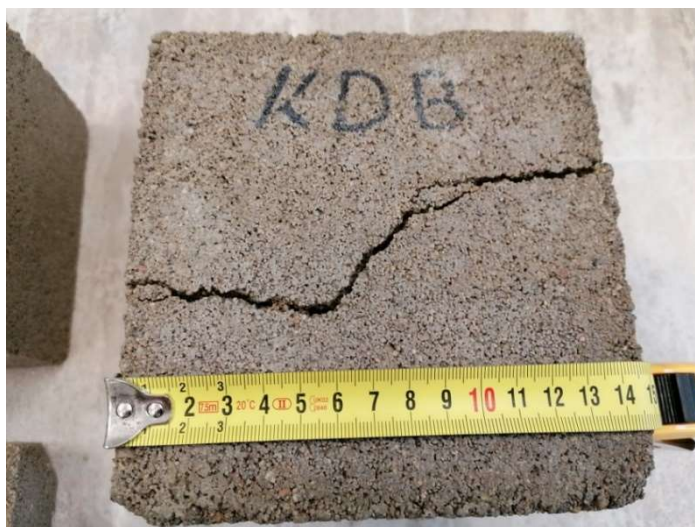
Obr. 14: Poškození referenčního vzorku KDB po 1 zmrazovacím cyklu
