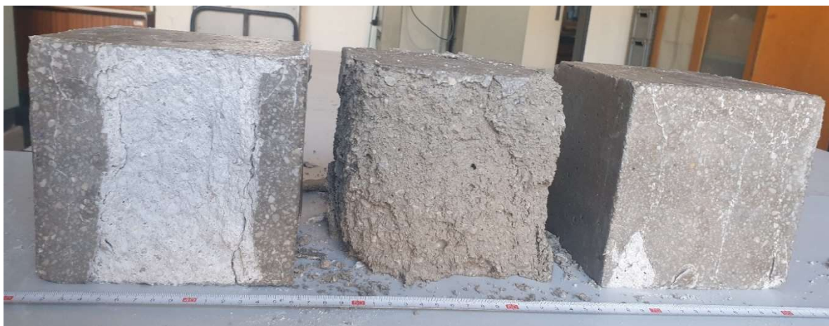
Obr. 15: Srovnání TN vzorků po 100 zmrazovacích cyklech
