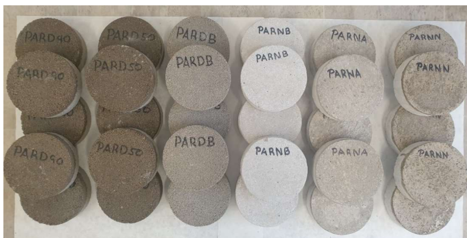
Obr. 6: Kruhové vzorky pro zkoušku propustnosti pro vodní páru
