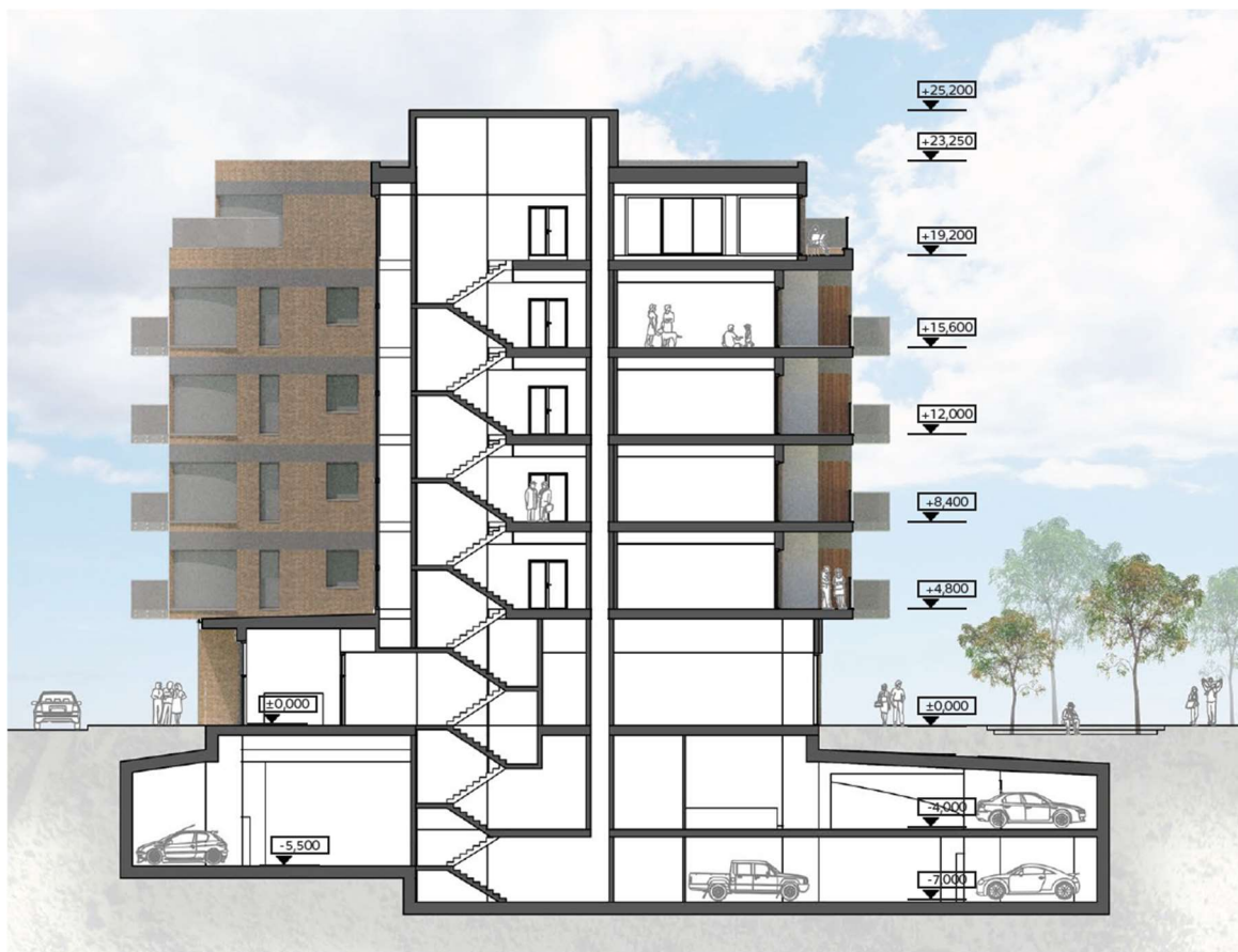
Obrázek 11 – Řešený bytový dům: Příčný řez vedený schodištěm [7]
