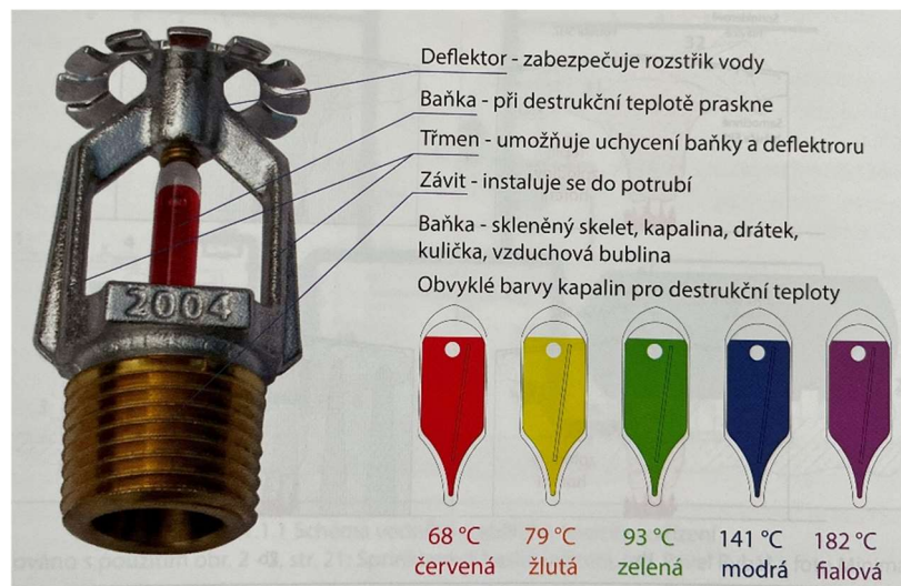
Obrázek 2–19 Barevné rozlišení hlavice podle teploty destrukce. [17]
