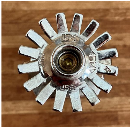
Obrázek 35 - Tříštič zkušebního sprinkleru 3
