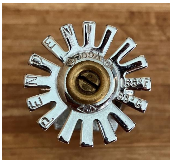
Obrázek 39 - Tříštič zkušebního sprinkleru 4
