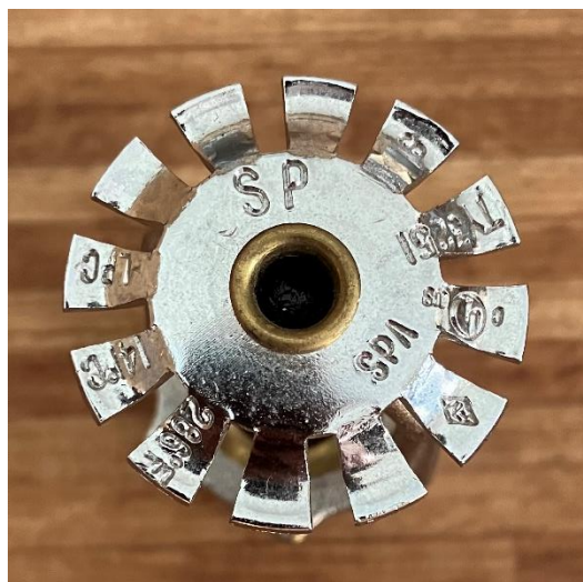
Obrázek 30 - Tříštič zkušebního sprinkleru 2
