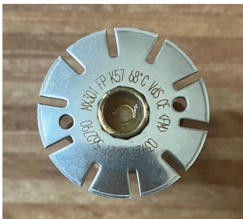
Obrázek 59 - Tříštič zkušebního sprinkleru A
