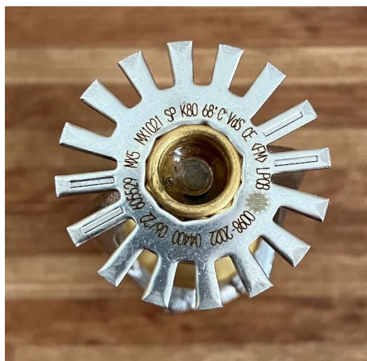
Obrázek 26 - Tříštič zkušebního sprinkleru 1
