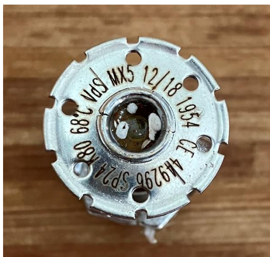
Obrázek 43 - Tříštič zkušebního sprinkleru 5
