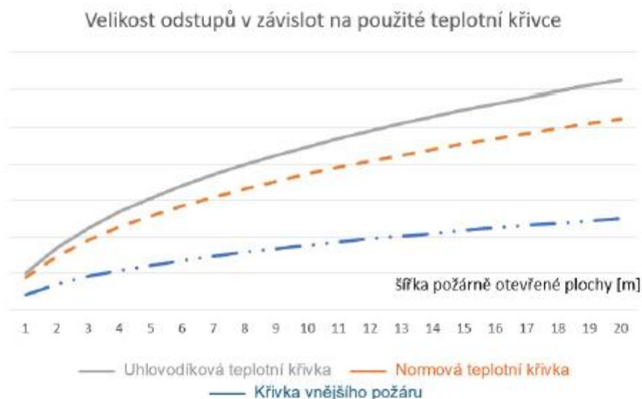
Obrázek 18 – Graf rozdílů velikosti odstupů vůči použité teplotní křivce při konstantní výšce plamene 6 m [11]
