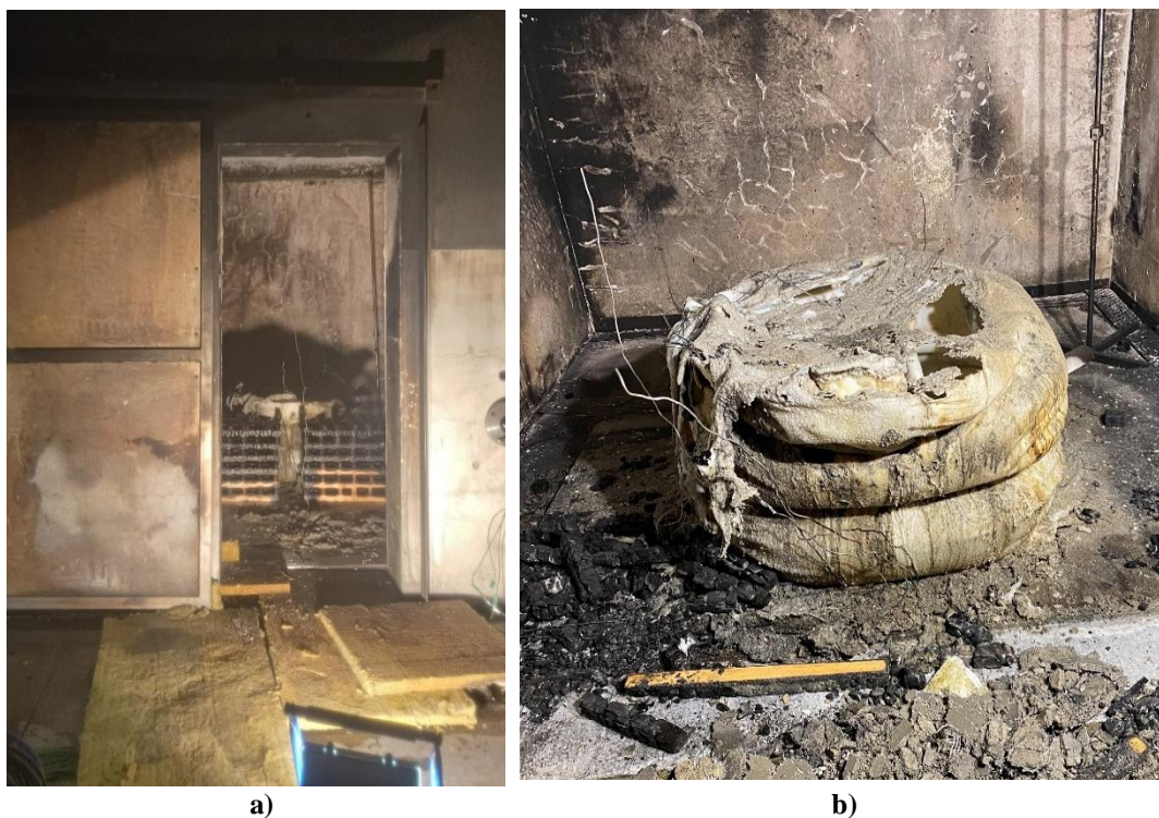
Obrázek 67 – a) Stav RCT místnosti po uhašení; b) tvar nádrže druhý den po zkoušce
