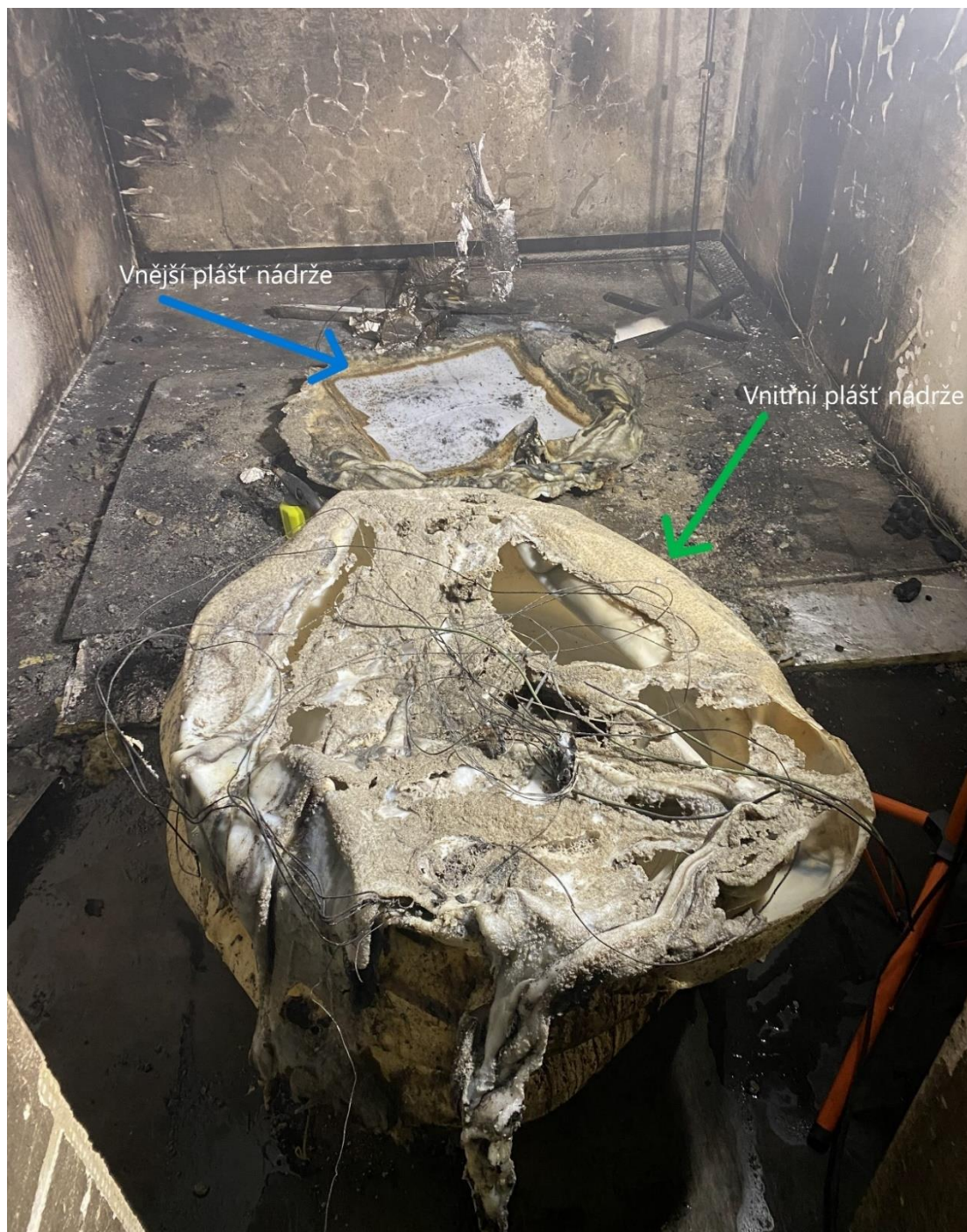
Obrázek 69 – Stav jednotlivých plášťů plastové nádrže
