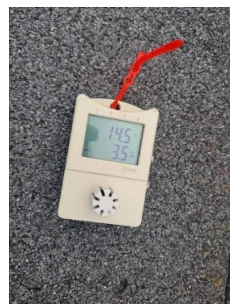
Obr. 60 — Teploměr, vlhkoměr se záznamem datalogger COMET S3120E
