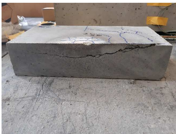
a) Panel po zkoušce
