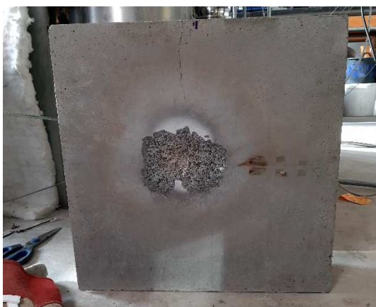
a) Panel po zkoušce
