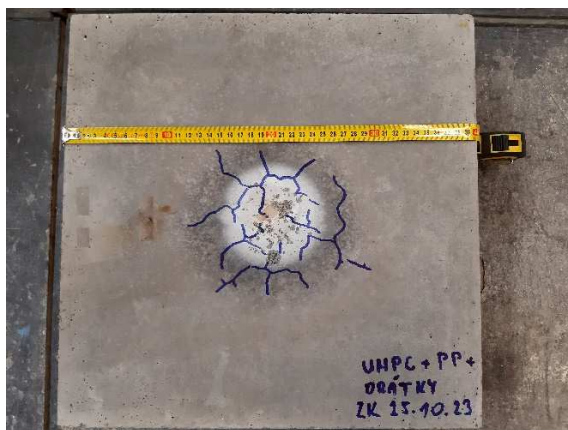
a) Panel po zkoušce
