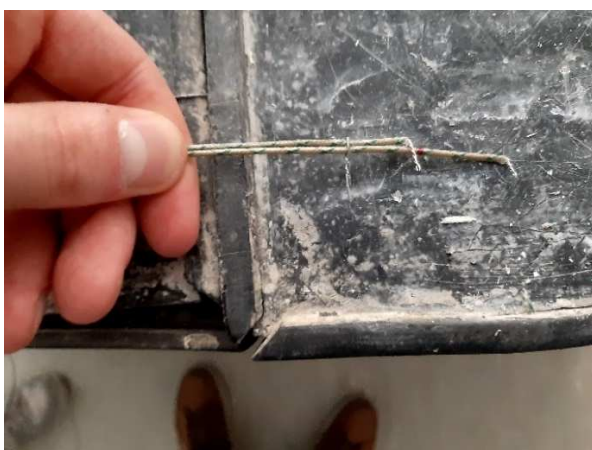
a) Kabelové termočlánky T_k ve vzdálenosti 20 mm od sebe
