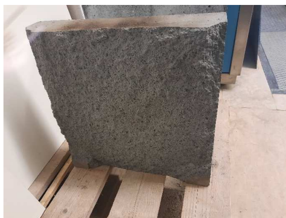
b) Charakter porušení při 1D vedení tepla
