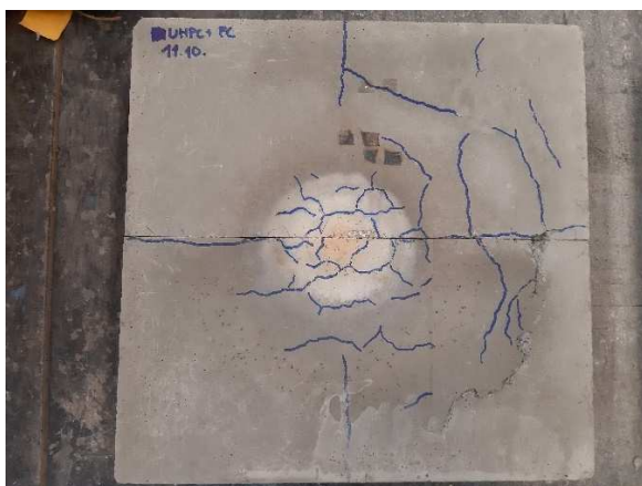
a) Panel po zkoušce
