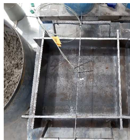
b) Umístění a připevnění kabelových termočlánků T_k do kovové formy
