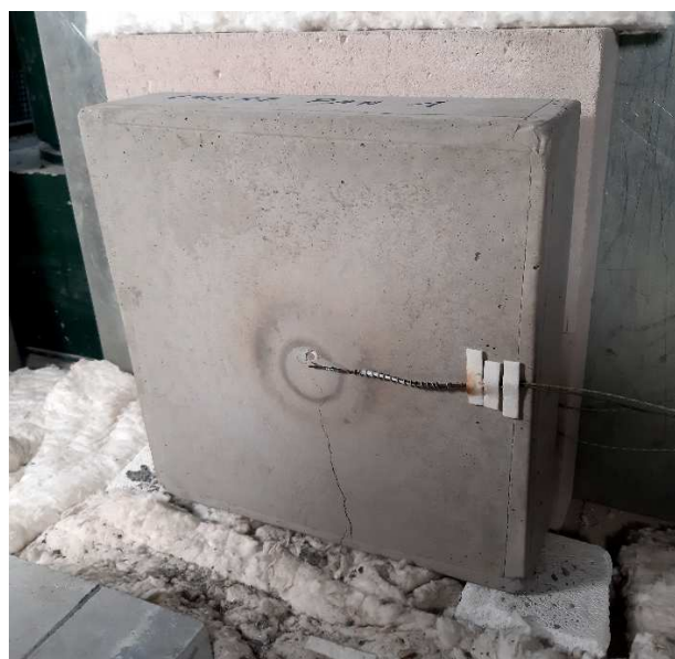
b) Panel po zkoušce
