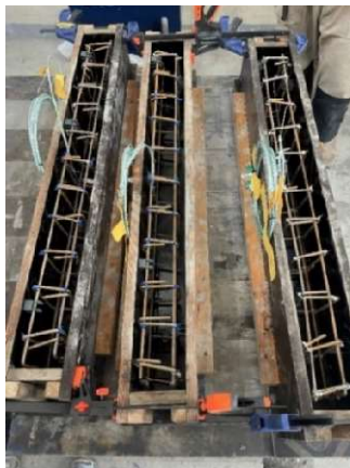
Obrázek 55 Připevnění termočlánků do bedně
