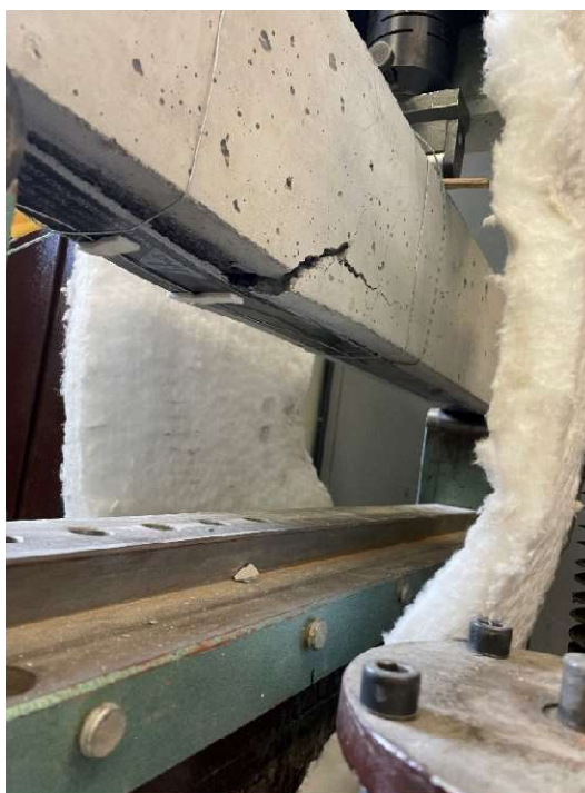
Obrázek 69 Porušení nosíku T8 po ukončení zkoušky
