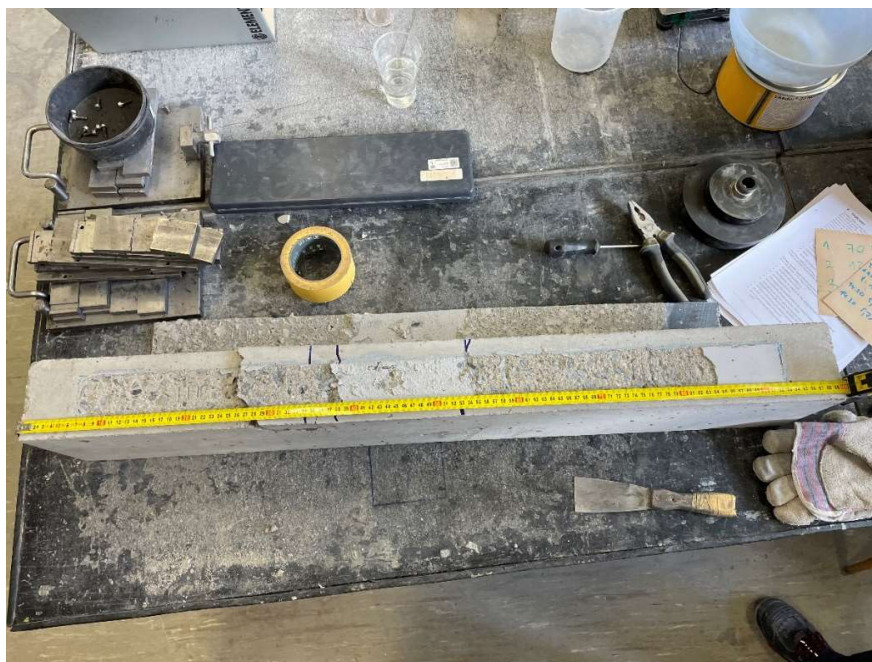
Obrázek 70 Nosník T8 s odtrženou lamelou, uprostřed lze vidět zbylé lepidlo co se odlepilo od lamely, pravá část je odtržena až po zkoušce ručně i zde lepidlo s lamelou zůstalo
