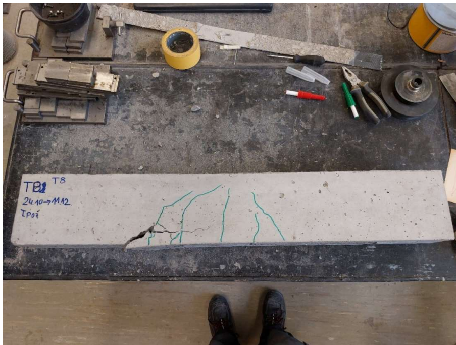
Obrázek 74 Nosník T8 po provedení zkoušky s vyznačením vzniklých trhlin
