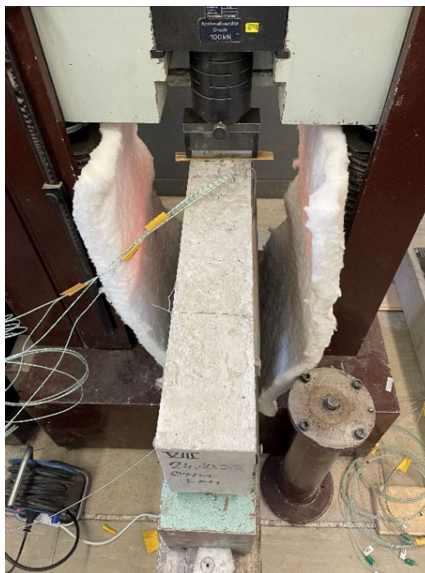
Obrázek 64 Nosník připravený ke zkoušce
