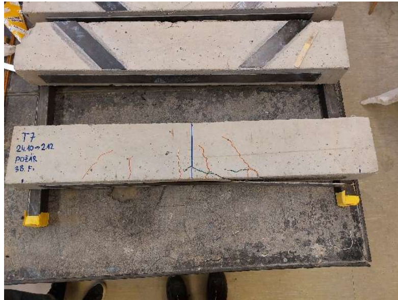
Obrázek 67 Nosník T7 po zkoušce s vykreslením trhlin
