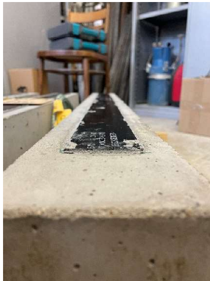
Obrázek 59 Lamela nalepená na nosníku
