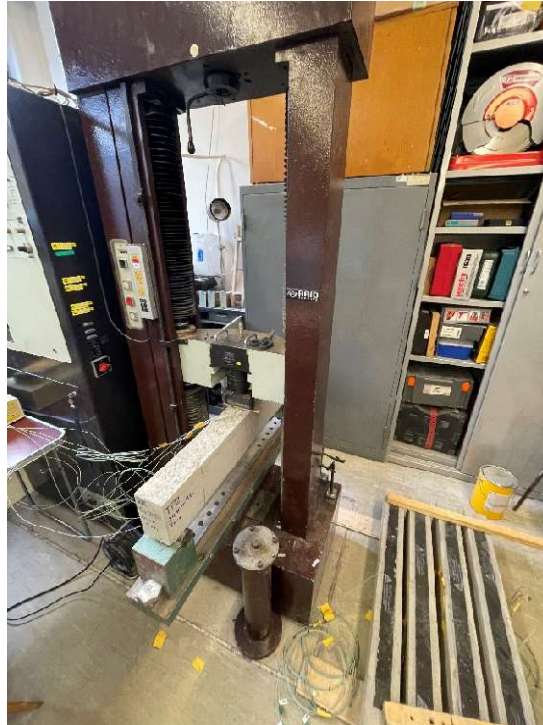
Obrázek 52 Hydraulický lis FP100
