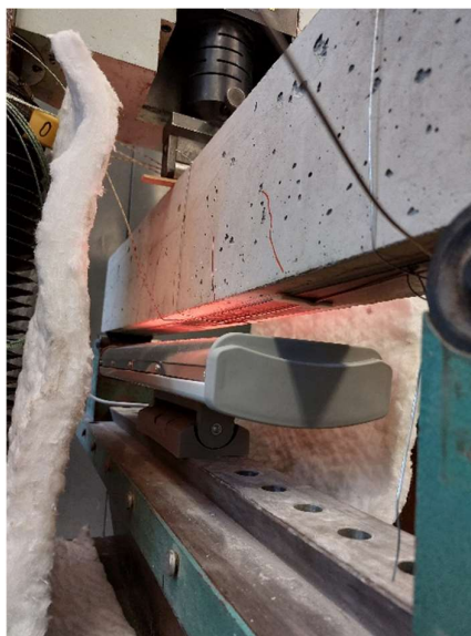
Obrázek 65 Sálavé zařízení působící na nosník
