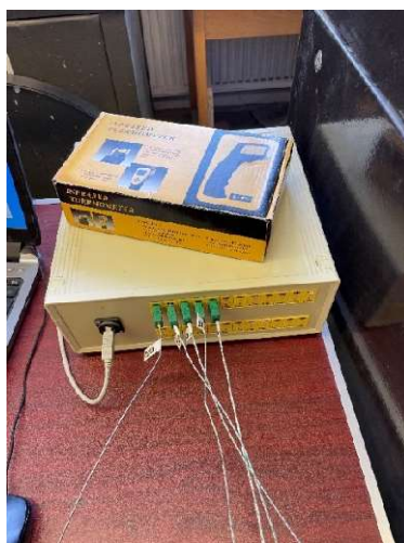
Obrázek 63 Datalogger propojený s termočlánky
