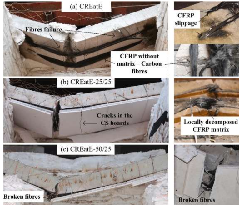
Obrázek 33 Pozorování desek po požáru zesílené technikou CREatE, převzato z [27], Fig. 12.
