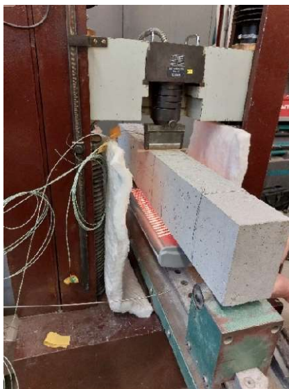
Obrázek 66 Ochrana lisu před účinky zvýšených teplot
