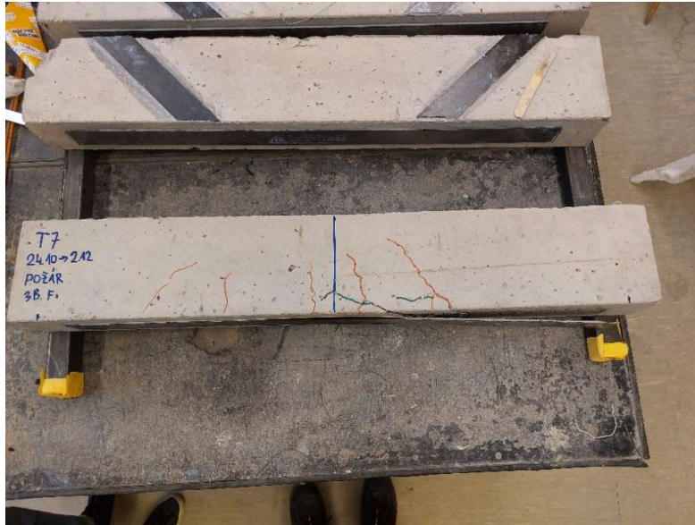
Obrázek 73 Nosník T7 po provedení zkoušky s vyznačením vzniklých trhlin
