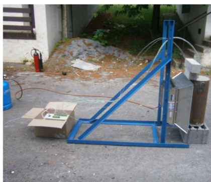
Obrázek 47 Sálavý plynový hořák (Světelný zářič) [41]
