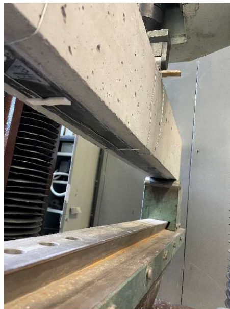
Obrázek 51 Termočlánek připevněný pod lamelou
