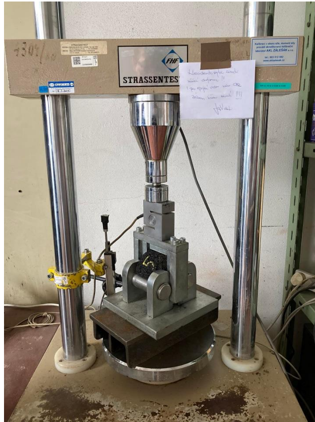
Obrázek 31 Přístroj na zkoušení šíření trhlin [23]
