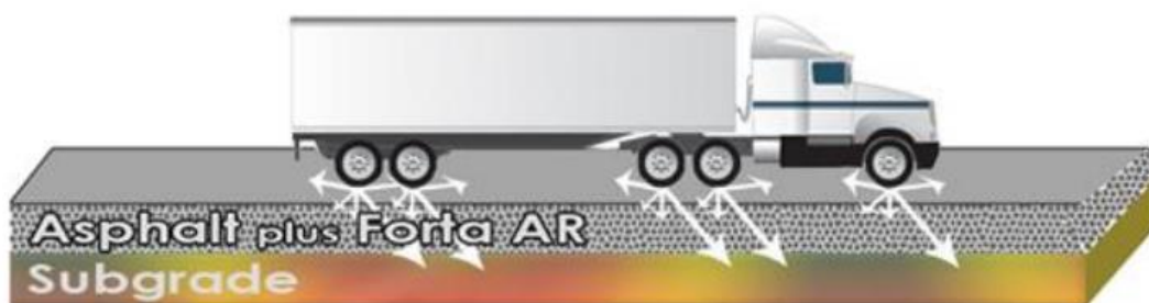
Obr. 2 Vyztužená asfaltová směs vlákny FORTA. Roznos zatížení při brzdění do více směrů [7]
