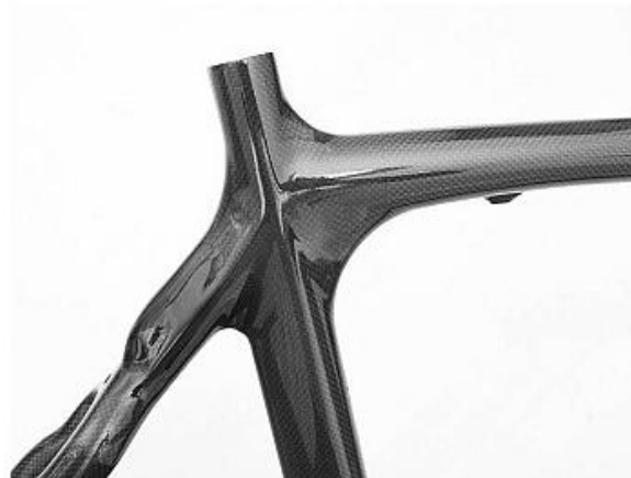
Obr. 11: Rám z uhlíkových vláken s čirým lakem [21]
