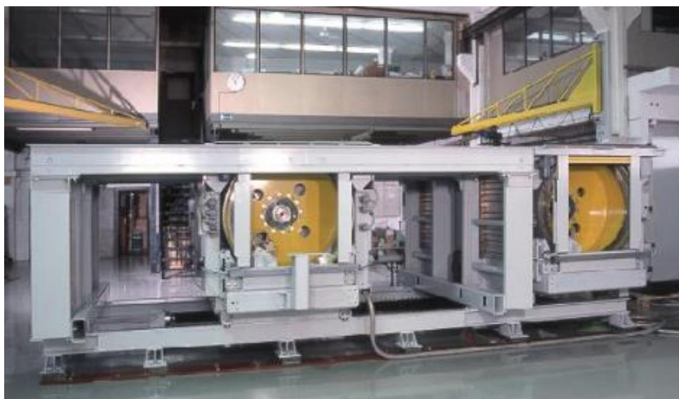
Obr. 17 – Konstrukční uspořádání vozidlového dynamometru Maha AIP-ECD 48L [17]
