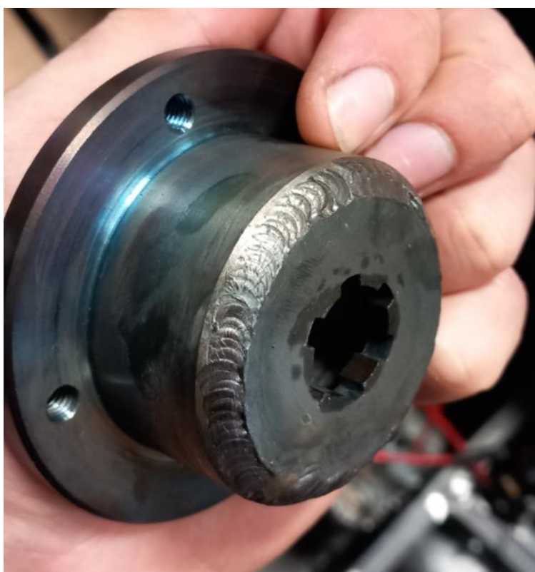
Obr. 26 – Adaptér nahrazující řetězové kolo sekundárního převodu po svaření
