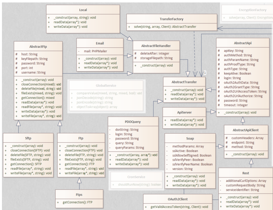
■ Obrázek 4.4 Část diagramu tříd s třídami pro přenos dat.
