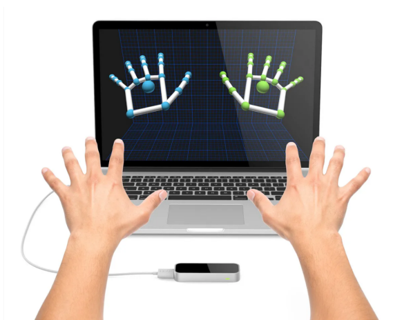
■ Obrázek 1.1 Hand-tracking pomocí senzoru Leap Motion Controller [22]
