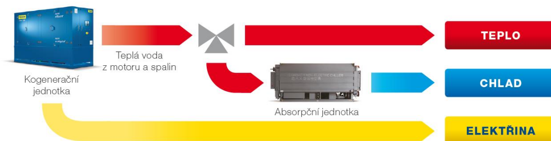
Obrázek 4: Schéma trigenerace s teplovodní absorpční chladicí jednotkou [2]
