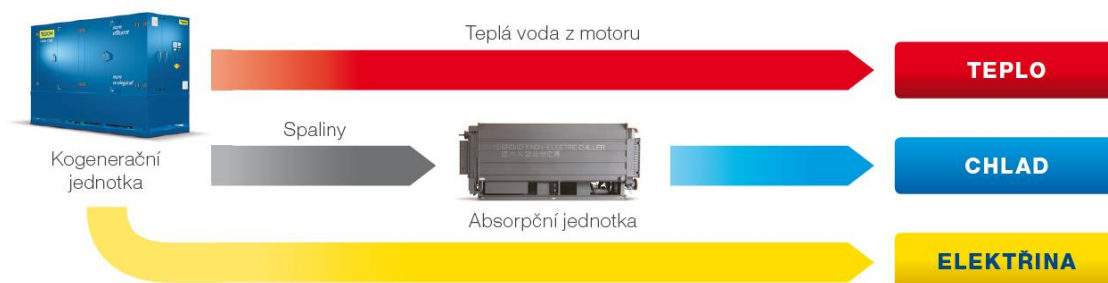
Obrázek 5: Schéma trigenerace se spalínovou absorpční chladicí jednotkou [2]
