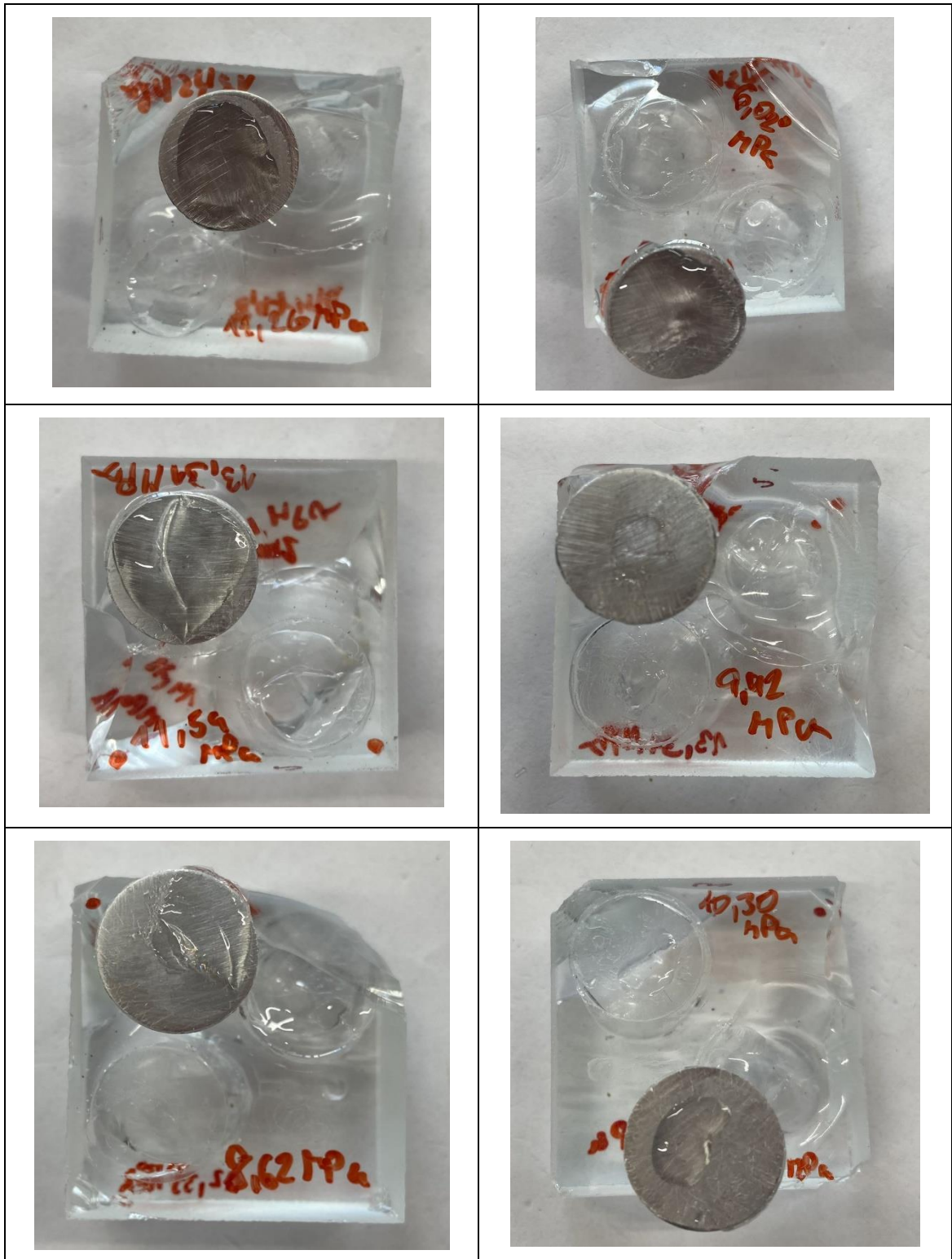
Lepidlo Auratech AR 011, předúprava odmašténím, druhé odtrhy
