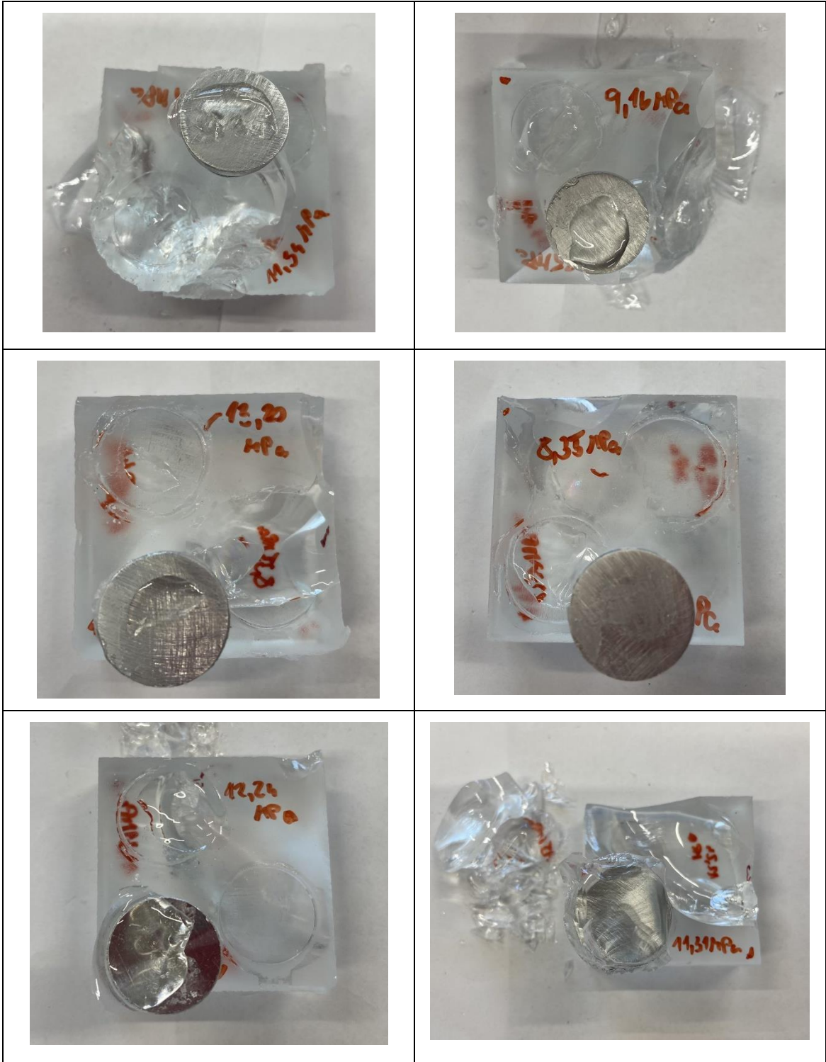
Lepidlo Auratech AR 011, předúprava lepiánim, druhé odtrhy
