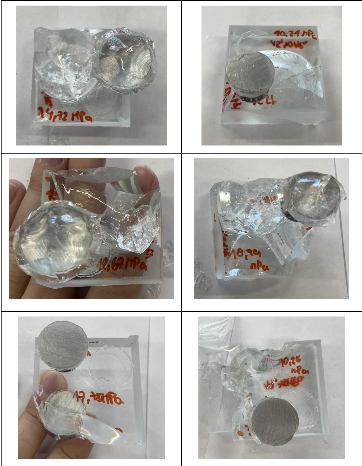
Lepidlo Auratech AR 708, předúprava odmaštěním, druhé odtrhy
