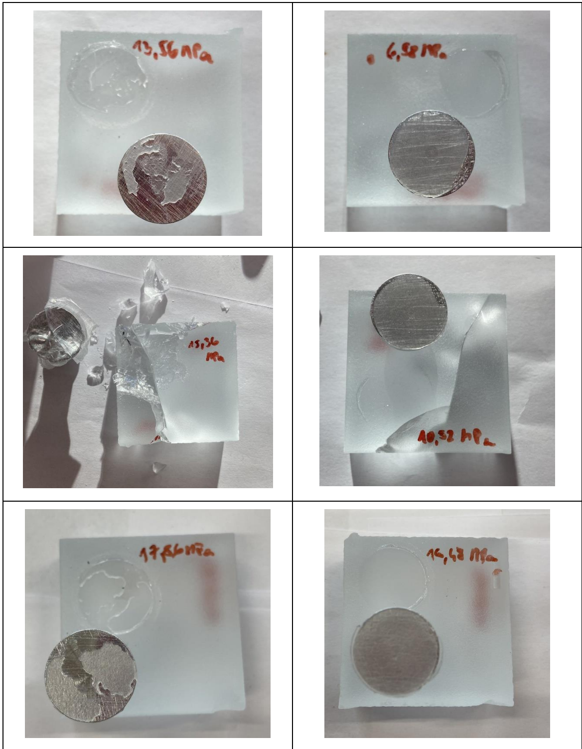
Lepidlo Auratech AR 708, předúprava tryskáním, první odtrhy
