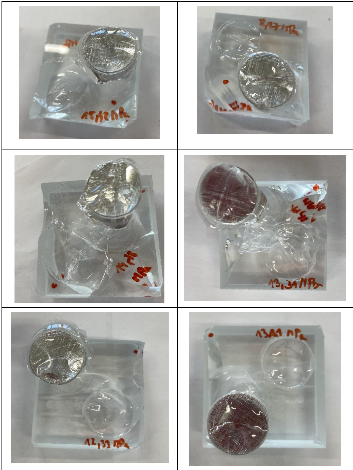
Lepidlo Auratech AR 011, předúprava odmaštěním, první odtrhy
