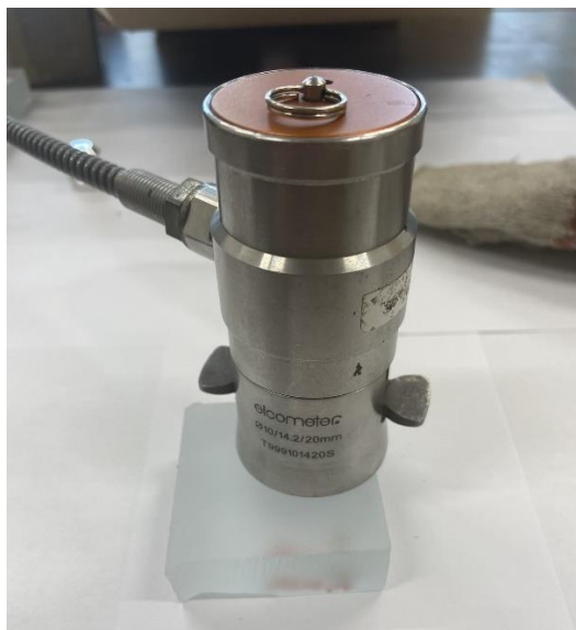
Obrázek 25 - Odtrhoměr Elcometer 510 zajištěný na nalepené panence
