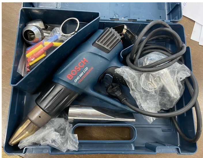
Obrázek 7 - Horkovzdušná pistole Bosch GHG 660 LCD Professional
