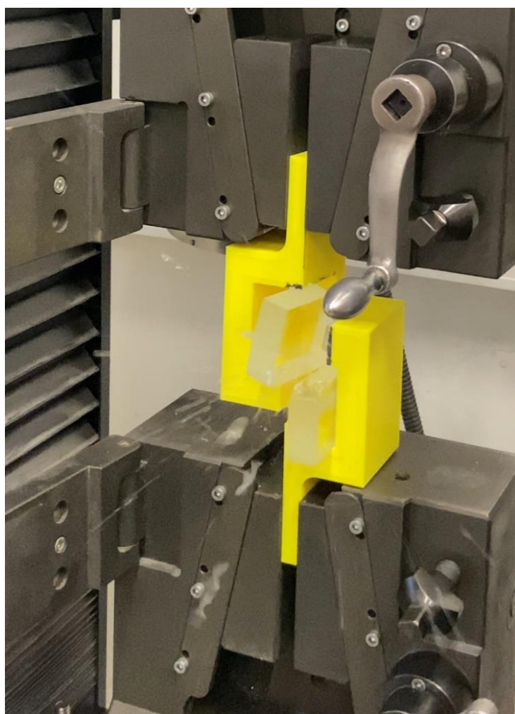
Obrázek 41 - Moment porušení při střihové zkoušce, lepidlo EA 9455
