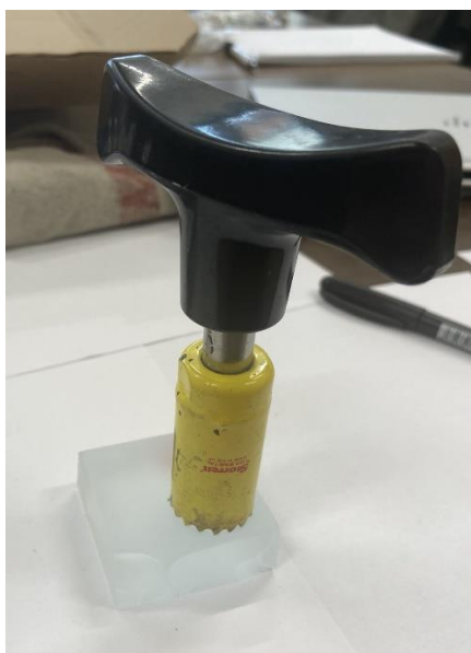
Obrázek 24 - Okroužení panenek pomocí vykrúžovacího vrtáku Starrett
