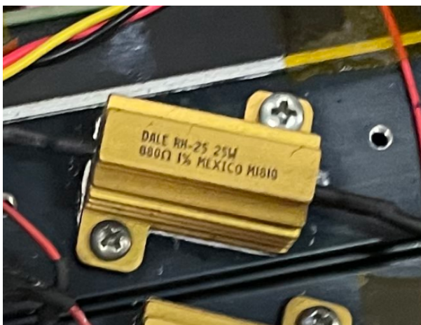
Obr. 7: Pasivní chlazení rezistorů v jednotce AMS (Accumulator Management system)
