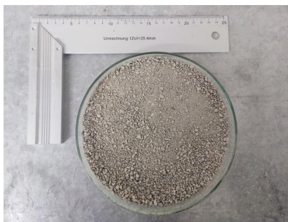
Obr. 23 – Betonový recyklát, tvorba vlastní
