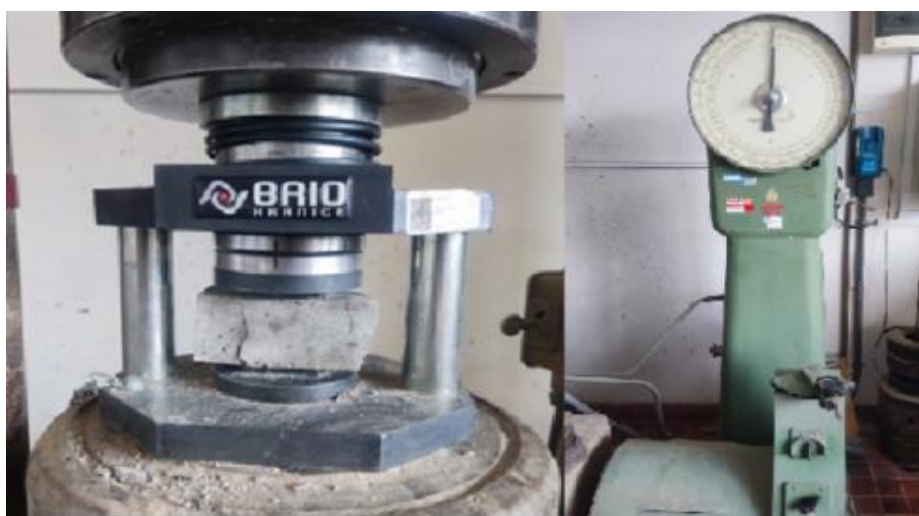
Obr. 21 – Zkušební lis s vloženým vzorkem, tvorba vlastní
