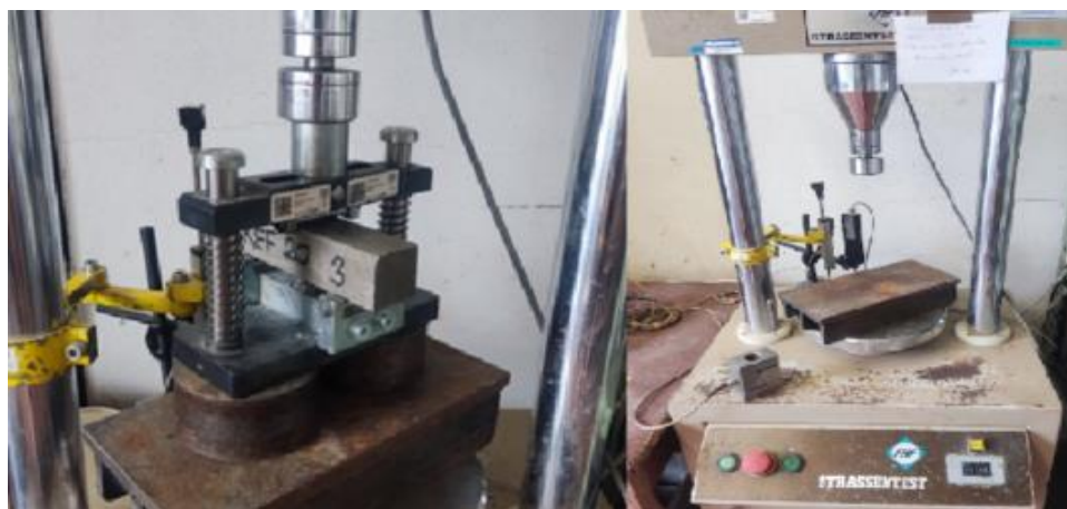
Obr. 20 – Zkušební zařízení k měření pevnosti v tahu za ohybu, tvorba vlastní
