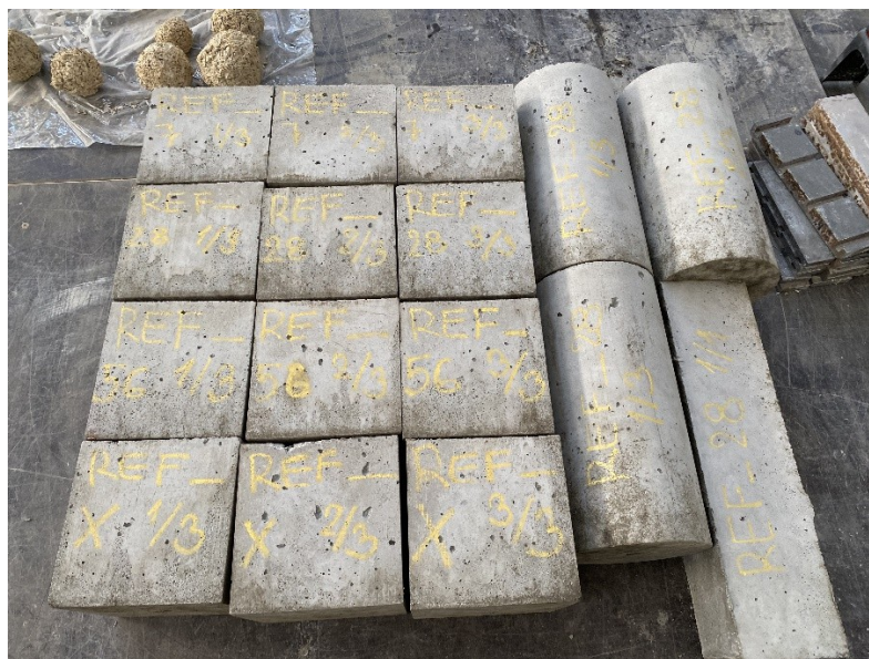
Obrázek 42 – zkušební tělesa jedné směsi krátce po odbednění, vlastní tvorba
