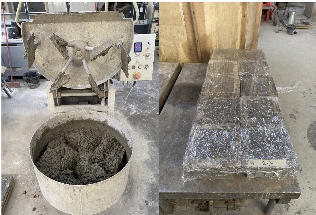
Obrázek 41 – výroba betonové směsi v míchačce a uložení naplněných plastových forem, vlastní tvorba
