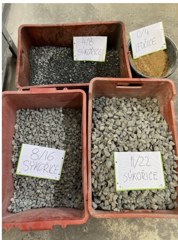
Obrázek 39 – ukázka použitého přírodního drobného a hrubého kameniva, vlastní tvorba
