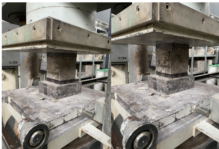
Obrázek 31 – zkušební těleso v okamžiku zatěžování a porušení, vlastní tvorba
