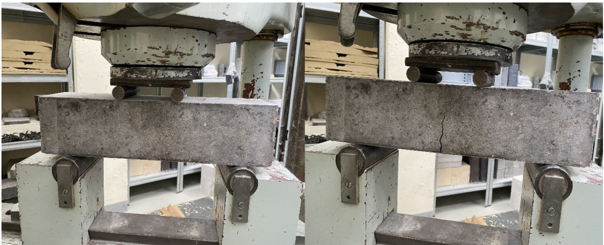
Obrázek 33 – stav tělesa před a po zkoušce pevnosti v tahu ohybem se čtyřbodovým uspořádáním, vlastní tvorba
