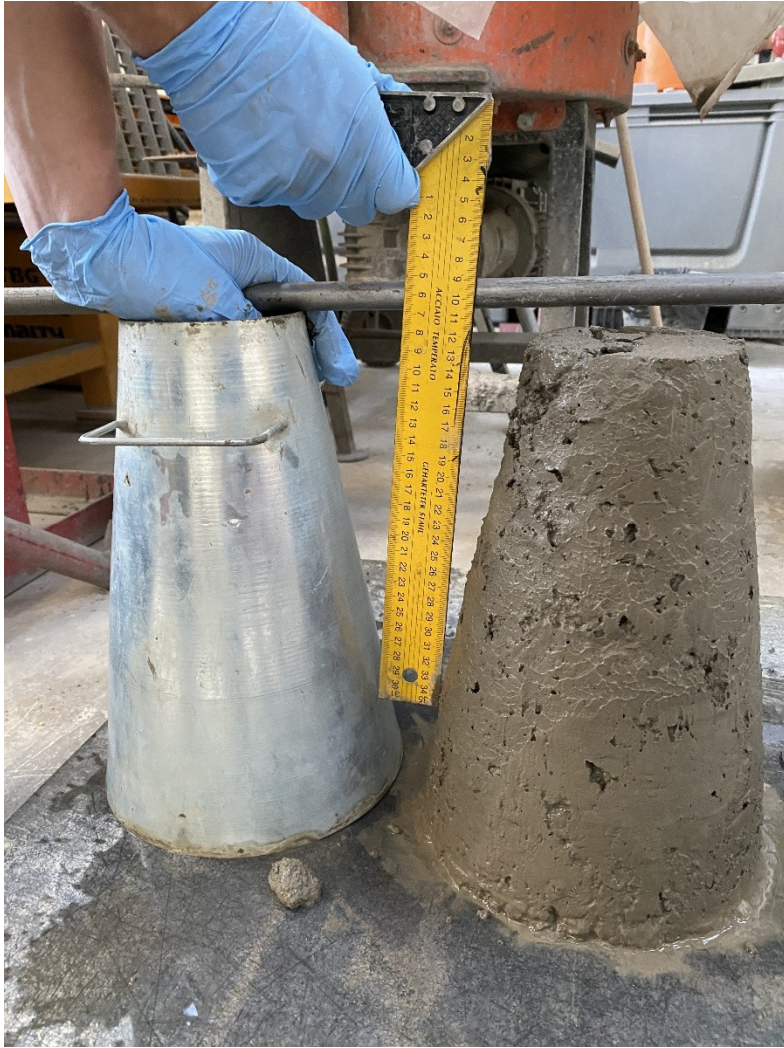
Obrázek 26 – měření poklesu (sednutí) čerstvé betonové směsi, vlastní tvorba
