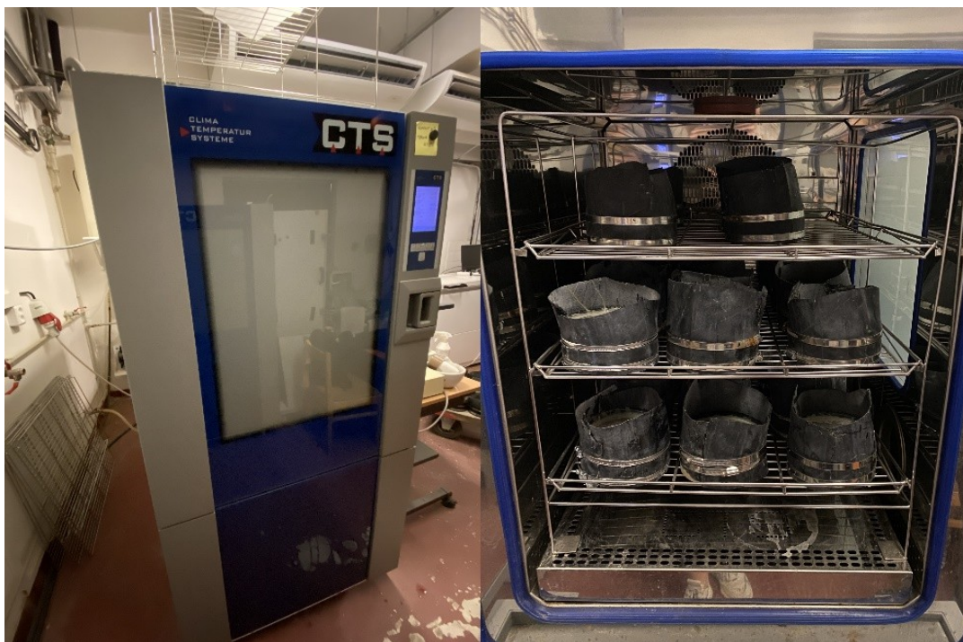
Obrázek 35 – klimatizační komora CTS C-40/350/S a uložení vzorků, vlastní tvorba
