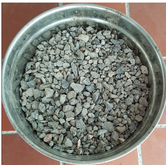
Obrázek 40 – ocelářská struska frakce 8/16 mm, vlastní tvorba
