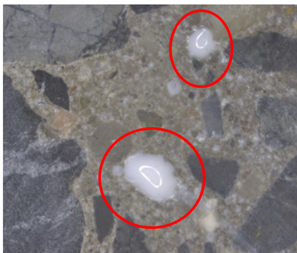
Obrázek 29 – příklad snímku z optického stereo mikroskopu včetně vyznačených pórů, vlastní tvorba
