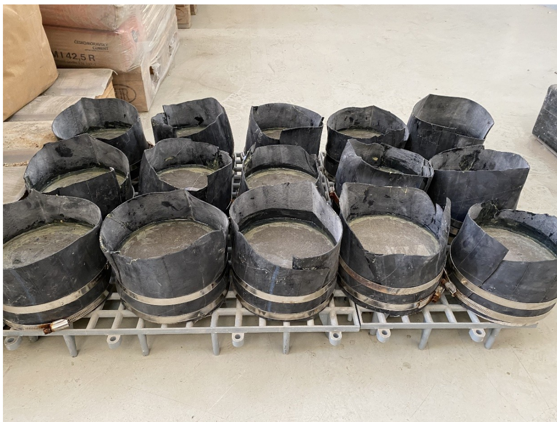
Obrázek 27 – zkouška povrchové nasákavosti, vlastní tvorba
