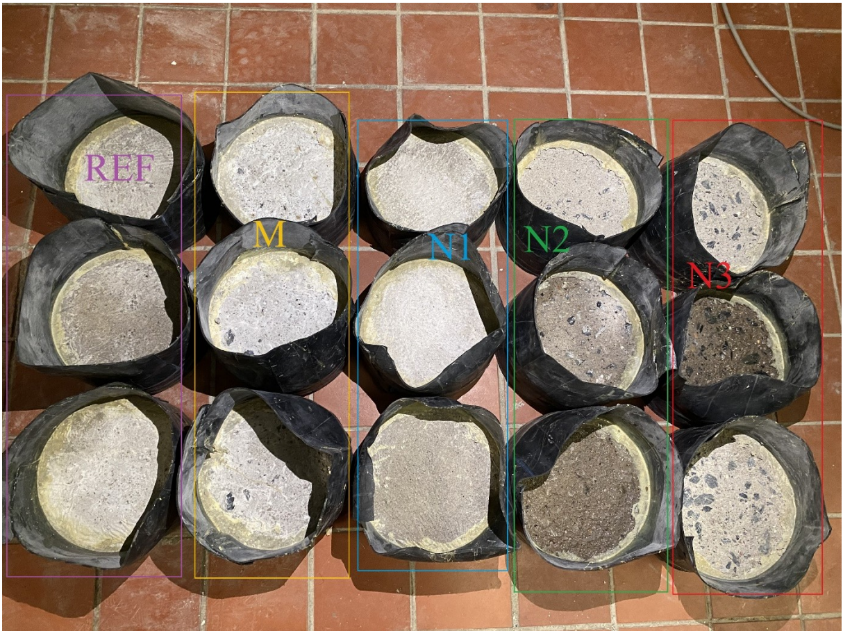
Obrázek 37 – stav zkušebních těles po ukončení zkoušky odolnosti, vlastní tvorba
