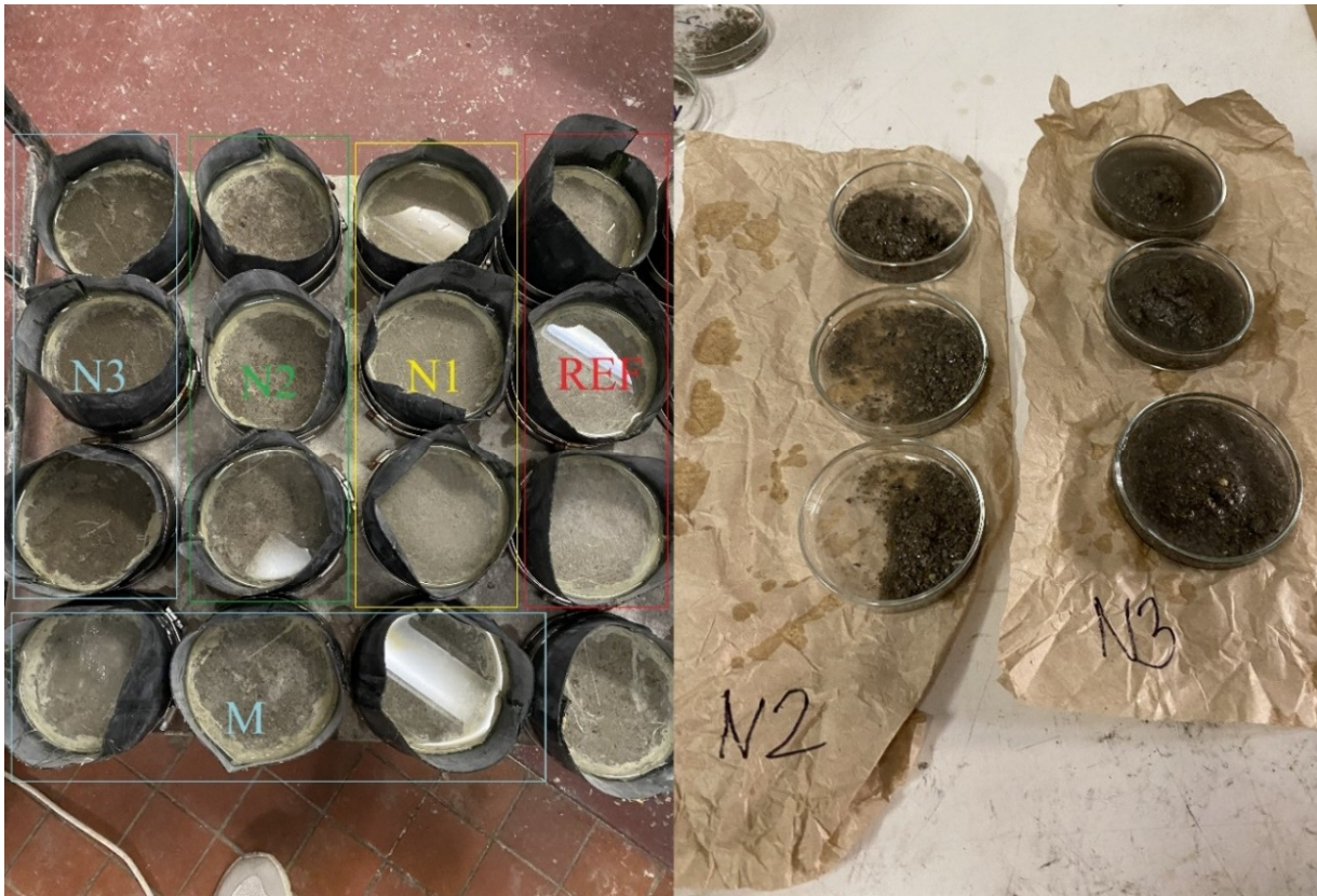
Obrázek 36 – zkušební tělesa po vyndání z klimatizační komory po 25 cyklech a po sliti do Petriho misek, vlastní tvorba
