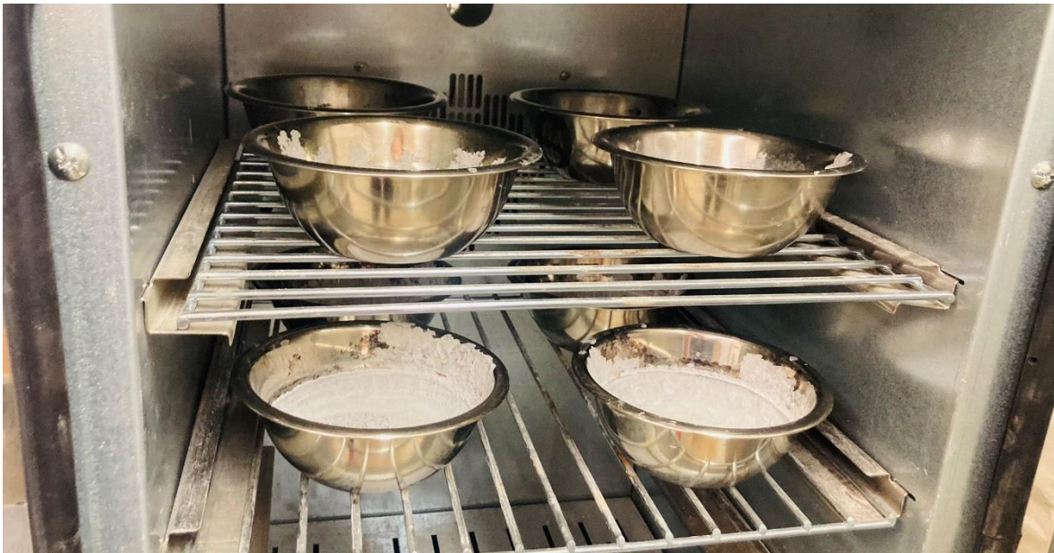
Obr. 47 - Nerezové misky s odpadem umístěné ve vysoušecí peci
