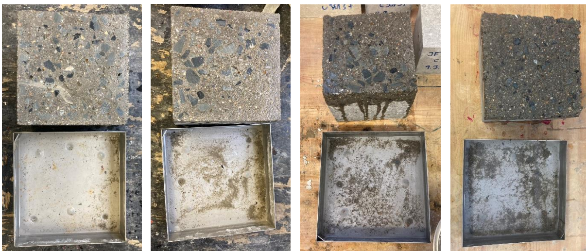
Obr. 51 - Beton pevnostní třídy C 45/55, vzorky ošetřené impregnací z lithného vodního skla
