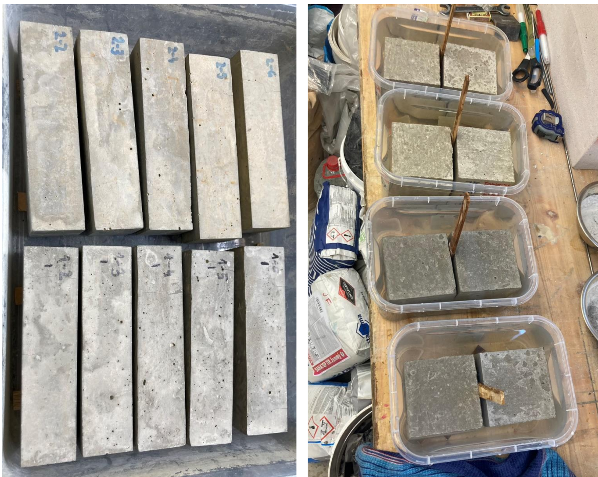
Obr. 38 - Měření nasákavosti ošetřených a referenčních zkušebních vzorků
