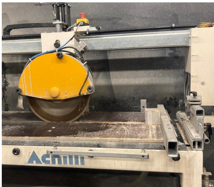
Obr. 56 - Zleva rozlomení vzorku v příčném tahu, rozříznutí vzorku kotoučovou pilou
