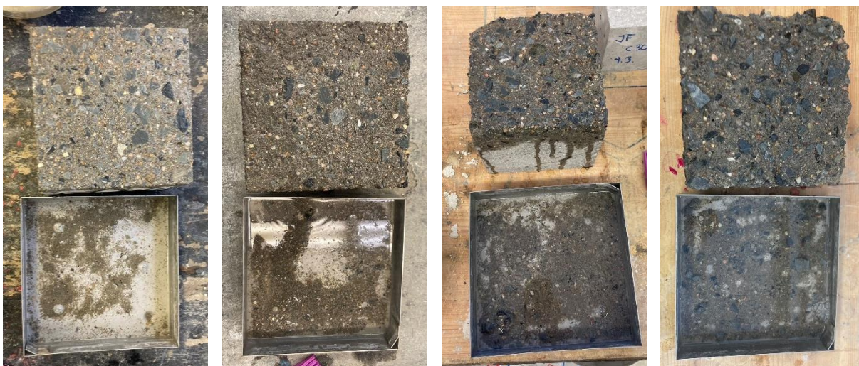
Obr. 50 - Beton pevnostní třídy C 30/37, referenční zkušební vzorky
