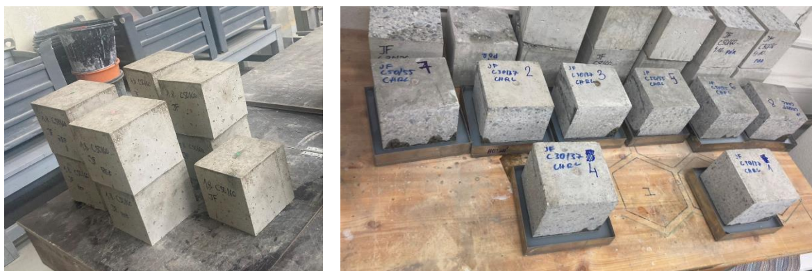
Obr. 45 - Výroba zkušebních vzorků a impregnace roztokem lithného vodního skla
