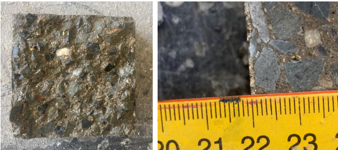
Obr. 36 - Hloubka penetrace přípravků. Zleva roztok lithného vodního skla, přípravek Repesil BKH.
