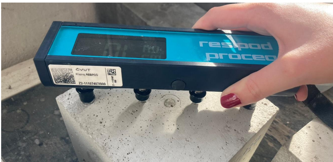
Obr. 44 - Měření elektrického odporu u zkušebních vzorků ošetřených přípravkem Repesil BKH
