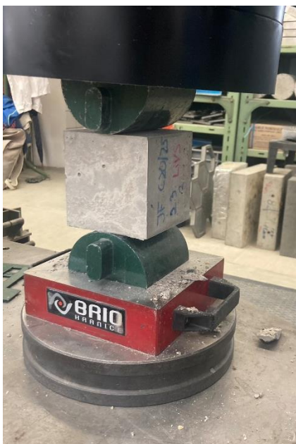
Obr. 56 - Zleva rozlomení vzorku v příčném tahu, rozříznutí vzorku kotoučovou pilou
