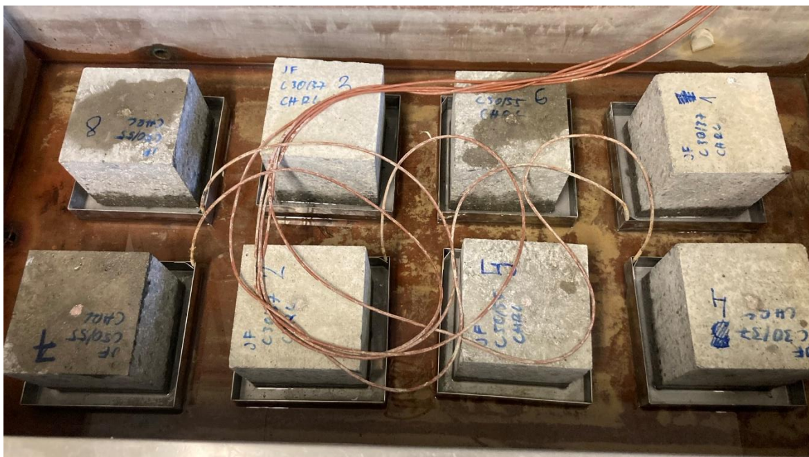
Obr. 46 - Zkušební vzorky umístěné v mrazicím boxu
