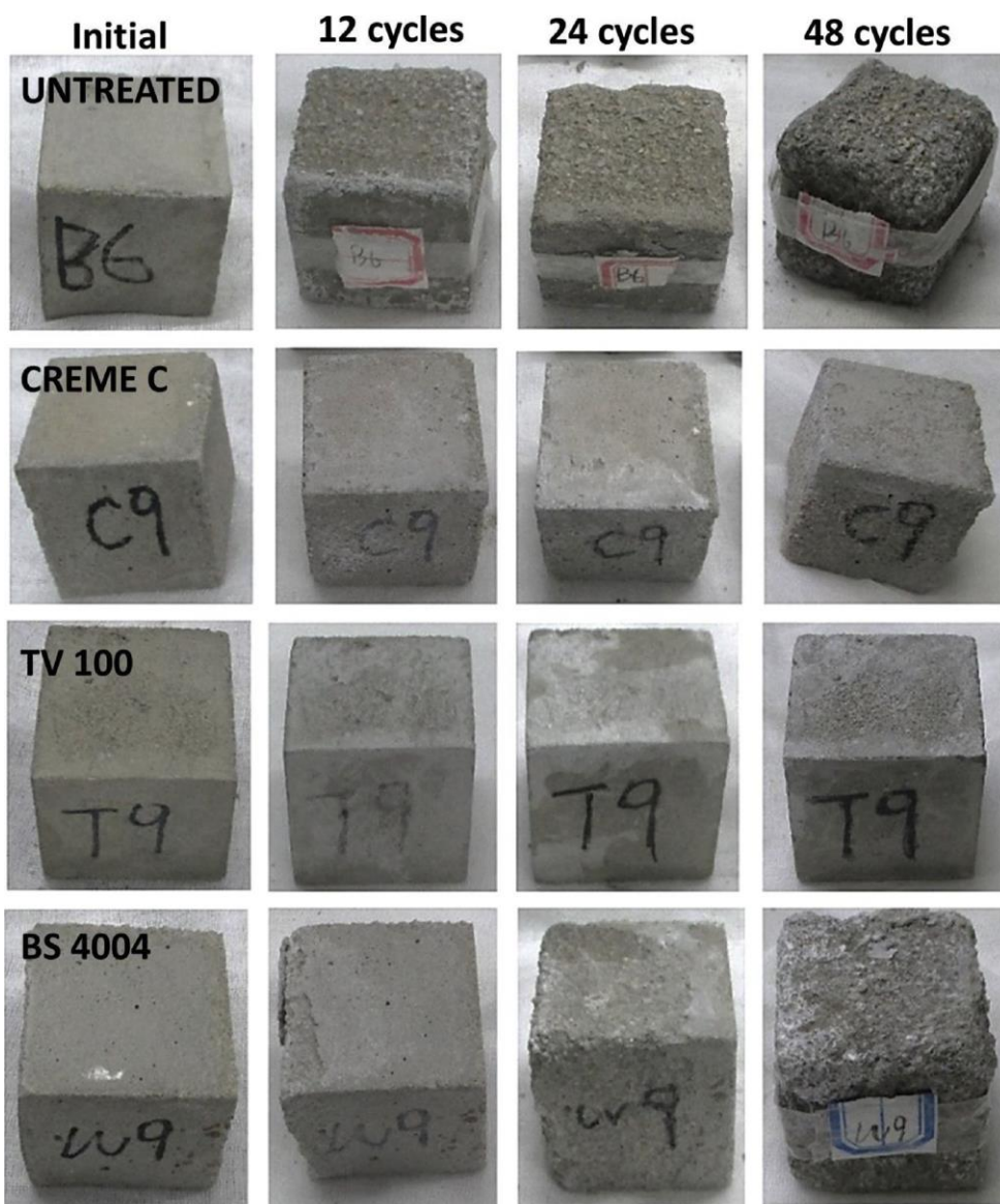
Obr. 18 - Poškození povrchu vzorků v průběhu cyklů mrazu a rozmrazování [5]
