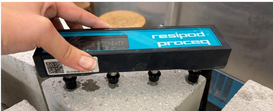
Obr. 42 - Měření pomocí přístroje Resipod
