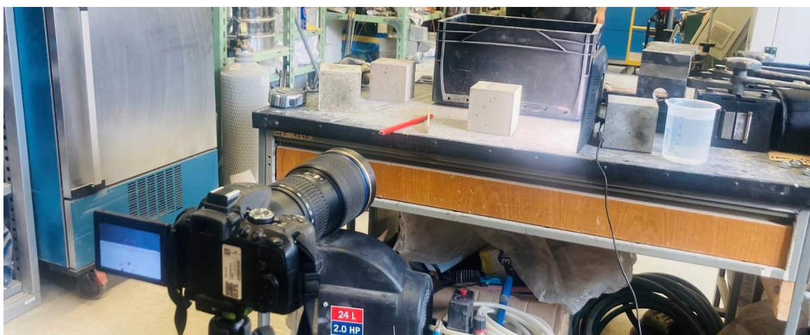
Obr. 34 - Měření velikosti smáčecího úhlu
