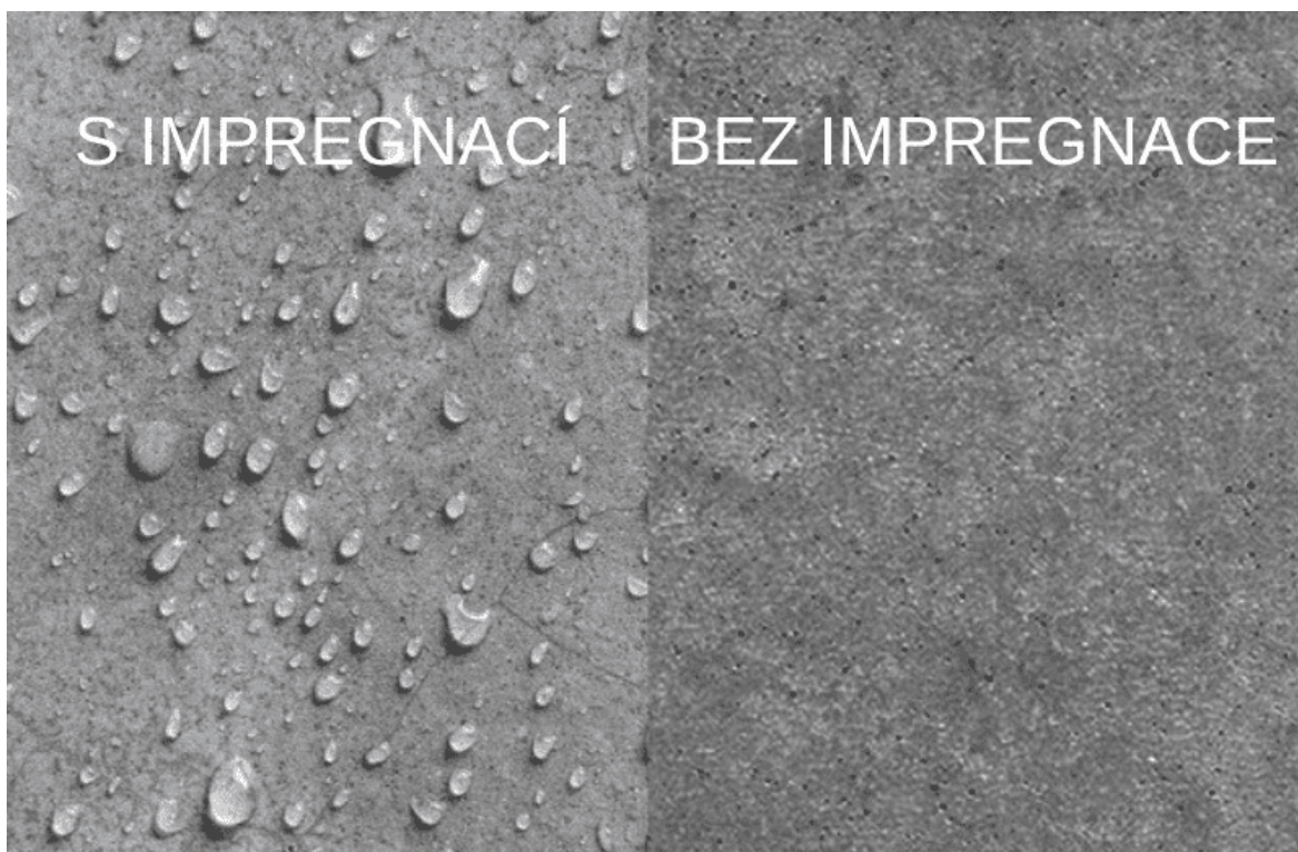
Obr. 13 - Rozdíl mezi povrchem ošetřeným impregnačním prostředkem a neošetřeným povrchem
