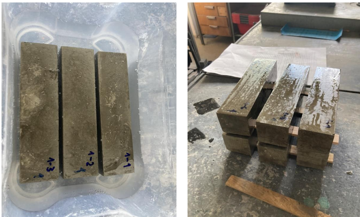
Obr. 33 - Ošetření povrchu zkušebních vzorků impregnačním roztokem z lithného vodního skla
