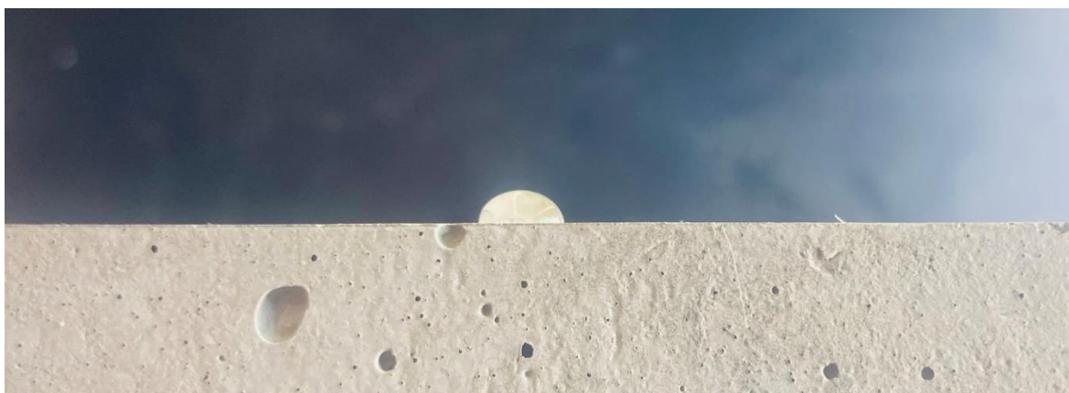
Obr. 32 - Kapka na betonovém povrchu ošetřeném přípravkem Repesil BKH
