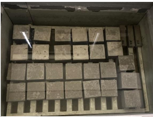
Obr. 28 - Vzorky umístěné ve vodní nádrži
