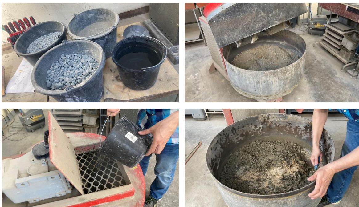
Obr. 26 - Výroba betonové směsi v míchačce
