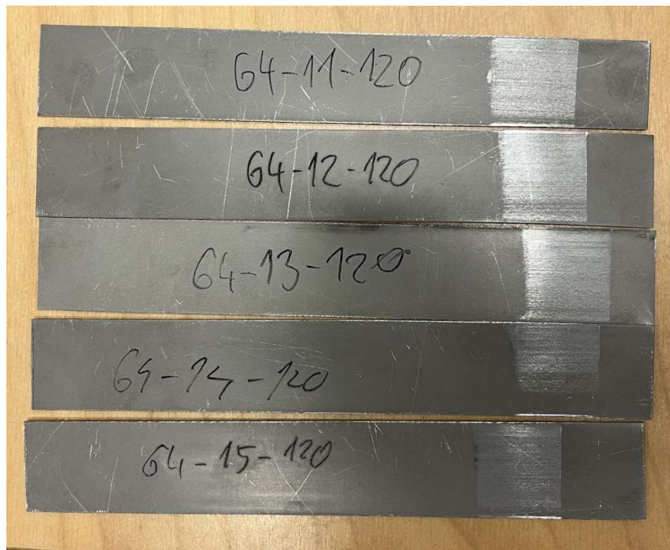
Obr. 8 – Vzorky tažené při 600 mm/min a 120 °C [Foto autor]
