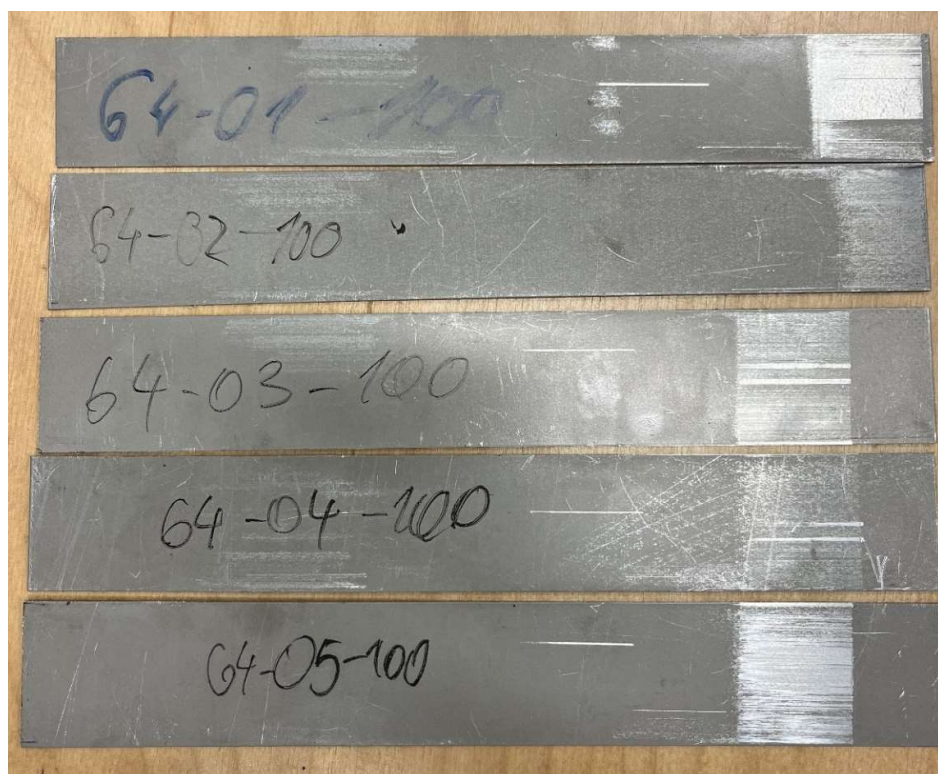
Obr. 5 – Vzorky tažené při 20 mm/min a 100 °C [Foto autor]
