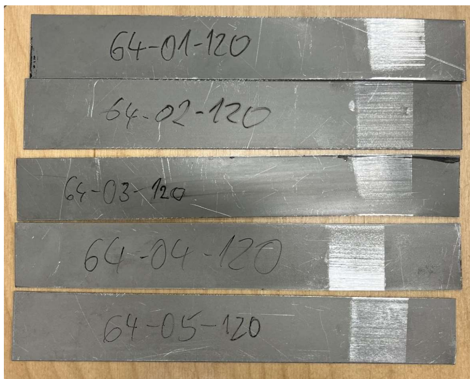
Obr. 7 – Vzorky tažené při 20 mm/min a 120 °C [Foto autor]
