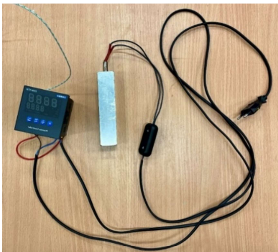
Obr. 20 – Experimentální zařízení pro ohřev a měření teploty čelistí [Foto autor]
